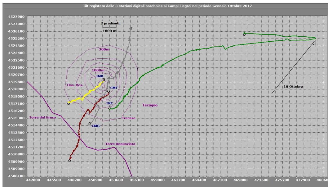
**Figura 2.6** – Odografo del tilting registrato alle stazioni del Vesuvio nel periodo gennaio-ottobre 2017. Per chiarezza di rappresentazione grafica sono state selezionate solo le stazioni borehole con sensori ubicati tra 20 e 25 m di profondità.
