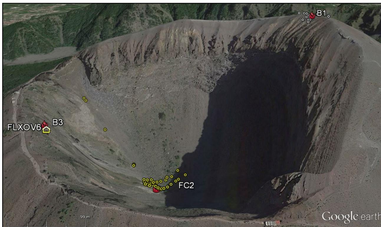
**Figura 4.1** - Ubicazione della stazione multiparametrica FLXOV6 e dei siti oggetto delle attività di sorveglianza geochimica in area craterica. In particolare, sono riportate le principali fumarole di bordo cratere (B1-B3) e di fondo cratere (FC2), sono inoltre riportati i punti fissi per la misura del flusso di CO<sub>2</sub> dal suolo e della temperatura del suolo, in area bordo cratere (simboli bianchi) e in area di fondo cratere (simboli gialli).
