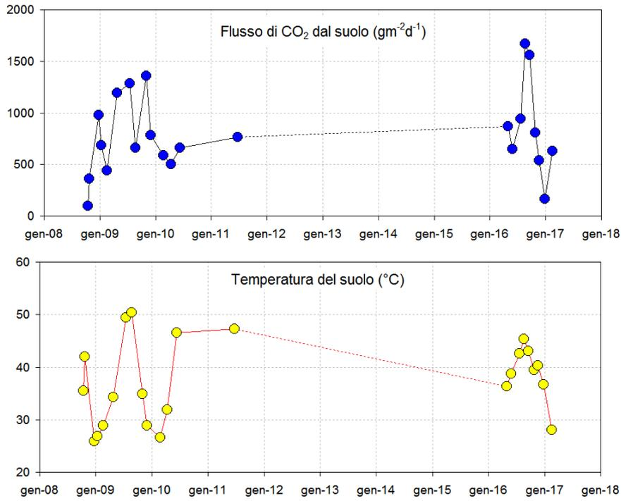
**Figura 4.5** - Media del flusso di CO<sub>2</sub> e delle temperature misurate su una maglia di 40 punti fissi in area di fondo cratere.
