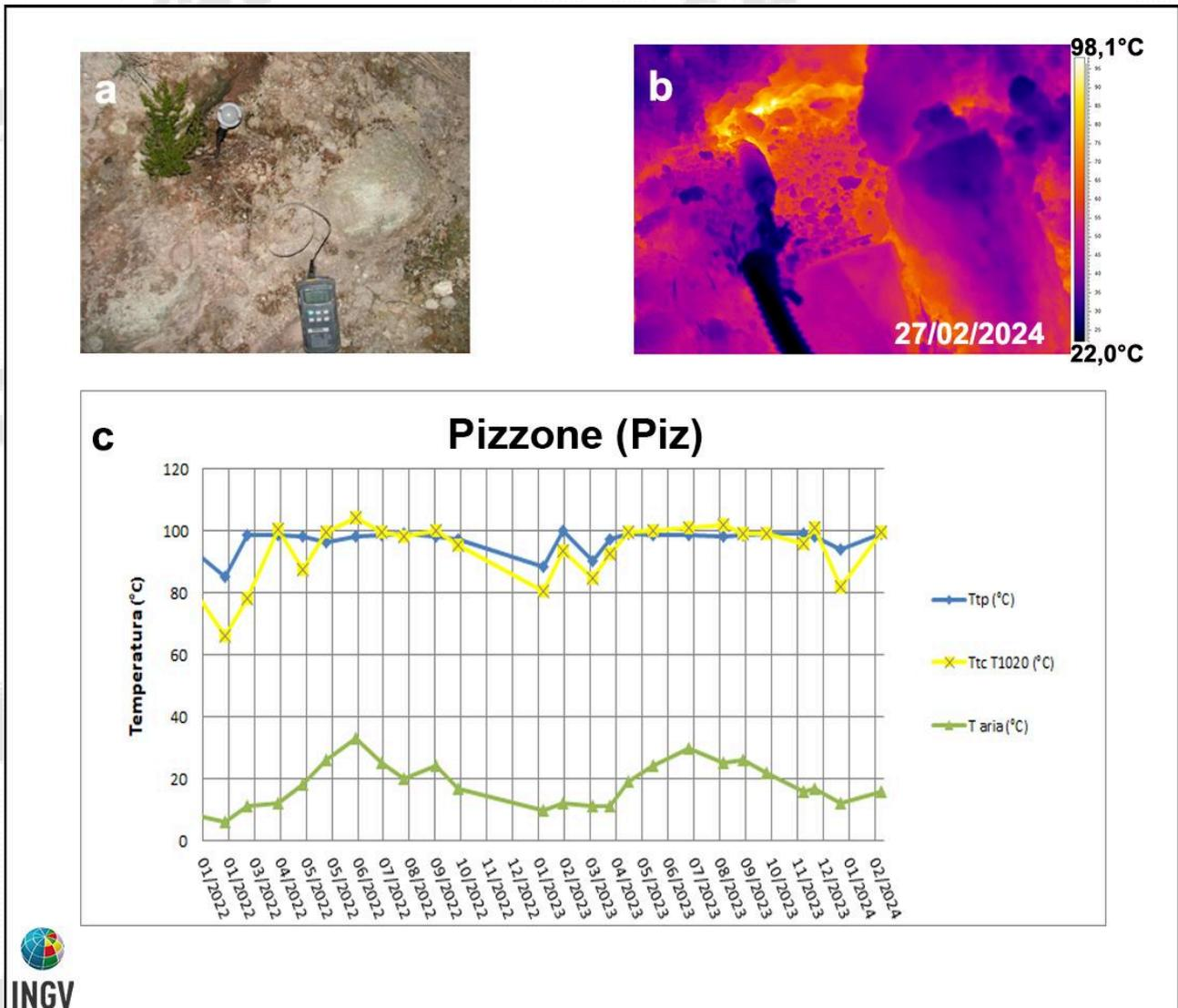
**Figura 3.5** – Fumarola in località Pizzone a Ischia. Immagini nel visibile (a) e termica (b) riprese dal punto stazione Piz di figura 3.1 h. Valori massimi di temperatura rilevati con la termocamera FLIR T1020 (TtcT1020) e con la termocoppia (Ttp), confrontati con la temperatura dell'aria (Taria) misurata nel momento del rilievo termico, da gennaio 2022 a febbraio 2024 (c).
