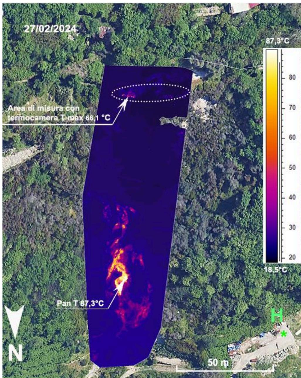
**Figura 3.4** – Fotocomposizione di immagini termiche rilevate da drone nel mese di febbraio 2024. H indica il sito di decollo e di atterraggio del drone. L'area racchiusa dalla linea tratteggiata è quella dove vengono effettuate le misure termiche mensili (Fig. 3.1a).
