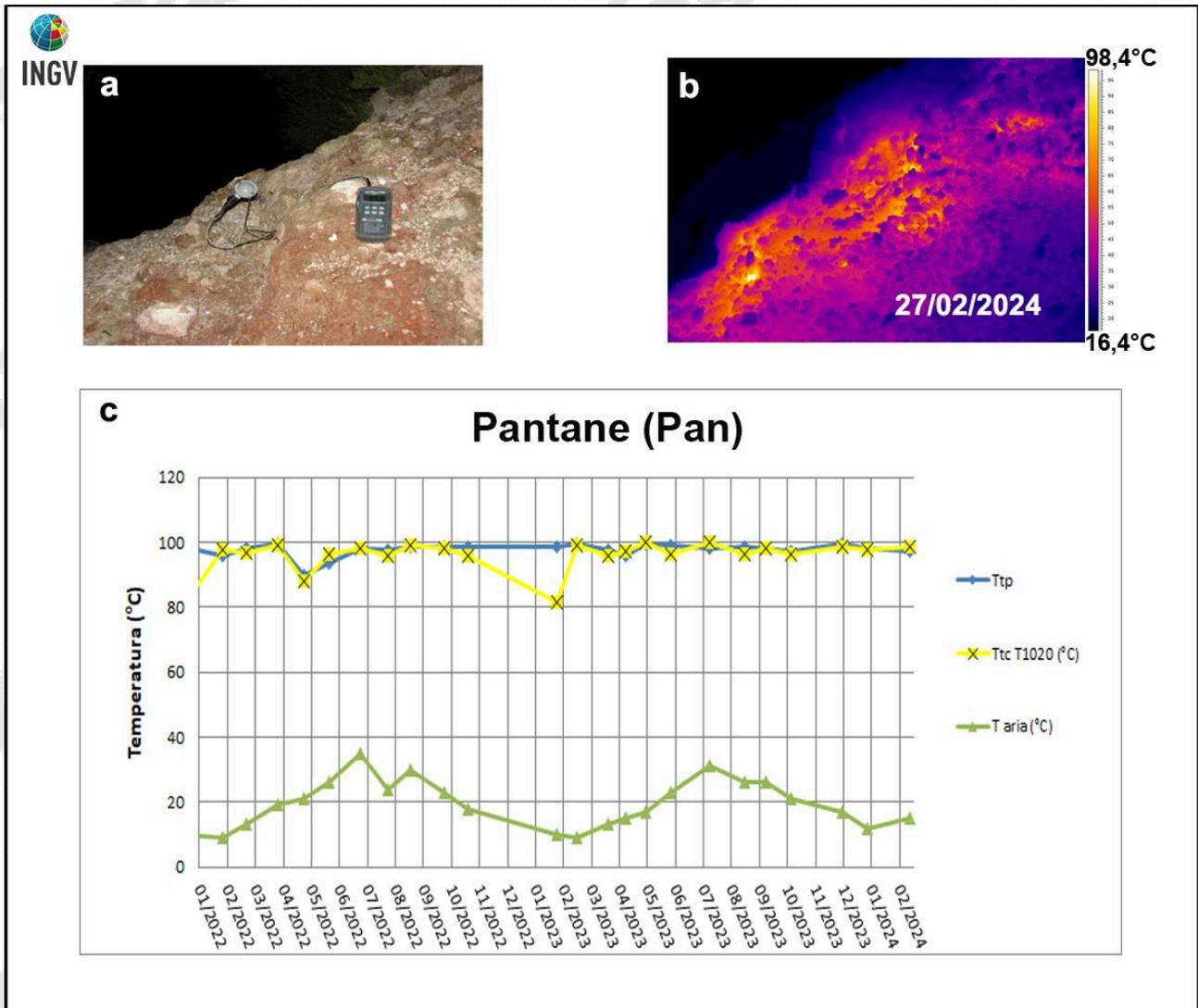
**Figura 3.3** – Fumarola in località Pantane a Ischia. Immagini nel visibile (a) e termica (b) riprese dal punto di misura Pan di figura 3.1 a. Valori massimi di temperatura rilevati con la termocamera FLIR T1020 (TtcT1020) e con la termocoppia (Ttp), confrontati con la temperatura dell'aria (Taria) misurata nel momento del rilievo termico, da gennaio 2022 a febbraio 2024 (c).
