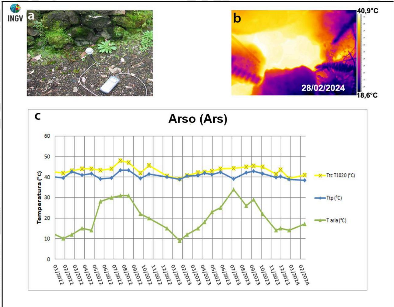
**Figura 3.2** - Cratere dell'Arso a Ischia. Immagini nel visibile (a) e termica (b) riprese dal punto stazione Ars di figura 3.1d. Valori massimi di temperatura rilevati con la termocamera FLIR T1020 (TtcT1020) e con la termocoppia (Ttp), confrontati con la temperatura dell'aria (Taria) misurata nel momento del rilievo termico, da gennaio 2022 a febbraio 2024 (c).
