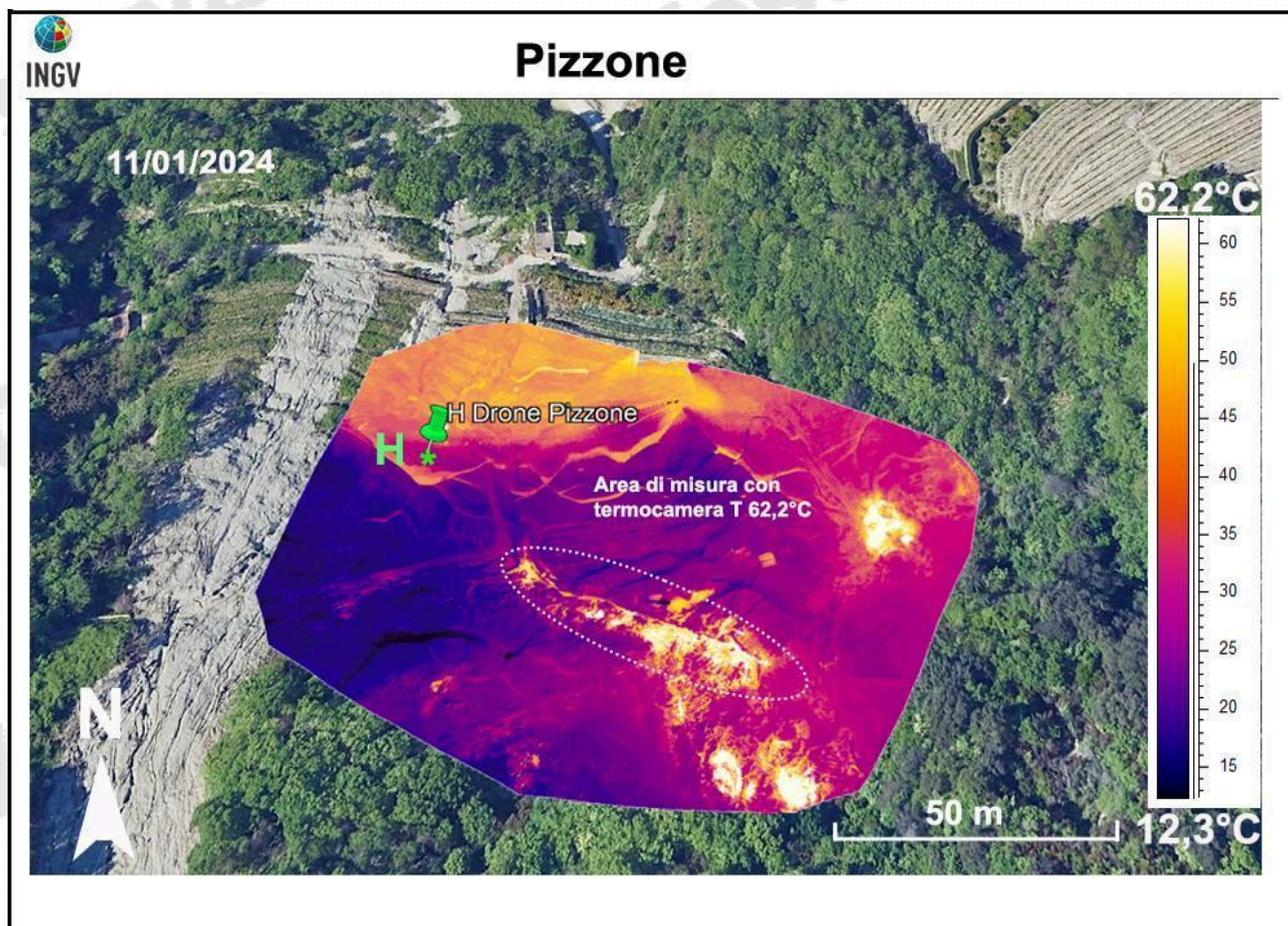
**Figura 3.6** – Fotocomposizione di immagini termiche rilevate da drone nel mese di febbraio 2024. H indica il sito di decollo e di atterraggio del drone. L'area racchiusa dalla linea tratteggiata è quella dove vengono effettuate le misure termiche mensili (Fig. 3.1h).
