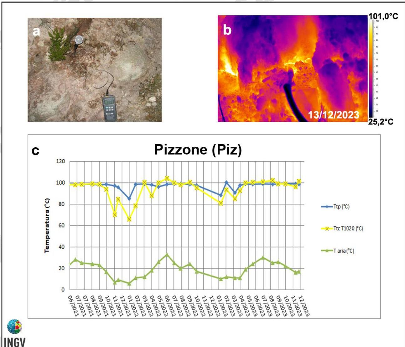
**Figura 3.5** – Fumarola in località Pizzone a Ischia. Immagini nel visibile (a) e termica (b) riprese dal punto stazione Piz di figura 3.1 h. Valori massimi di temperatura rilevati con la termocamera FLIR T1020 (TtcT1020) e con la termocoppia (Ttp), confrontati con la temperatura dell'aria (Taria) misurata nel momento del rilievo termico, da giugno 2021 a dicembre 2023 (c).
