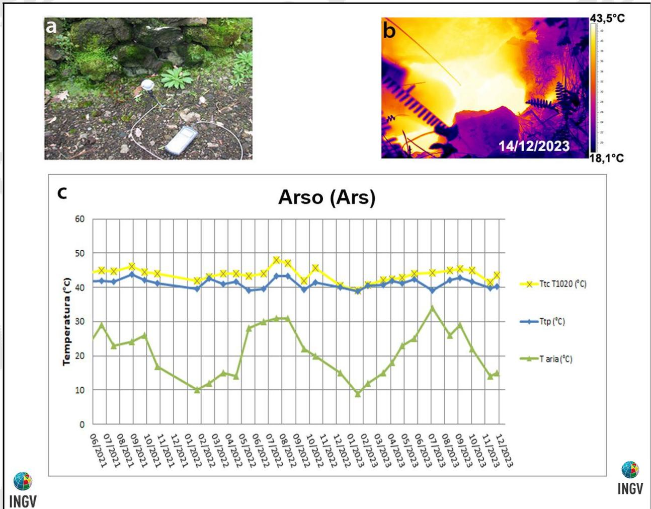
**Figura 3.2** - Cratere dell'Arso a Ischia. Immagini nel visibile (a) e termica (b) riprese dal punto stazione Ars di figura 3.1d. Valori massimi di temperatura rilevati con la termocamera FLIR T1020 (TtcT1020) e con la termocoppia (Ttp), confrontati con la temperatura dell'aria (Taria) misurata nel momento del rilievo termico, da giugno 2021 a dicembre 2023 (c).
