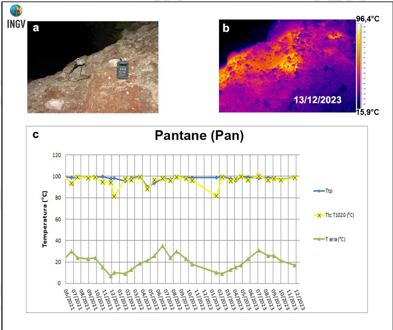
**Figura 3.3** – Fumarola in località Pantane a Ischia. Immagini nel visibile (a) e termica (b) riprese dal punto di misura Pan di figura 3.1 a. Valori massimi di temperatura rilevati con la termocamera FLIR T1020 (TtcT1020) e con la termocoppia (Ttp), confrontati con la temperatura dell'aria (Taria) misurata nel momento del rilievo termico, da giugno 2021 a dicembre 2023 (c).
