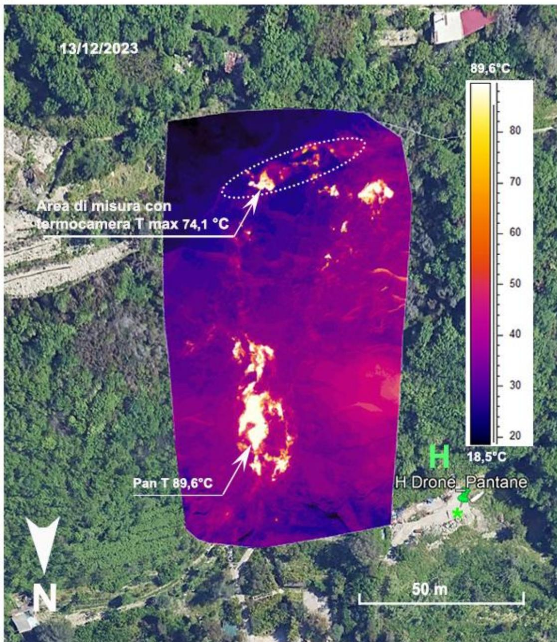
**Figura 3.4** – Fotocomposizione di immagini termiche rilevate da drone nel mese di dicembre 2023. H indica il sito di decollo e di atterraggio del drone. L'area racchiusa dalla linea tratteggiata è quella dove vengono effettuate le misure termiche mensili (Fig. 3.1a). Le frecce indicano il sito "Pan" di figura 1.3. e le temperature massime rilevate dal drone.
