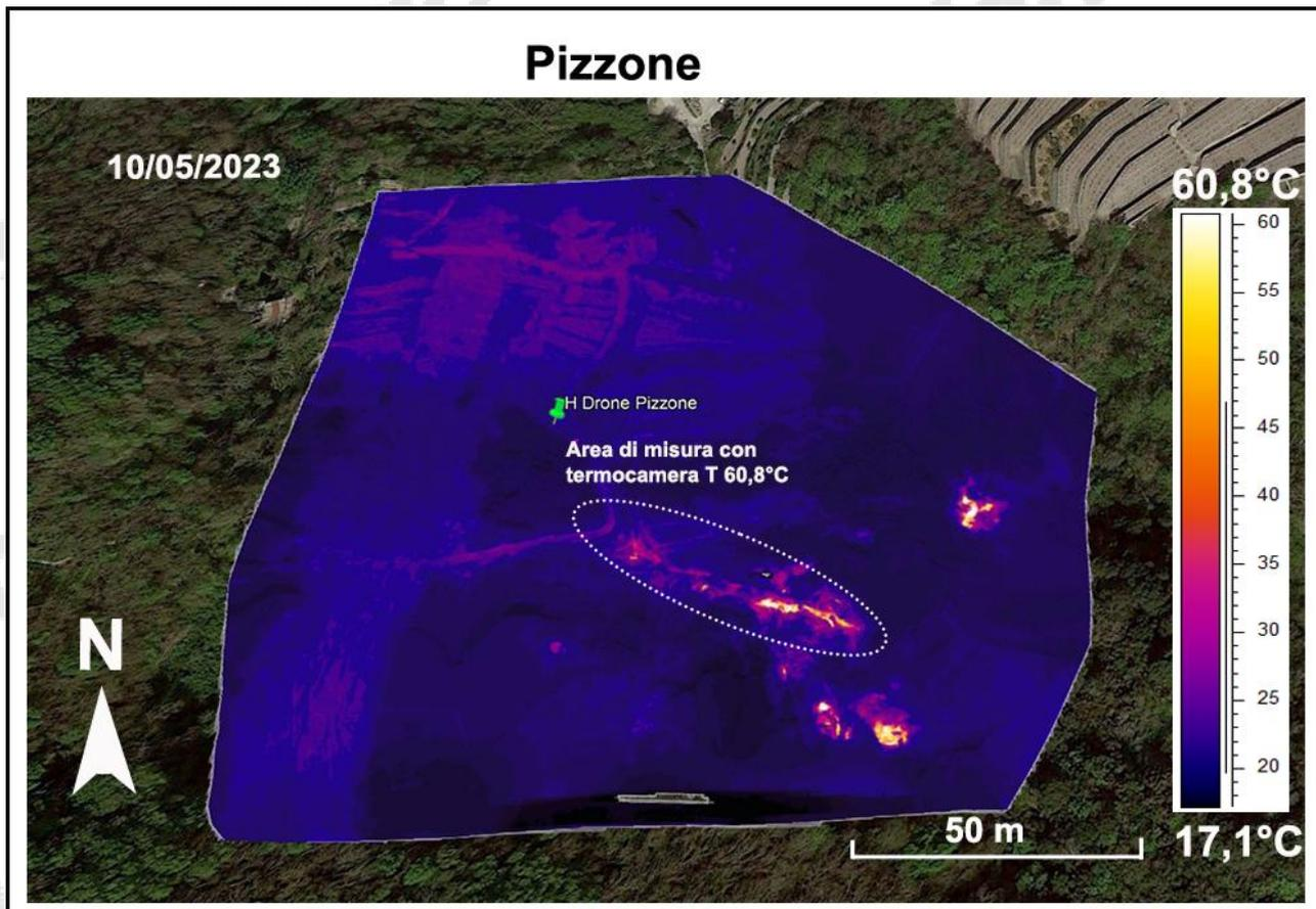
**Figura 3.5** – Fotocomposizione di immagini termiche rilevate da drone nel mese di maggio 2023. H-drone indica il sito di decollo e di atterraggio del drone. L'area racchiusa dalla linea tratteggiata è quella dove vengono effettuate le misure termiche mensili (Fig. 3.1.h). La freccia indica il sito "Piz" di figura 3.4. e la relativa temperatura rilevata dal drone.
