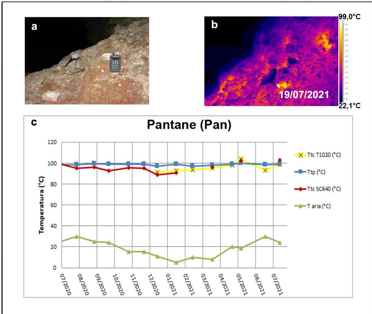
**Figura 3.3** – Fumarola in località Pantane a Ischia. Immagini nel visibile (a) e termica (b) riprese dal punto di misura Pan di figura 3.1a. Valori massimi di temperatura con termocamera FLIR SC640 (TtcSC640), valori massimi di temperatura con termocamera FLIR T1020 (TtcT1020) e valori di temperatura dalla termocoppia (Ttp), confrontati con la temperatura dell’aria (Taria) misurata nel momento del rilievo termico, da luglio 2020 a luglio 2021 (c).
