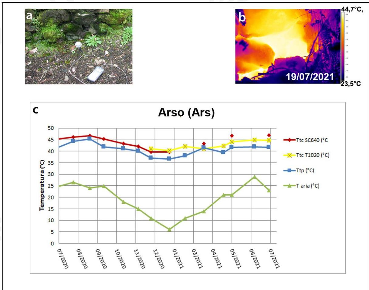
**Figura 3.2** - Cratere dell'Arso a Ischia. Immagini nel visibile (a) e termica (b) riprese dal punto stazione Ars di figura 3.1d. Valori massimi di temperatura con termocamera FLIR SC640 (TtcSC640), valori massimi di temperatura con termocamera FLIR T1020 (TtcT1020) e valori di temperatura dalla termocoppia (Ttp), confrontati con la temperatura dell'aria (Taria) misurata nel momento del rilievo termico, da luglio 2020 a luglio 2021 (c).
