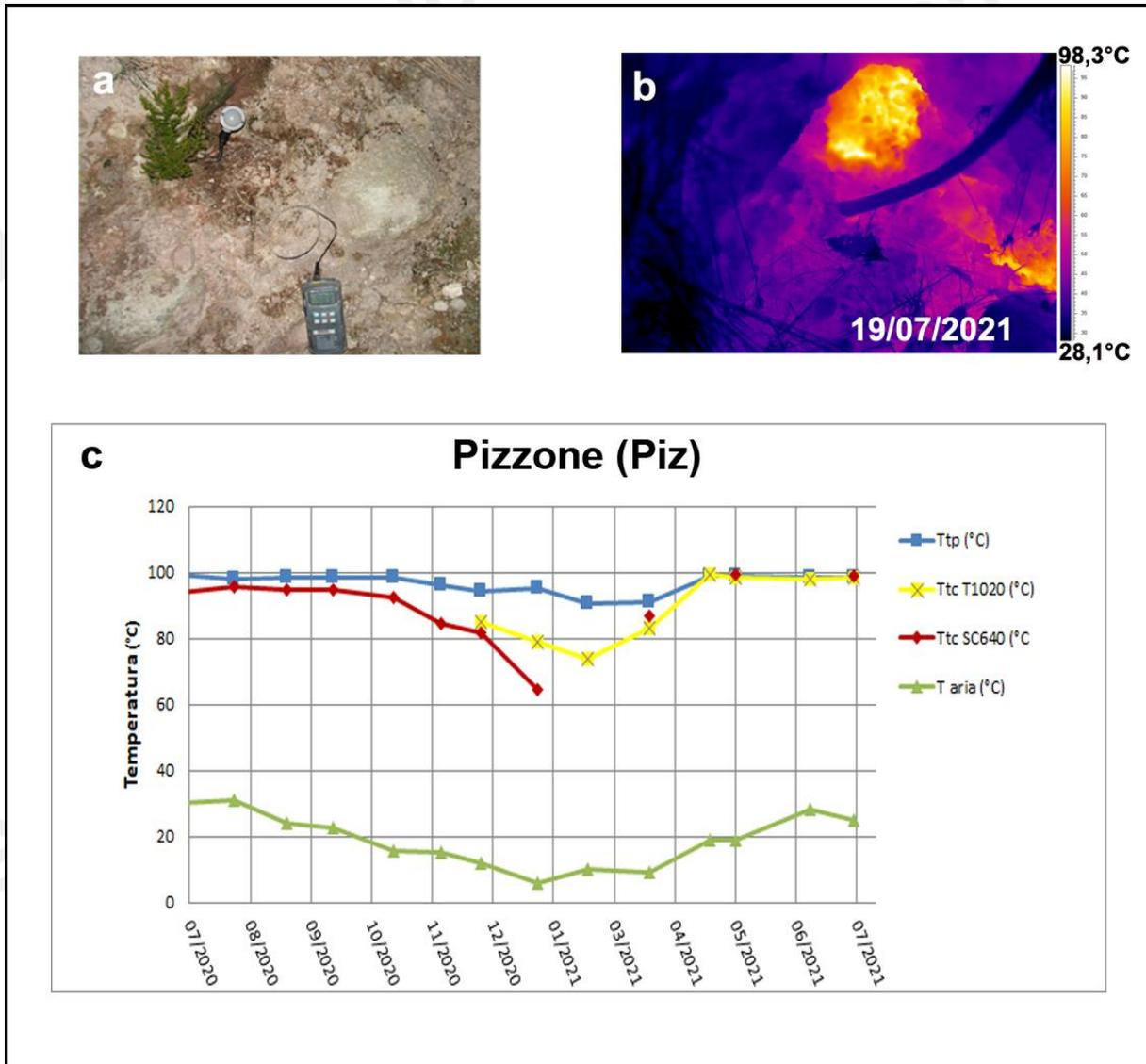
**Figura 3.4** – Fumarola in località Pizzone a Ischia. Immagini nel visibile (a) e termica (b) riprese dal punto stazione Piz di figura 3.1h. Valori massimi di temperatura con termocamera FLIR SC640 (TtcSC640), valori massimi di temperatura con termocamera FLIR T1020 (TtcT1020) e valori di temperatura dalla termocoppia (Ttp), confrontati con la temperatura dell'aria (Taria) misurata nel momento del rilievo termico, da luglio 2020 a luglio 2021 (c).
