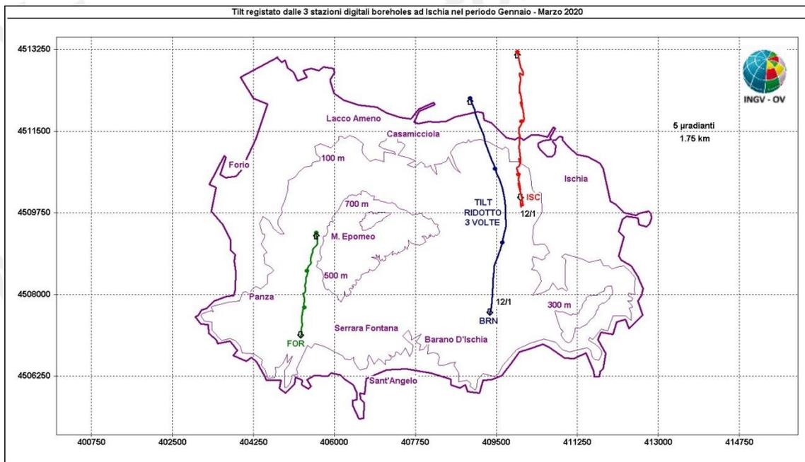
**Figura 2.2.2** – Pattern tiltmetrico osservato a Ischia. Il lato di ogni maglia del reticolo equivale a 5 gradianti o 1.75 km ed i pallini in colore sovrapposti sui vettori tilt indicano intervalli di 30 giorni. Allo scopo di facilitare il confronto tra le varie stazioni, all'odografo relativo alla stazione BRN è stata applicata una scala di riduzione di 1:3.
