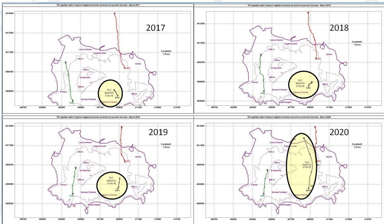
**Figura 2.2.4** - Pattern tiltmetrico osservato ad Ischia nei primi 3 mesi del 2017, 2018, 2019 e 2020. Per agevolare il confronto è stata applicata una scala di riduzione di 1:3 all’odografo relativo alla stazione BRN. E’ evidente come nel corso di quest’anno l’ampiezza dell’inclinazione del suolo sia triplicata in corrispondenza del sito-stazione.
