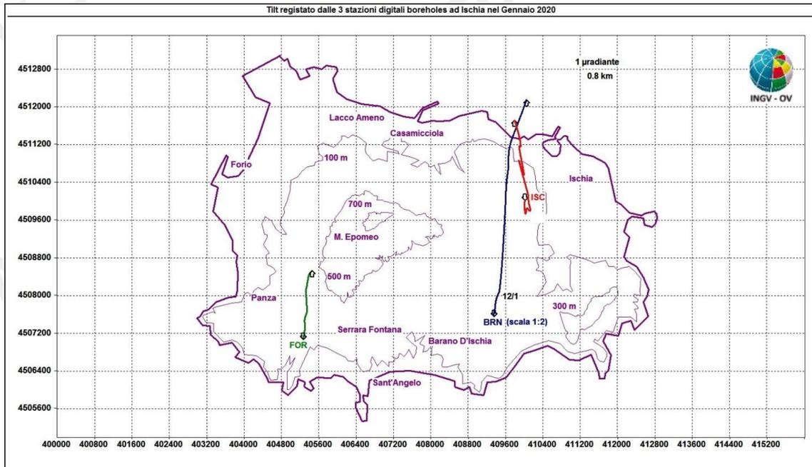
**Figura 2.2.2** – Pattern tiltmetrico osservato a Ischia. Il lato di ogni maglia del reticolo equivale a 1  $\mu$ radiante o 0.8 km. Allo scopo di facilitare il confronto tra le varie stazioni, all'odografo relativo alla stazione BRN è stata applicata una scala di riduzione di 1:2.
