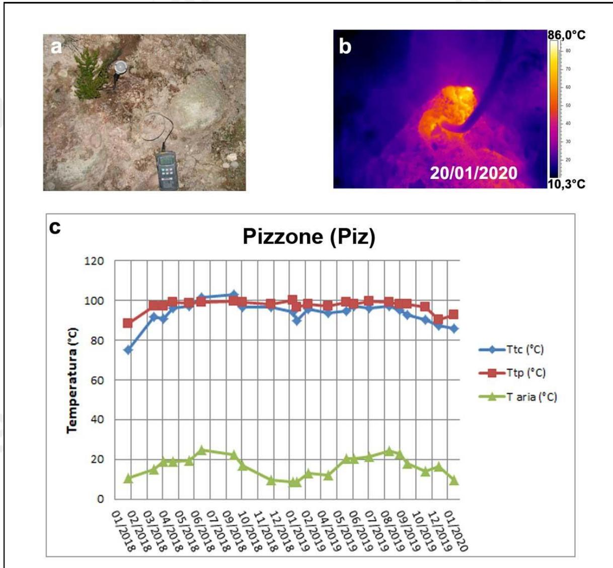
**Figura 3.4** – Fumarola in località Pizzone a Ischia. Immagini nel visibile (a) e termica (b) riprese dal punto stazione Piz di figura 3.1h. Valori massimi di temperatura con termocamera (Ttc) e valori di temperatura dalla termocoppia (Ttp), confrontati con la temperatura dell'aria (c) misurata nel momento del rilievo termico, da gennaio 2018 a gennaio 2020 (c).
