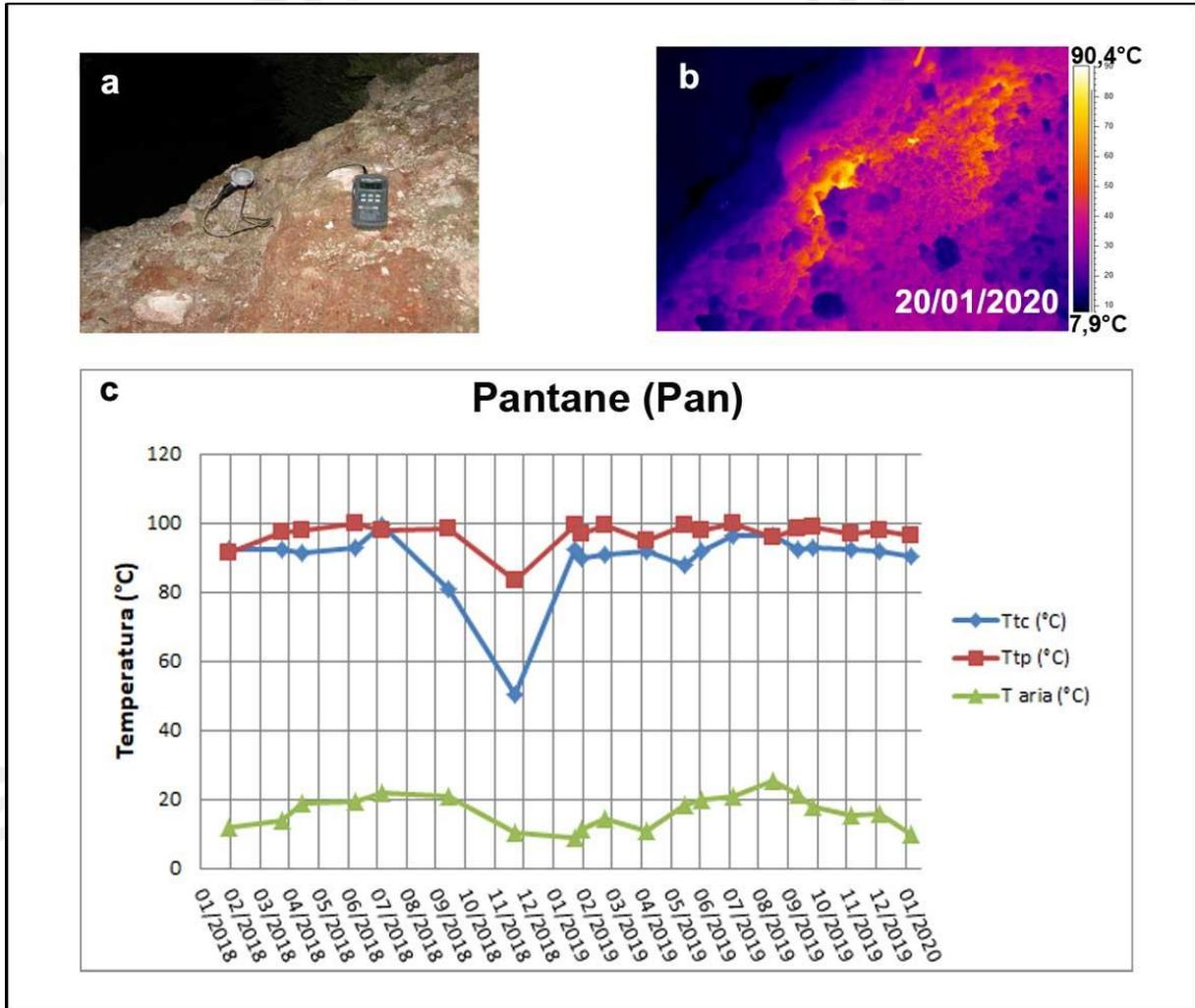
**Figura 3.3** – Fumarola in località Pantane a Ischia. Immagini nel visibile (a) e termica (b) riprese dal punto di misura Pan di figura 3.1a. Valori massimi di temperatura con termocamera (Ttc) e valori di temperatura dalla termocoppia (Ttp), confrontati con la temperatura dell'aria misurata nel momento del rilievo termico, da gennaio 2018 a gennaio 2020 (c).
