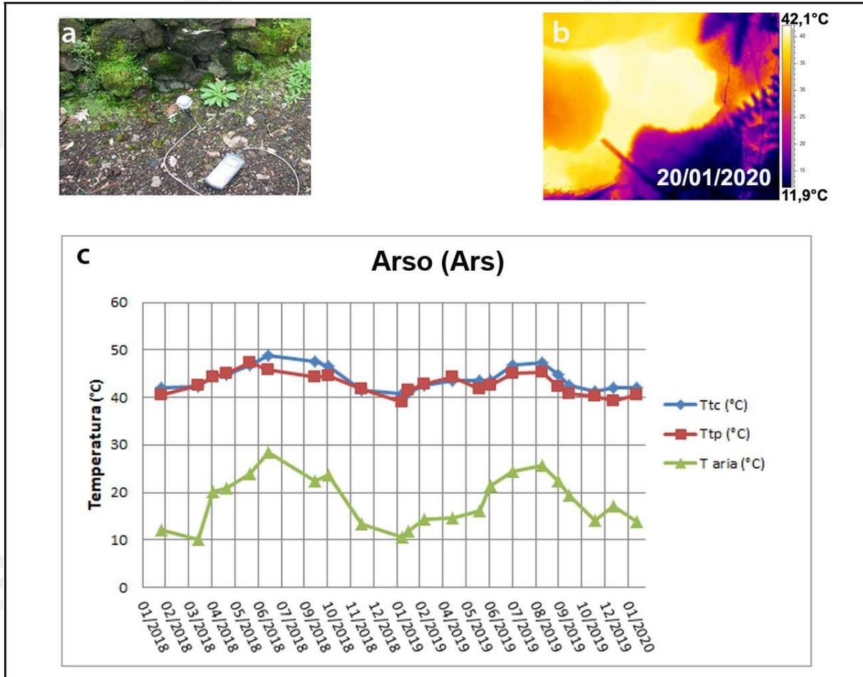
**Figura 3.2** - Cratere dell’Arso a Ischia. Immagini nel visibile (a) e termica (b) riprese dal punto stazione Ars di figura 3.1d. Valori massimi di temperatura con termocamera (Ttc) e valori di temperatura dalla termocoppia (Ttp), confrontati con la temperatura dell’aria misurata nel momento del rilievo termico, da gennaio 2018 a gennaio 2020 (c).
