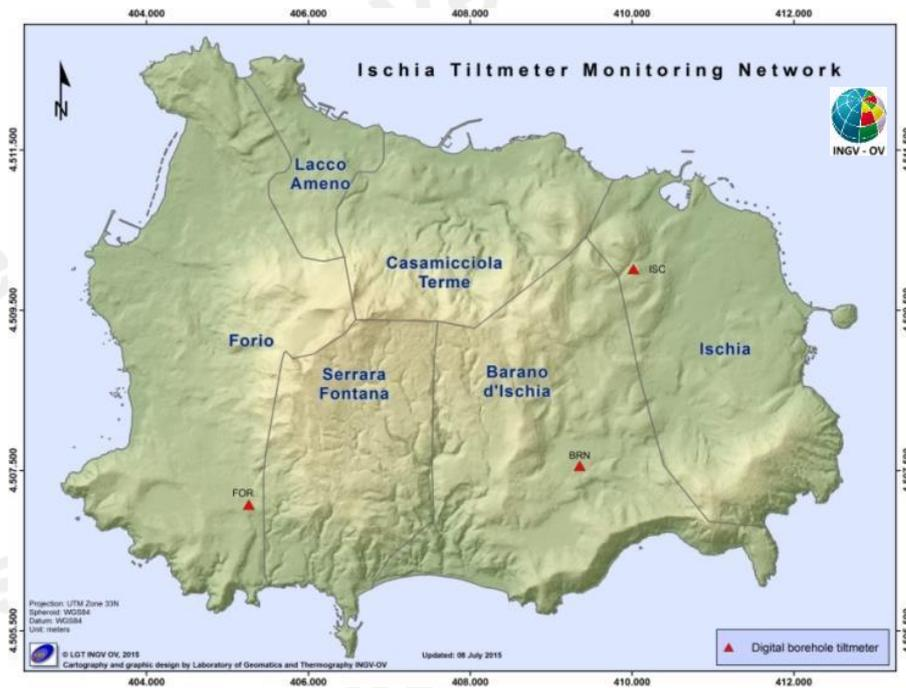
Figura 2.2.1 - Rete Tiltmetrica dell'Isola d'Ischia.
