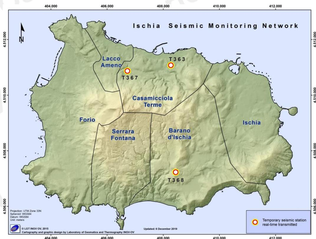
**Figura 4.1** – Mappa della Rete Sismica Mobile operativa ad Ischia nel mese di novembre 2019.
