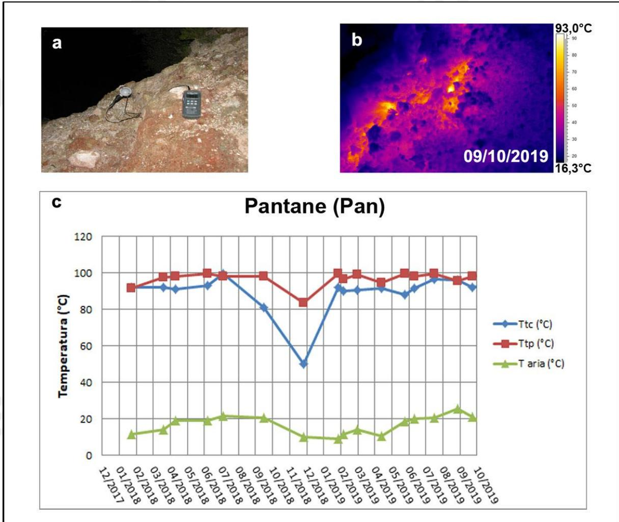
**Figura 3.3** – Fumarola in località Pantane a Ischia. Immagini nel visibile (a) e termica (b) riprese dal punto di misura Pan di figura 3.1a. Valori massimi di temperatura con termocamera (Ttc) e valori di temperatura dalla termocoppia (Ttp), confrontati con la temperatura dell'aria misurata nel momento del rilievo termico, da gennaio 2018 a ottobre 2019 (c).
