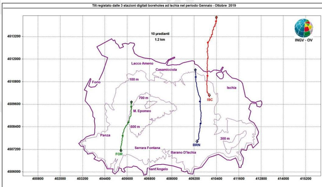
**Figura 2.2.2** – Pattern tiltmetrico osservato a Ischia. Il lato di ogni maglia del reticolo equivale a 10  $\mu$ radianti o 1.2 km mentre i pallini in colore sovrapposti sui vettori tilt indicano intervalli di 90 giorni.
