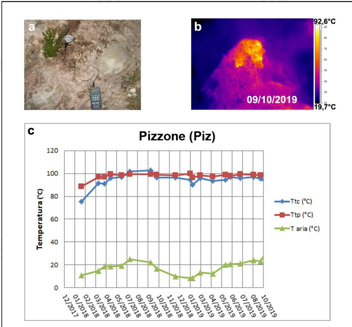
**Figura 3.4** – Fumarola in località Pizzone a Ischia. Immagini nel visibile (a) e termica (b) riprese dal punto stazione Piz di figura 3.1h. Valori massimi di temperatura con termocamera (Ttc) e valori di temperatura dalla termocoppia (Ttp), confrontati con la temperatura dell'aria (c) misurata nel momento del rilievo termico, da gennaio 2018 a ottobre 2019 (c).
