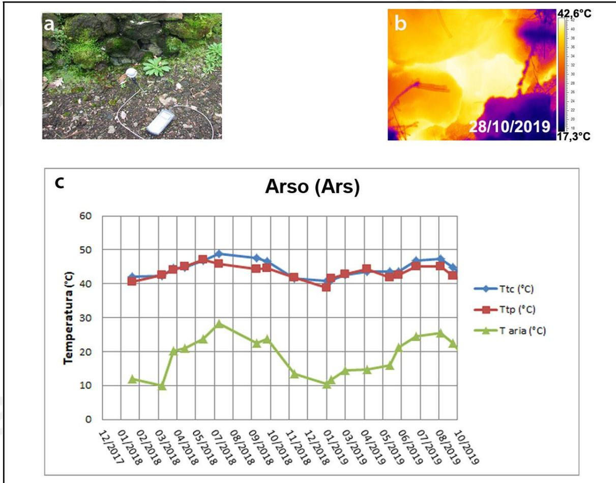
**Figura 3.2** - Cratere dell’Arso a Ischia. Immagini nel visibile (a) e termica (b) riprese dal punto stazione Ars di figura 3.1d. Valori massimi di temperatura con termocamera (Ttc) e valori di temperatura dalla termocoppia (Ttp), confrontati con la temperatura dell’aria misurata nel momento del rilievo termico, da gennaio 2018 a ottobre 2019 (c).
