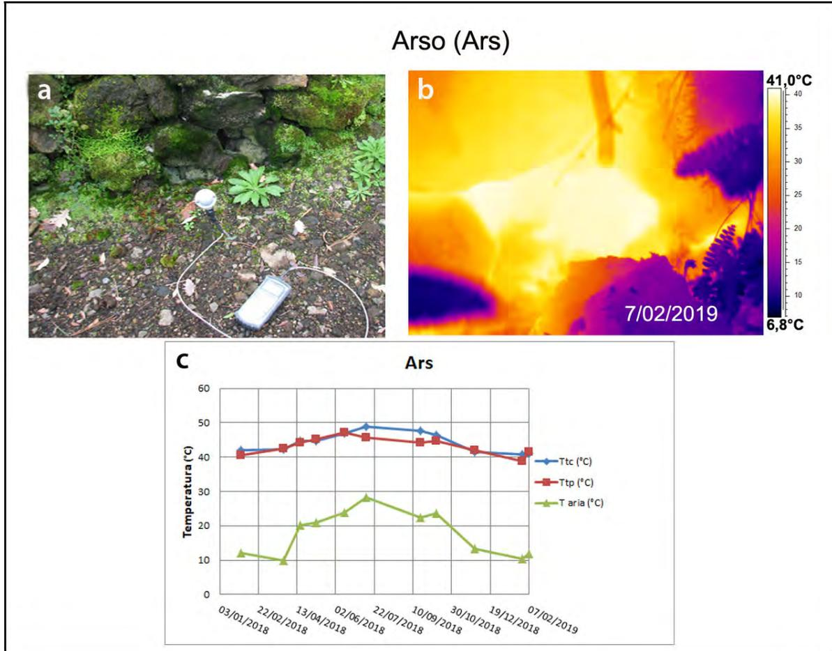
**Figura 3.2** - Cratere dell'Arso a Ischia. Immagini nel visibile (a) e termica (b) riprese dal punto stazione Ars di figura 3.1d. Valori massimi di temperatura con termocamera (Ttc) e valori di temperatura dalla termocoppia (Ttp), confrontati con la temperatura dell'aria misurata nel momento del rilievo termico, da gennaio 2018 a febbraio 2019 (c).
