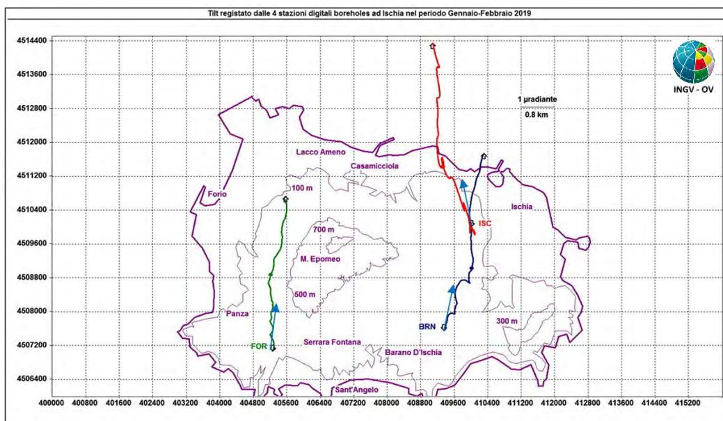
**Figura 2.2.2** – Pattern tiltmetrico osservato ad Ischia. Il lato di ogni maglia del reticolo equivale a 1  $\mu$ radiante o 800 m. Le freccette blu sovrapposte (non in scala) indicano la direzione di abbassamento del suolo.
