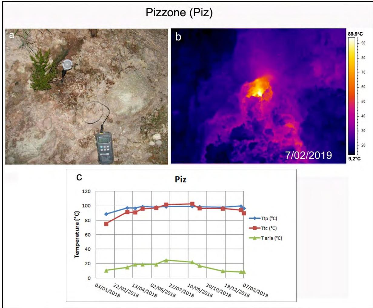
**Figura 3.4** – Fumarola in località Pizzone a Ischia. Immagini nel visibile (a) e termica (b) riprese dal punto stazione Piz di figura 3.1h. Valori massimi di temperatura con termocamera (Ttc) e valori di temperatura dalla termocoppia (Ttp), confrontati con la temperatura dell'aria (c) misurata nel momento del rilievo termico, da gennaio 2018 a febbraio 2019 (c).
