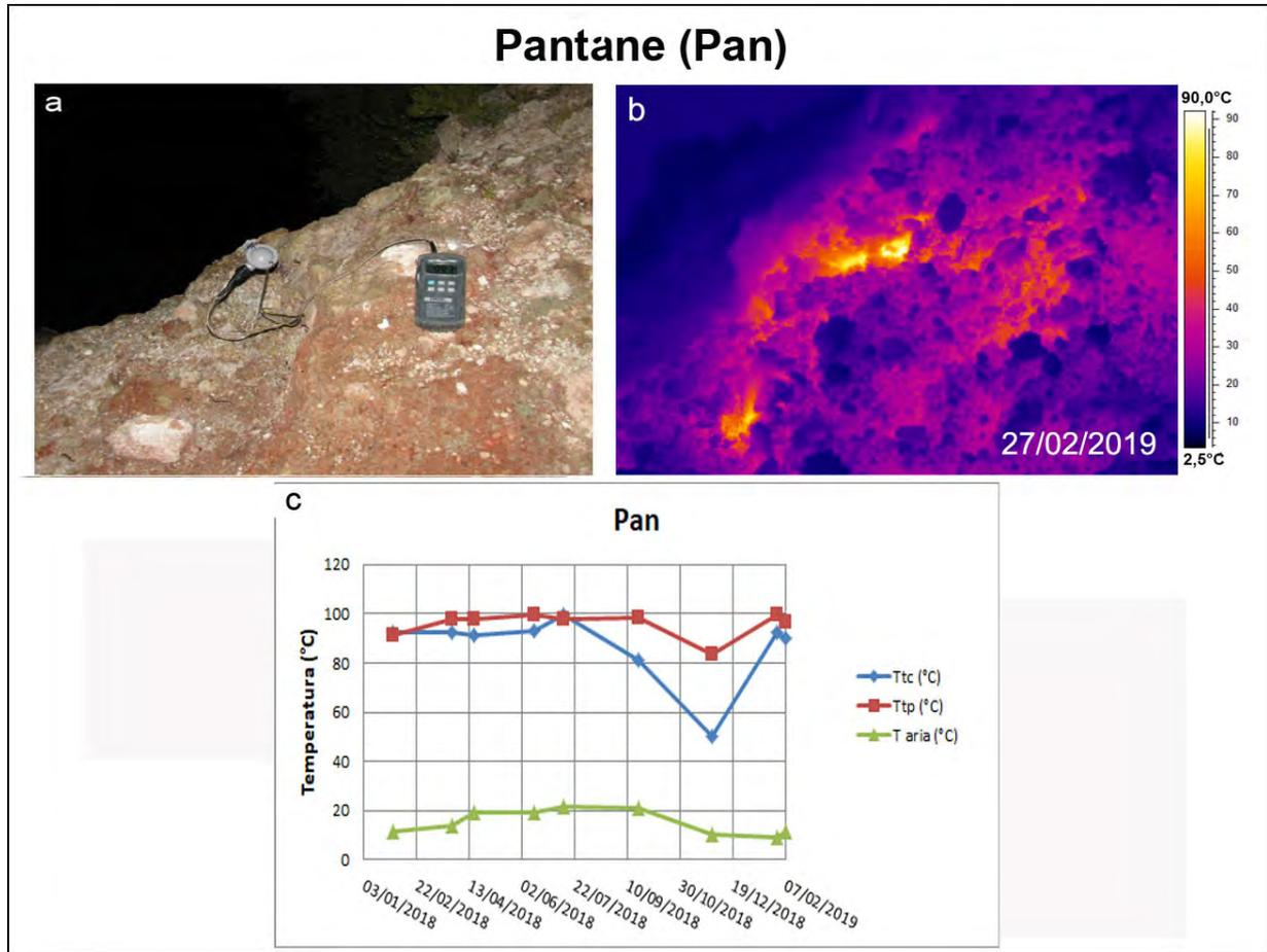
**Figura 3.3** – Fumarola in località Pantane a Ischia. Immagini nel visibile (a) e termica (b) riprese dal punto di misura Pan di figura 3.1a. Valori massimi di temperatura con termocamera (Ttc) e valori di temperatura dalla termocoppia (Ttp), confrontati con la temperatura dell'aria misurata nel momento del rilievo termico, da gennaio 2018 a febbraio 2019 (c).
