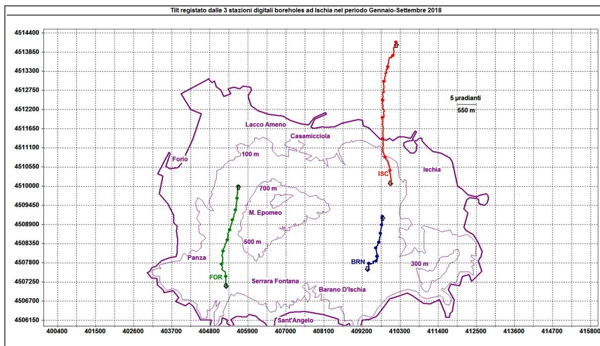
**Figura 2.5** – Pattern tiltmetrico osservato ad Ischia nel periodo gennaio-settembre 2018. Il lato di ogni maglia del reticolo equivale a 5  $\mu$ radianti o 550 m. I pallini sovrapposti sui vettori tilt indicano l'inizio di ogni mese.
