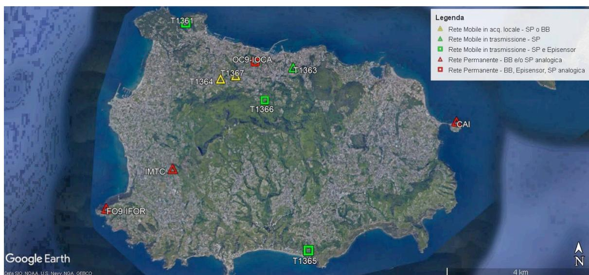
**Figura 3.1** – Ortofoto Isola d'Ischia. I simboli in rosso identificano le stazioni della rete permanente dell'Osservatorio Vesuviano; i simboli in giallo (acquisizione locale) e in verde (in trasmissione) identificano le stazioni temporanee della rete mobile attualmente in funzione. Per la T1365 e T1366 (quadrati in verde) è presente sia il sensore a corto periodo che l'accelerometro. Il simbolo in bianco è relativo alla stazione T1362 disinstallata il giorno 3-10-2017.
