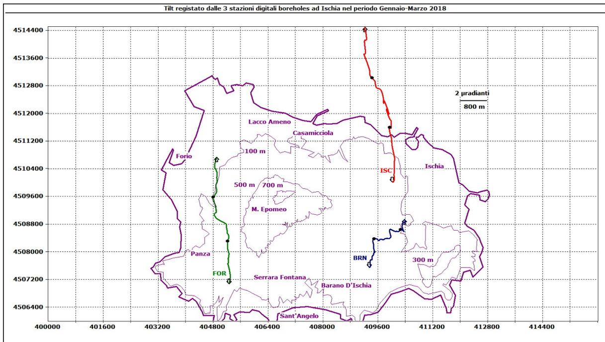
**Figura 2.5** – Pattern tiltmetrico osservato ad Ischia nel periodo gennaio-marzo 2018. Il lato di ogni maglia del reticolo equivale a 2  $\mu$ radianti o 800 m. I pallini neri sovrapposti sui vettori tilt indicano l’inizio di ogni mese.
