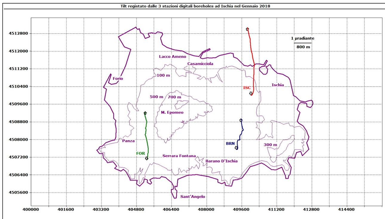
**Figura 2.5** – Pattern tiltmetrico osservato ad Ischia nel gennaio 2018. Il lato di ogni maglia del reticolo equivale ad 1  $\mu$ radiante o 800 m.
