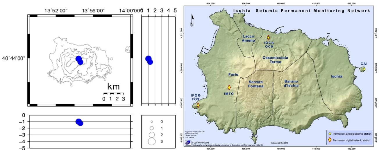
**Figura 1.2** - Localizzazioni ipocentrali ad Ischia nel corso degli ultimi 12 mesi. La dimensione dei simboli è proporzionale alla magnitudo, come indicato nel riquadro in basso. A destra è mostrata la mappa con la rete sismica di Ischia.
