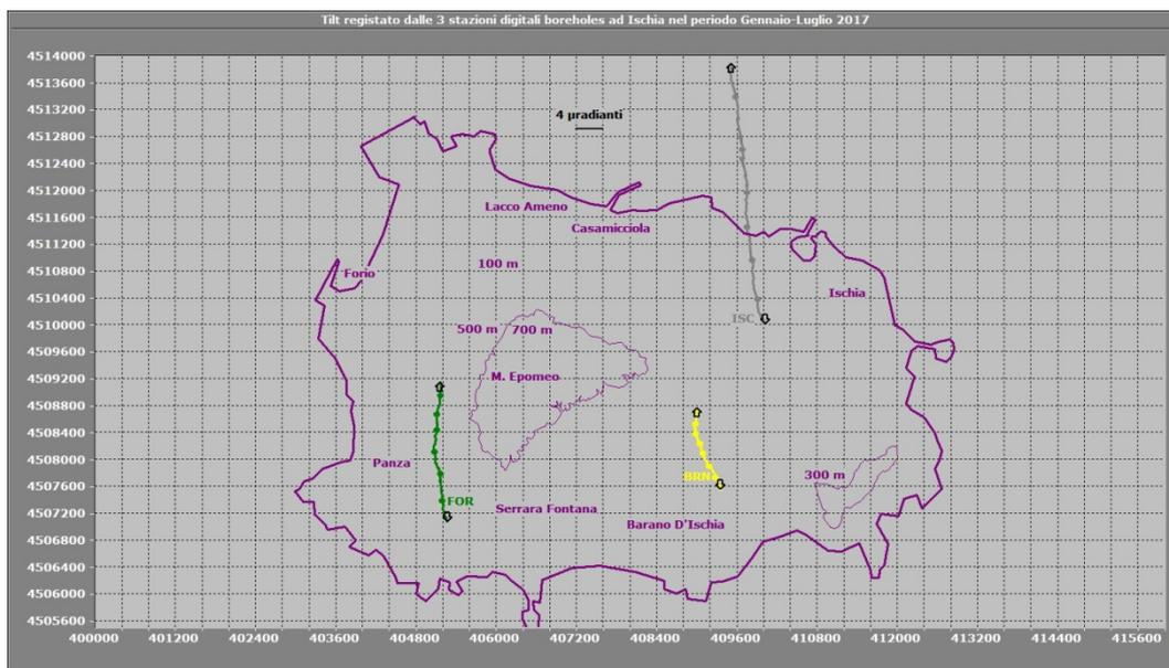
**Figura 2.5** - Odografo del tilting registrato alle stazioni di Ischia nel periodo gennaio-luglio 2017.
