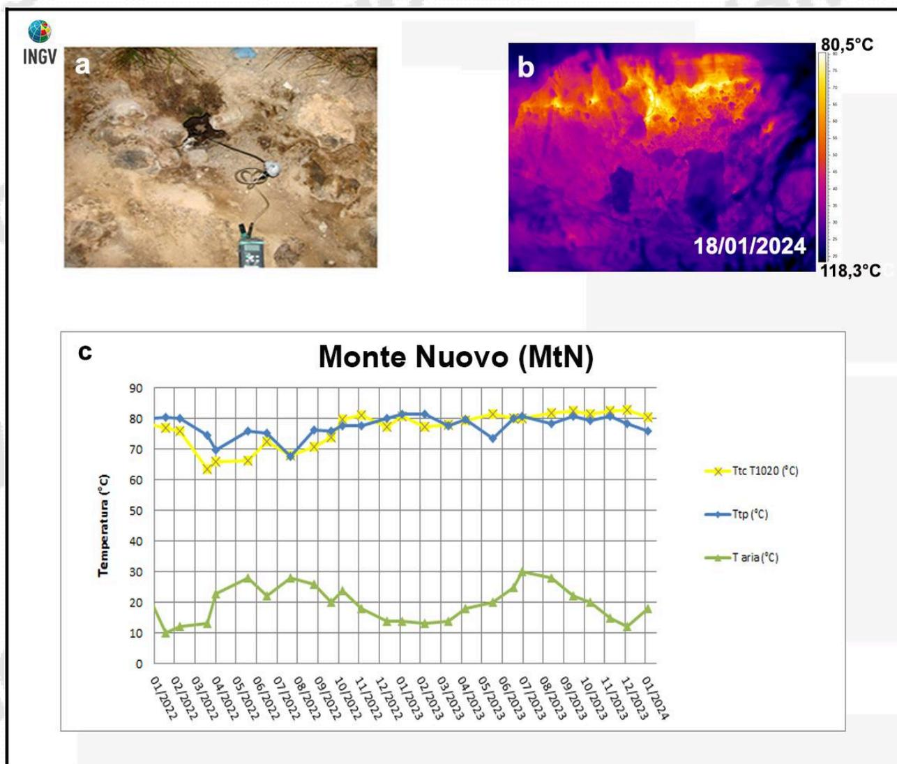
**Figura 3.2.3** – Fumarola lungo il versante meridionale di Monte Nuovo. Immagini nel visibile (a) e termica (b) riprese dal punto MtN di figura 3.2.1e. Valori massimi di temperatura rilevati con la termocamera FLIR T1020 (TtcT1020) e con la termocoppia (Ttp), confrontati con la temperatura dell'aria (Taria) misurata nel momento del rilievo termico, da gennaio 2022 a gennaio 2024 (c).
