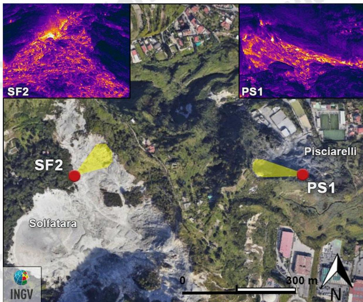
**Figura 3.1.1** - Mappa della Rete Permanente di Monitoraggio Termico ad immagine (TIRNet) con l'ubicazione delle stazioni SF2 e PS1. Pallini rossi: indicano i punti di ripresa; aree gialle: indicano schematicamente le aree acquisite.
