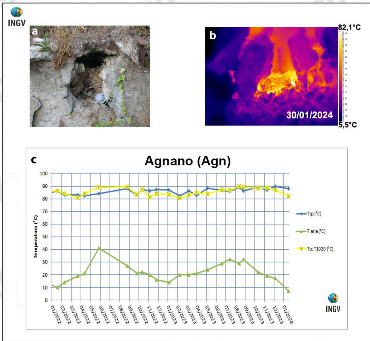
**Figura 3.2.4** – Fumarola all’interno dello stabilimento termale delle “Terme di Agnano”. Immagini nel visibile (a) e termica (b) riprese dal punto stazione Agn di Figura 3.2.1c. Valori massimi di temperatura rilevati con la termocamera FLIR T1020 (TtcT1020) e con la termocoppia (Ttp), confrontati con la temperatura dell’aria (Taria) misurata nel momento del rilievo termico, da gennaio 2022 a gennaio 2024 (c).
