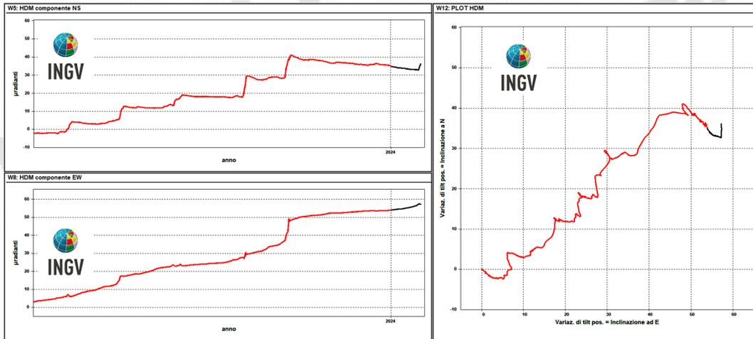
**Figura 2.2.3** – Serie temporali e plot del tilt della stazione HDM della rete dei Campi Flegrei registrati negli ultimi 12 mesi. In nero i dati di gennaio 2024
