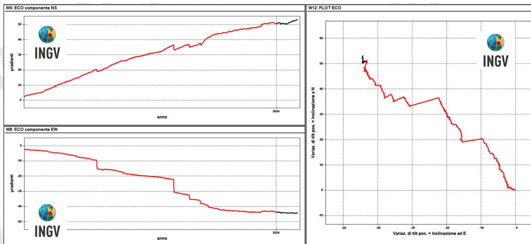
Figura 2.2.2 – Serie temporali e plot del tilt della stazione ECO della rete dei Campi Flegrei registrati negli ultimi 12 mesi. In nero i dati di gennaio 2024
