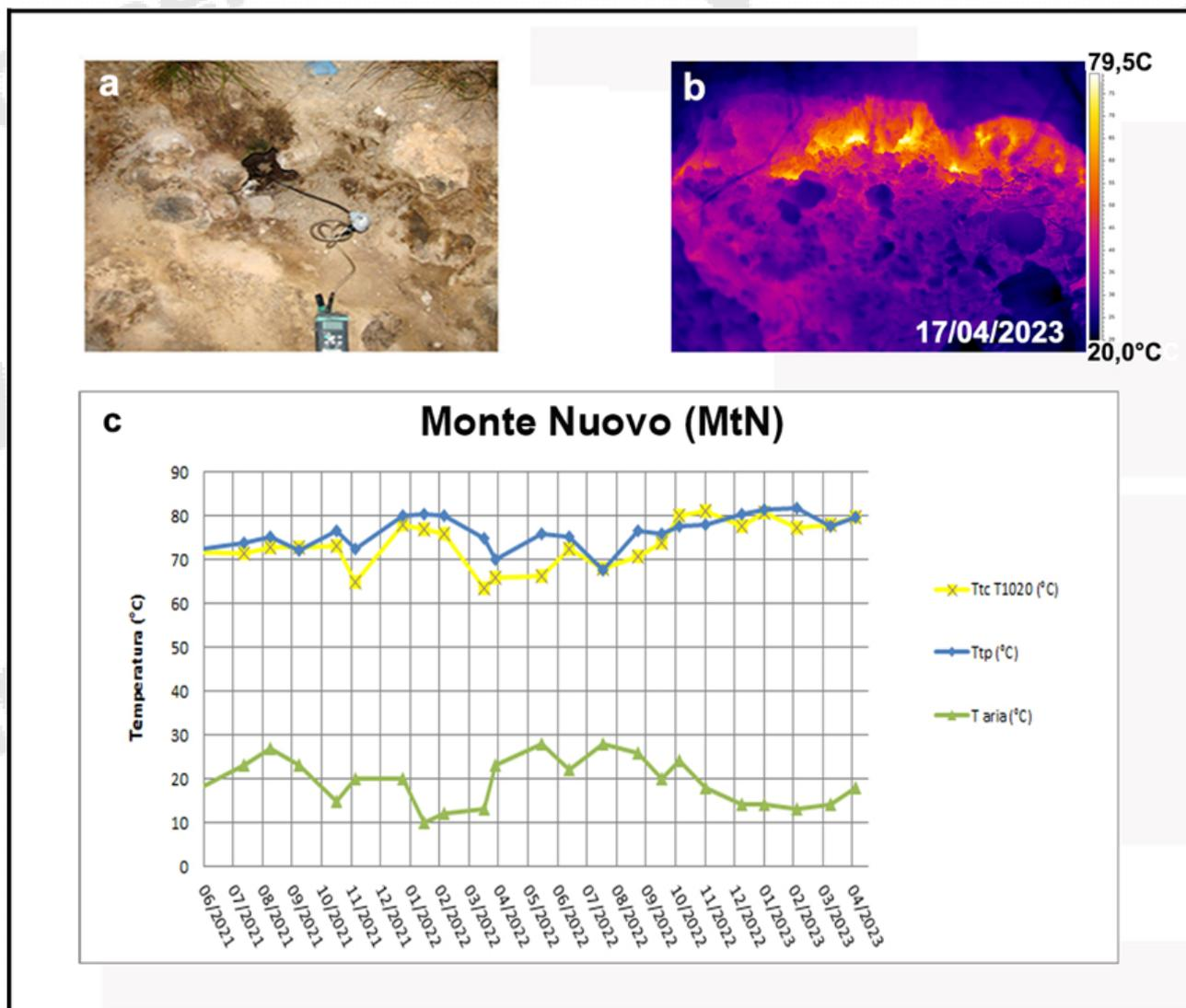
**Figura 3.2.3** – Fumarola lungo il versante meridionale di Monte Nuovo. Immagini nel visibile (a) e termica (b) riprese dal punto MtN di figura 3.2.1e. Valori massimi di temperatura rilevati con la termocamera FLIR T1020 (TtcT1020) e con la termocoppia (Ttp), confrontati con la temperatura dell'aria (Taria) misurata nel momento del rilievo termico, da giugno 2021 ad aprile 2023 (c).
