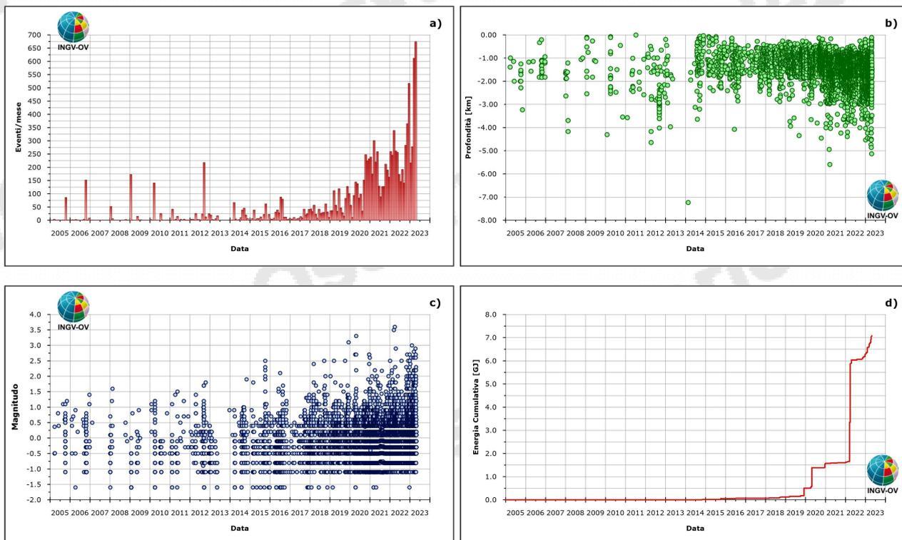
**Figura 1.7** - Andamento dei principali parametri sismologici a partire dal 2005: a) frequenza di accadimento; b) profondità ipocentrali; c) magnitudo; d) energia cumulativa.
