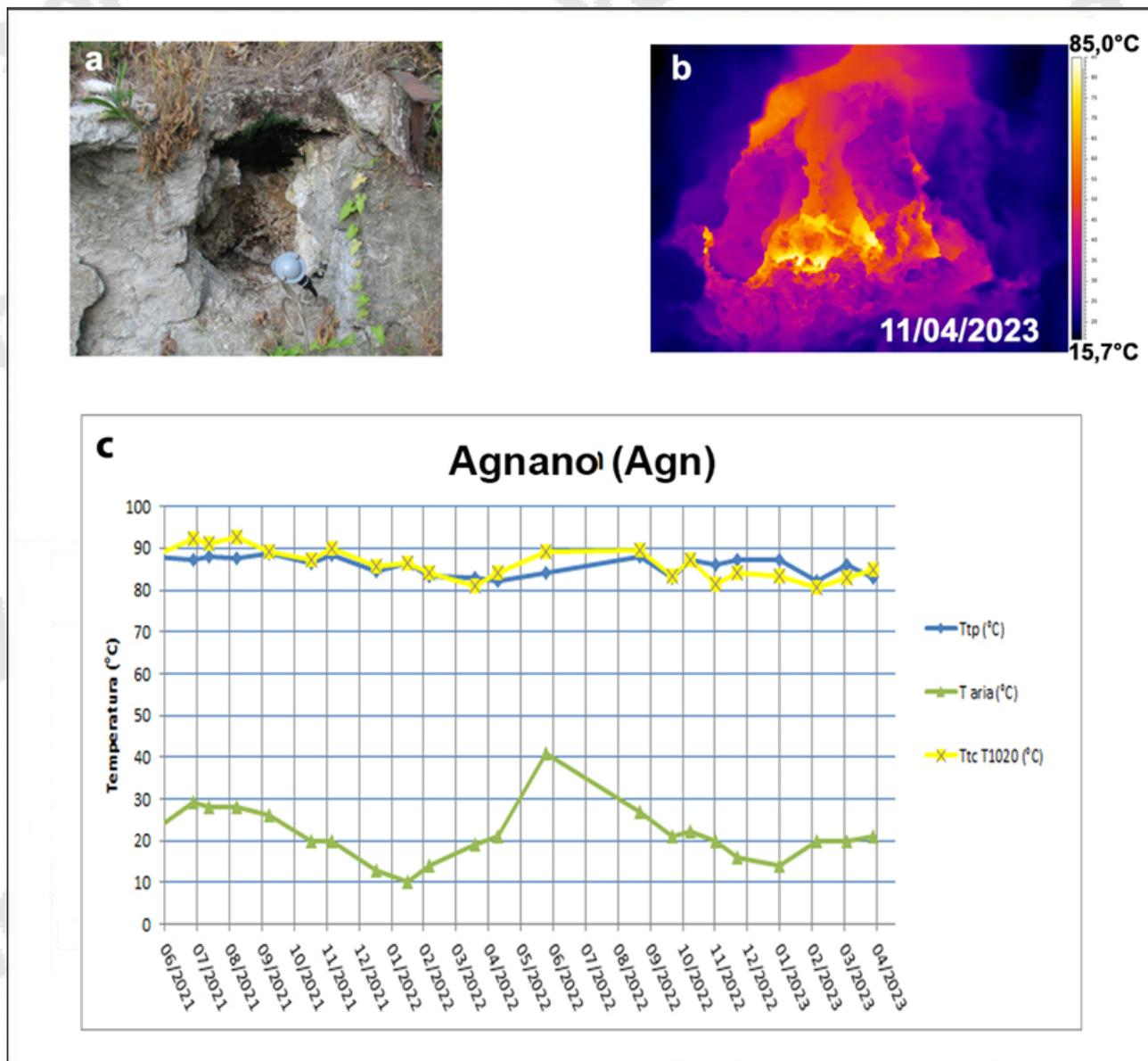
**Figura 3.2.4** – Fumarola all’interno dello stabilimento termale delle “Terme di Agnano”. Immagini nel visibile (a) e termica (b) riprese dal punto stazione Agn di Figura 3.2.1c. Valori massimi di temperatura rilevati con la termocamera FLIR T1020 (TtcT1020) e con la termocoppia (Ttp), confrontati con la temperatura dell’aria (Taria) misurata nel momento del rilievo termico, da giugno 2021 ad aprile 2023 (c).
