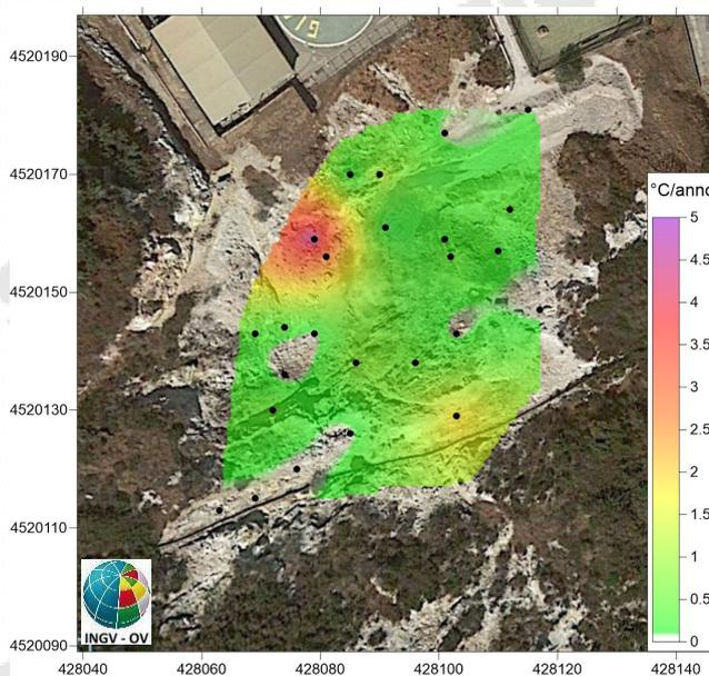
**Figura 4.10** – Mappa dell'incremento di temperatura in °C/anno calcolato per ognuno dei 25 punti fissi nell'area di Pisciarelli misurati a partire dal 2009. L'incremento di temperatura interessa tutta l'area indagata con le zone di maggiore riscaldamento legate a processi di fumarizzazione locale.
