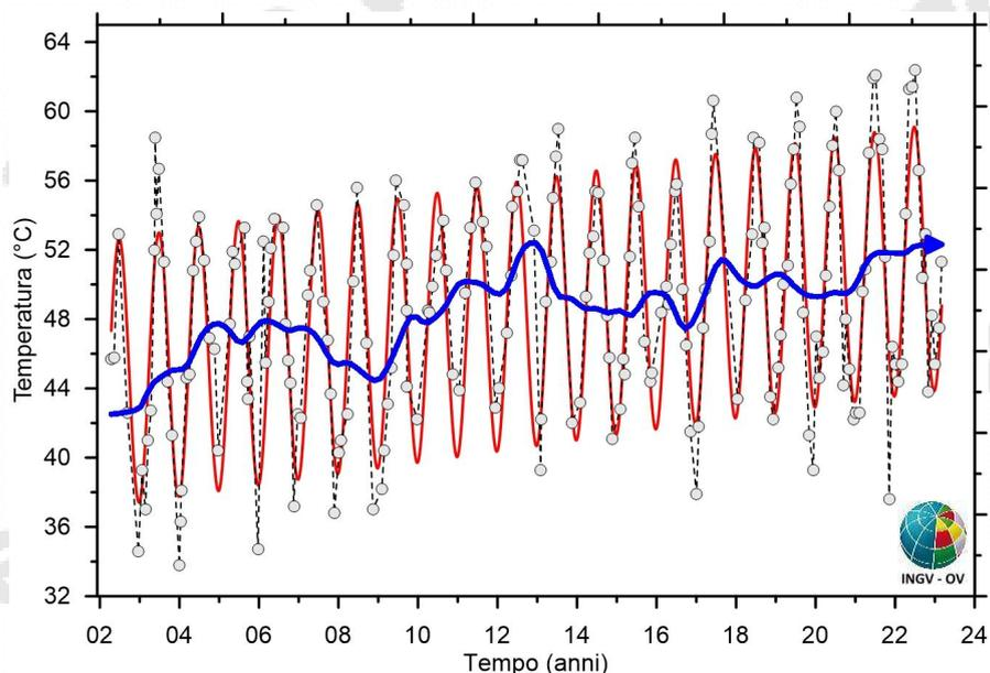
**Figura 4.7** – Cronogramma della media delle temperature del suolo (a 10 cm di profondità) misurate su 61 punti fissi nell'area craterica della Solfatara. Va evidenziato l'incremento del valore medio nel periodo 2002-2022 di oltre 6 °C. Il trend depurato dalla componente stagionale mediante l'utilizzo dell'algoritmo di destagionalizzazione STL (Seasonal-Trend decomposition based on Loess, Cleveland et al., 1990), è riportato con la linea blu.
