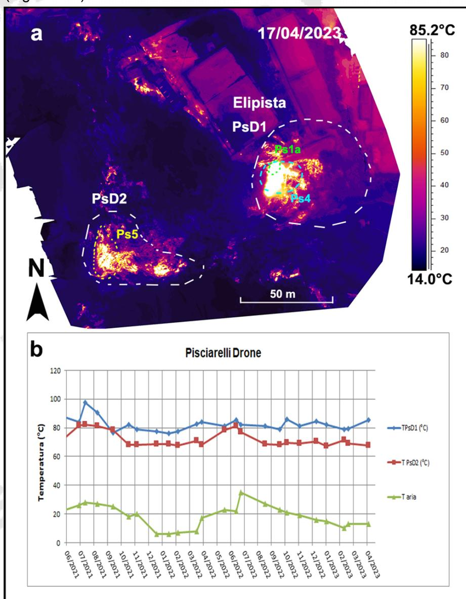
**Figura 3.2.2** – Fotocomposizione di immagini termiche rilevate da drone nel mese di aprile 2023 (a) e valori massimi di temperatura (T) delle aree a maggiore anomalia termica (PsD1 e PsD2) confrontati con la temperatura dell'aria (Taria) misurata nel momento del rilievo termico da giugno 2020 ad aprile 2023 (b).
