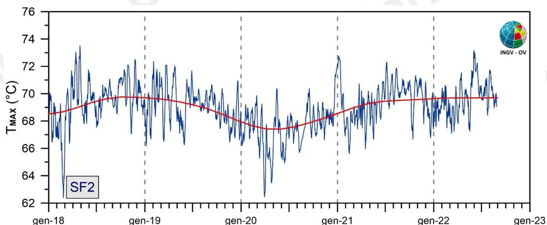
**Figura 3.1.2** - Stazione SF2: Serie temporali dei valori di temperatura massima giornaliera rilevata nelle immagini IR destagionalizzate mediante applicazione dell'algoritmo STL [medie settimanali (blu); trend a lungo termine (rosso)].
