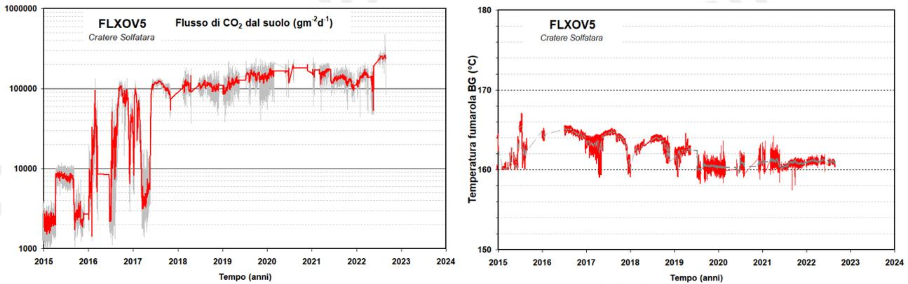
**Figura 4.11** – Valori del flusso di CO<sub>2</sub> dal suolo e della temperatura della fumarola BG misurati dalla stazione FLXOV5 installata nel cratere della Solfatara a pochi metri dalla fumarola principale BG. I valori di flusso di CO<sub>2</sub> dal suolo mostrano, in generale, un significativo incremento a partire dal 2016 (la linea rossa si riferisce alle medie giornaliere).
