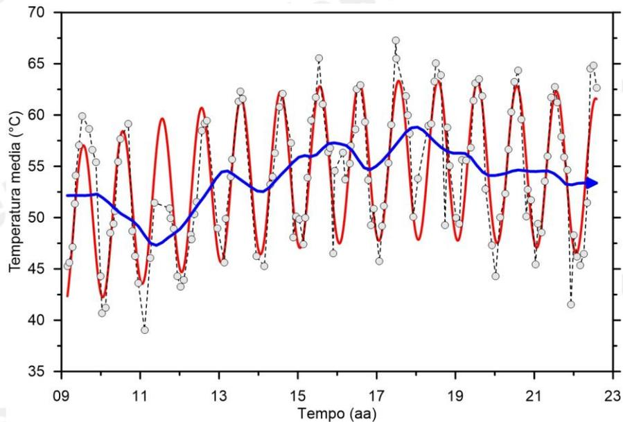
**Figura 4.9** – Cronogramma della media delle temperature del suolo (a 10 cm di profondità) misurate su 25 punti fissi nell'area di Pisciarelli dal 2009. Il trend destagionalizzato, mediante l'utilizzo dell'algoritmo di destagionalizzazione STL (Seasonal-Trend decomposition based on Loess, Cleveland et al., 1990), è riportato con la linea blu.
