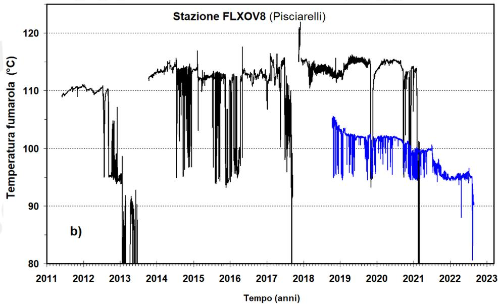
**Figura 4.13** – Cronogramma dal 2011 della temperatura della fumarola principale di Pisciarelli. Con la linea blu sono riportati i valori di temperatura misurati in continuo, a partire dal mese di ottobre 2018, in un'altra emissione fumarolica nell'area di Pisciarelli sita a pochi metri di distanza dalla fumarola principale e caratterizzata da una minore temperatura di emissione.
