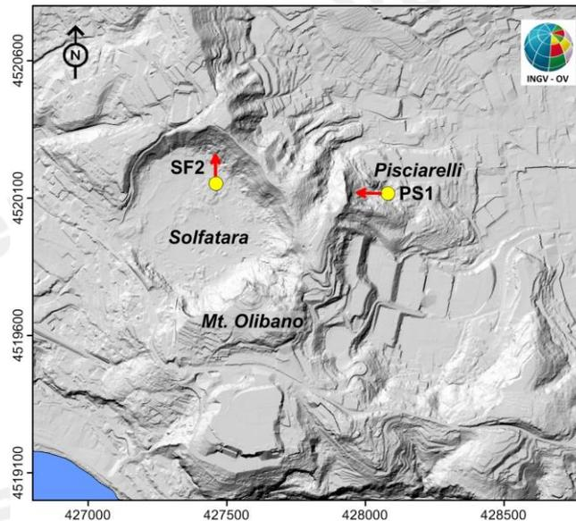
**Figura 3.1.1** - Mappa della Rete Permanente di Monitoraggio Termico ad immagine (TIRNet) con l'ubicazione delle stazioni SF2 e PS1. Pallini Gialli: punti di ripresa; frecce rosse: indicano schematicamente le aree campionate.
