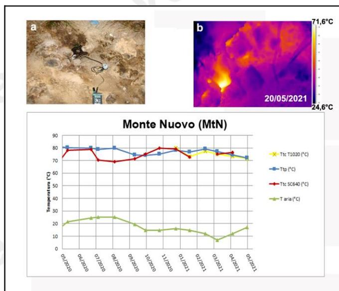
**Figura 3.2.3** – Fumarola lungo il versante meridionale di Monte Nuovo. Immagini nel visibile (a) e termica (b) riprese dal punto MtN di figura 3.2.1e. Valori massimi di temperatura con termocamera FLIR SC640 (TtcSC640), valori massimi di temperatura con termocamera FLIR T1020 (TtcT1020) e valori di temperatura dalla termocoppia (Ttp), confrontati con la temperatura dell'aria (Taria) misurata nel momento del rilievo termico, da maggio 2020 a maggio 2021 (c).
