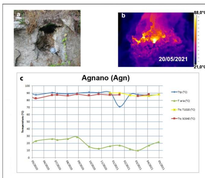
**Figura 3.2.4** – Fumarola all'interno dello stabilimento termale delle "Terme di Agnano". Immagini nel visibile (a) e termica (b) riprese dal punto stazione Agn di figura 3.2.1c. Valori massimi di temperatura con termocamera FLIR SC640 (TtcSC640), valori massimi di temperatura con termocamera FLIR T1020 (TtcT1020) e valori di temperatura dalla termocoppia (Ttp), confrontati con la temperatura dell'aria (Taria) misurata nel momento del rilievo termico, da maggio 2020 a maggio 2021 (c).
