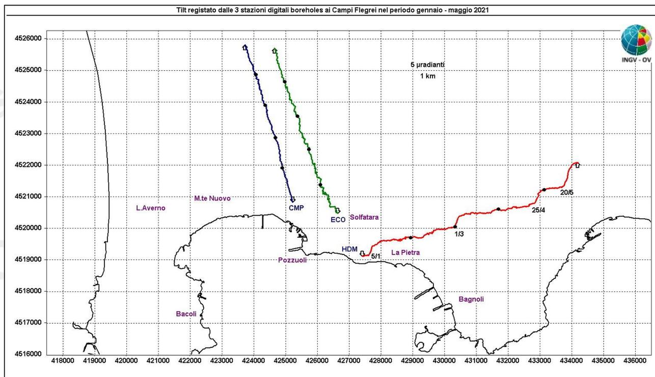
**Figura 2.2.2** - Pattern tiltmetrico osservato ai Campi Flegrei. Per comodità di rappresentazione grafica e per una interpretazione più agevole, sono riportate solo le 3 stazioni “borehole” con sensori ubicati a 25 m di profondità. Il lato di ogni maglia del reticolo equivale a 5  $\mu$ radianti o 1.0 km ed i pallini in colore sovrapposti sui vettori tilt indicano intervalli di un mese.
