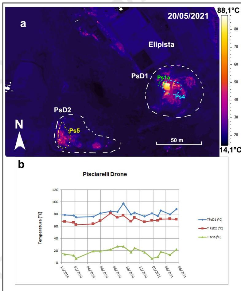
**Figura 3.2.2** – Fotocomposizione di immagini termiche rilevate da drone nel mese di aprile 2021 (a) e valori massimi di temperatura (T) delle aree a maggiore anomalia termica (PsD1 e PsD2) confrontati con la temperatura dell'aria (Taria) misurata nel momento del rilievo termico da dicembre 2019 a maggio 2021 (b).
