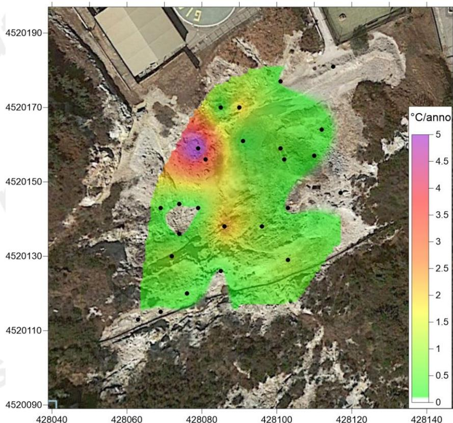
**Figura 4.10** – Mappa dell'incremento di temperatura in °C/anno calcolato per ognuno dei 25 punti fissi nell'area di Pisciarelli misurati a partire dal 2009. L'incremento di temperatura interessa tutta l'area indagata con le zone di maggiore riscaldamento legate a processi di fumarolizzazione locale.
