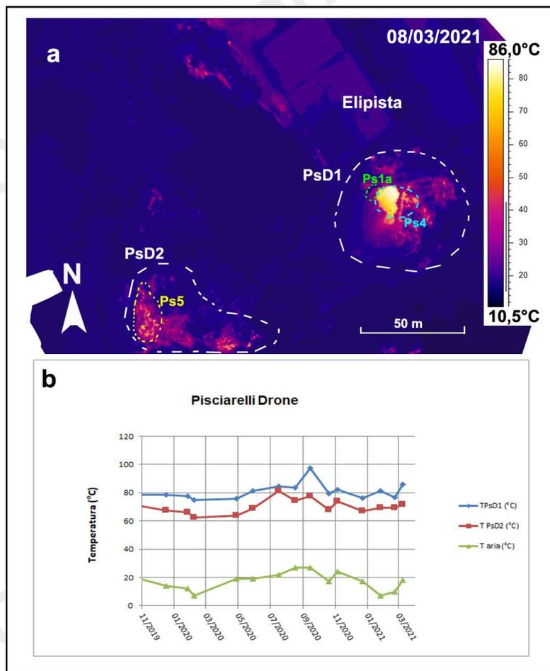
**Figura 3.2.2** – Fotocomposizione di immagini termiche rilevate da drone nel mese di marzo 2021 (a) e valori massimi di temperatura (T) delle aree a maggiore anomalia termica (PsD1 e PsD2) confrontati con la temperatura dell'aria (Taria) misurata nel momento del rilievo termico da novembre 2019 a marzo 2021 (b).
