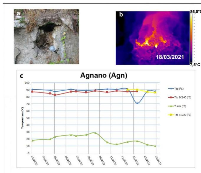
**Figura 3.2.4** – Fumarola all'interno dello stabilimento termale delle "Terme di Agnano". Immagini nel visibile (a) e termica (b) riprese dal punto stazione Agn di figura 3.2.1c. Valori massimi di temperatura con termocamera FLIR SC640 (TtcSC640), valori massimi di temperatura con termocamera FLIR T1020 (TtcT1020) e valori di temperatura dalla termocoppia (Ttp), confrontati con la temperatura dell'aria (Taria) misurata nel momento del rilievo termico, da marzo 2020 a marzo 2021 (c).
