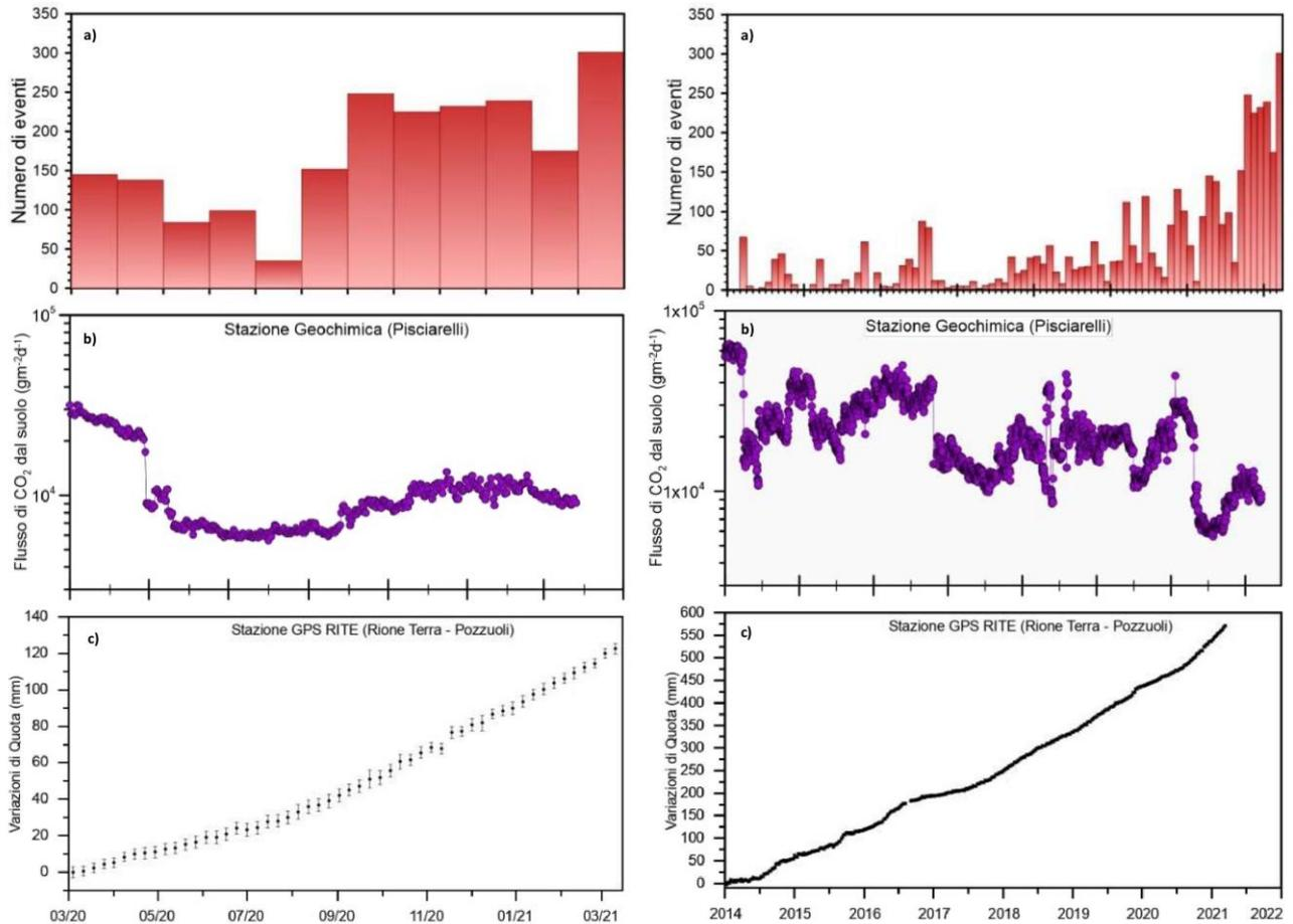
**Figura 5.1** – Frequenza di accadimento degli eventi sismici (a), variazioni del flusso di CO<sub>2</sub> alla stazione geochimica di Pisciarelli (b) e andamento delle deformazioni del suolo alla stazione GPS di RITE (c) negli ultimi dodici mesi (a sinistra) e dal 2014 (a destra).
