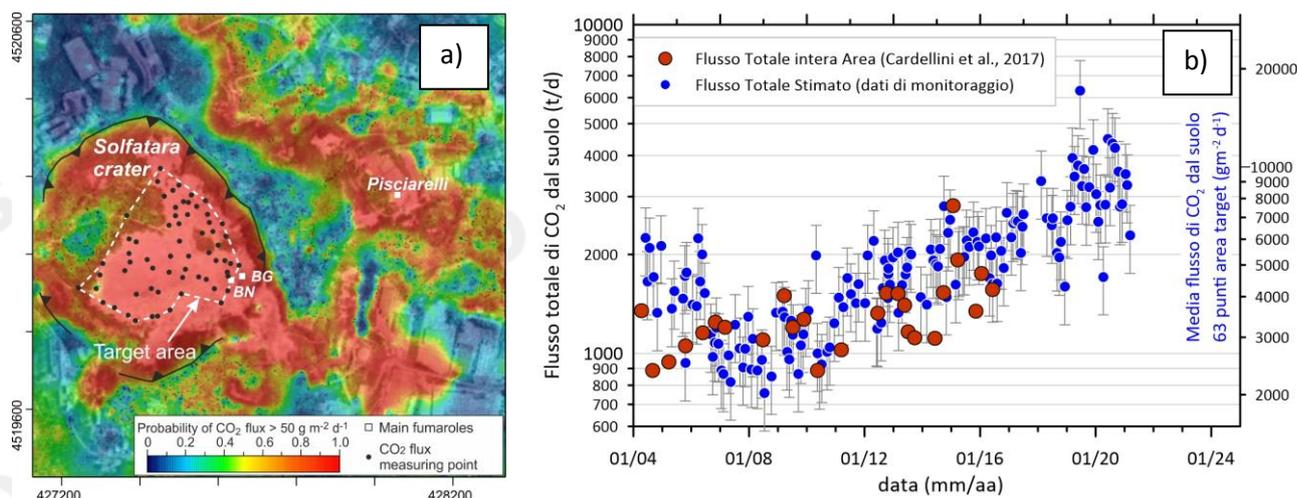
**Figura 4.6** – a) Mappa dell’area di degassamento diffuso della Solfatara-Pisciarelli (Cardellini et al., 2017), con l’ubicazione dell’area target; b) Cronogramma dei flussi di CO<sub>2</sub>, i punti blu si riferiscono all’emissione dall’area target scalati sull’intera DDS, ottenuta dal confronto con i dati delle 30 campagne estive (simboli rossi) in Cardellini et al. (2017).
