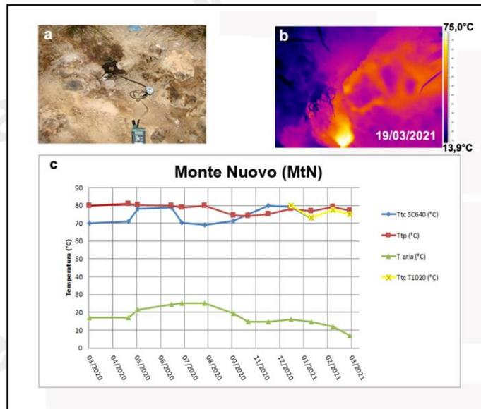
**Figura 3.2.3** – Fumarola lungo il versante meridionale di Monte Nuovo. Immagini nel visibile (a) e termica (b) riprese dal punto MtN di figura 3.2.1e. Valori massimi di temperatura con termocamera FLIR SC640 (TtcSC640), valori massimi di temperatura con termocamera FLIR T1020 (TtcT1020) e valori di temperatura dalla termocoppia (Ttp), confrontati con la temperatura dell'aria (Taria) misurata nel momento del rilievo termico, da marzo 2020 a marzo 2021 (c).
