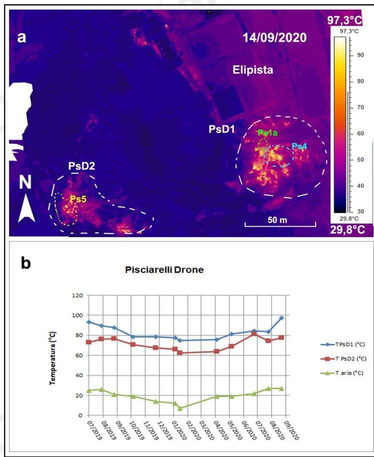
**Figura 3.2.2** – Fotocomposizione di immagini termiche rilevate da drone nel mese di settembre 2020 (a) e relativi valori massimi di temperatura (T) da luglio 2019 a settembre 2020 (b).
