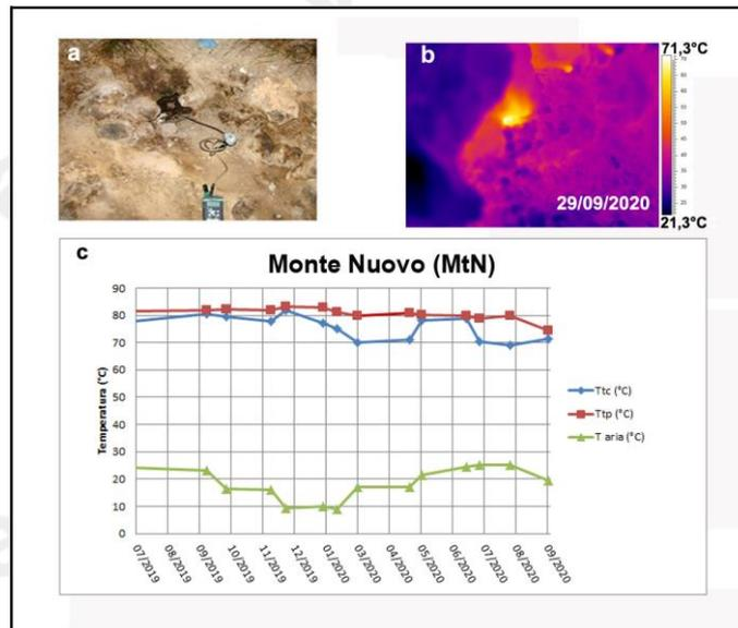
**Figura 3.2.3** – Fumarola lungo il versante meridionale di Monte Nuovo. Immagini nel visibile (a) e termica (b) riprese dal punto MtN di figura 3.2.1e. Valori massimi di temperatura con termocamera (Ttc) e valori di temperatura dalla termocoppia (Ttp), confrontati con la temperatura dell'aria misurata nel momento del rilievo termico, da luglio 2019 a settembre 2020 (c).
