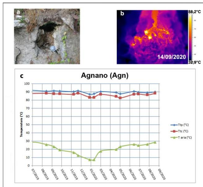
**Figura 3.2.4** – Fumarola all'interno dello stabilimento termale delle "Terme di Agnano". Immagini nel visibile (a) e termica (b) riprese dal punto stazione Agn di figura 3.2.1c. Valori massimi di temperatura con termocamera (Ttc) e valori di temperatura dalla termocoppia (Ttp), confrontati con la temperatura dell'aria misurata nel momento del rilievo termico, da luglio 2019 a settembre 2020 (c).
