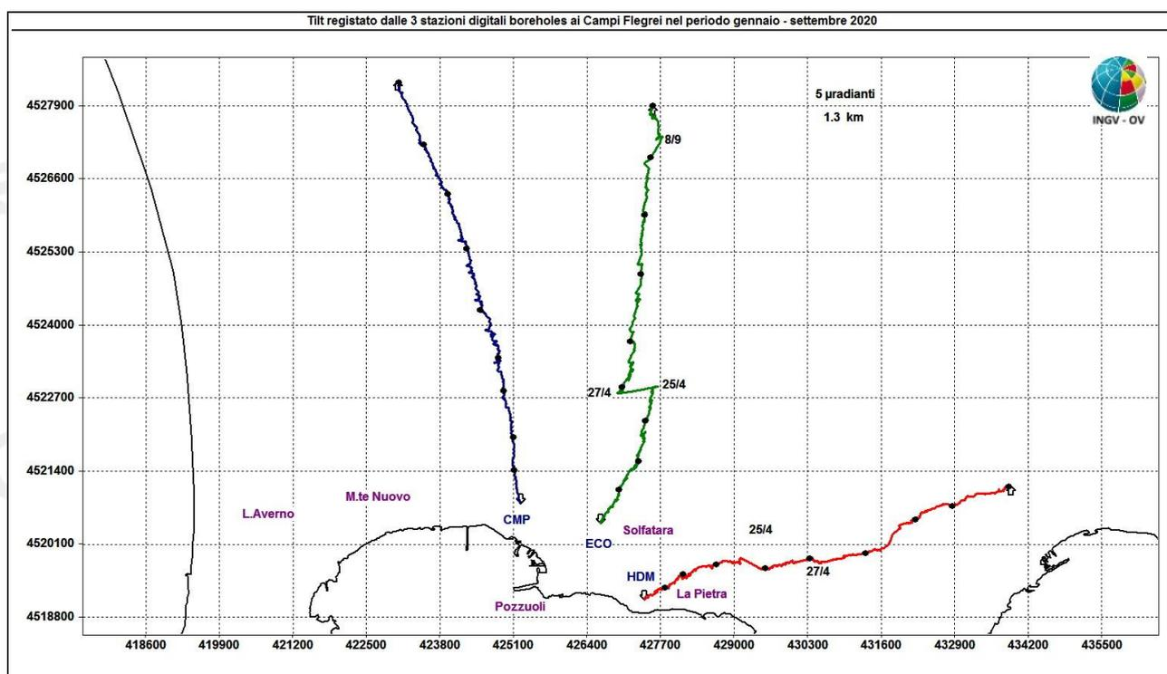
**Figura 2.2.2** - Pattern tiltmetrico osservato ai Campi Flegrei. Per comodità di rappresentazione grafica e per una interpretazione più agevole, sono riportate solo le 3 stazioni “borehole” con sensori ubicati a 25 m di profondità. Il lato di ogni maglia del reticolo equivale a 5  $\mu$ radianti o 1.3 km ed i pallini in colore sovrapposti sui vettori tilt indicano intervalli di un mese.
