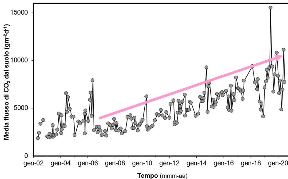
**Figura 4.6** – Cronogramma della media dei flussi di  $\text{CO}_2$  dal suolo misurati mensilmente su 61 punti fissi nell'area craterica della Solfatara.
