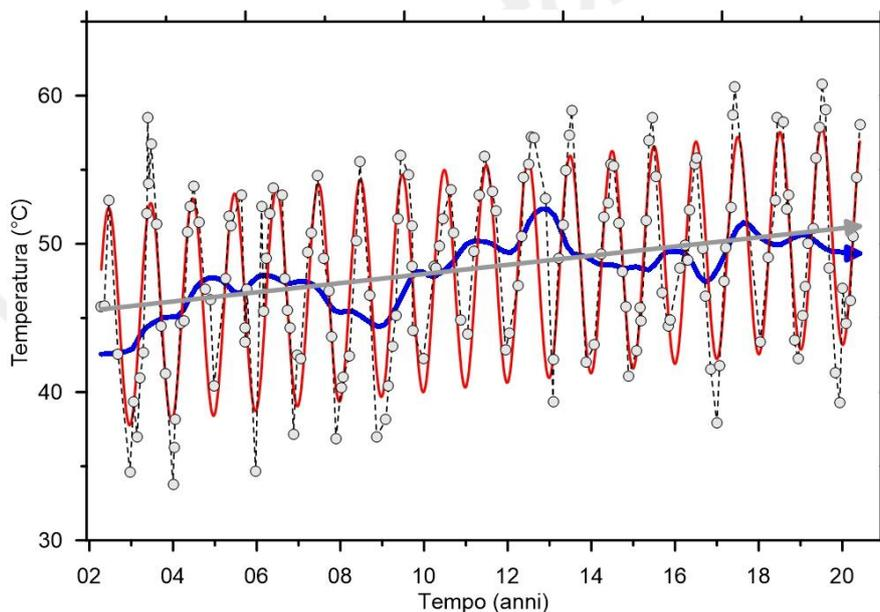
**Figura 4.7** – Cronogramma della media delle temperature del suolo (a 10 cm di profondità) misurate su 61 punti fissi nell'area craterica della Solfatara. Va evidenziato l'incremento del valore medio nel periodo 2002-2020 di oltre 6 °C. Il trend depurato dalla componente stagionale, mediante l'utilizzo dell'algoritmo di destagionalizzazione STL (Seasonal-Trend decomposition based on Loess, Cleveland et al., 1990), è riportato con la linea blu.
