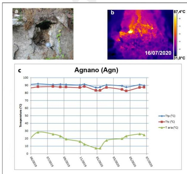
**Figura 3.2.4** – Fumarola all'interno dello stabilimento termale delle "Terme di Agnano". Immagini nel visibile (a) e termica (b) riprese dal punto stazione Agn di figura 3.2.1c. Valori massimi di temperatura con termocamera (Ttc) e valori di temperatura dalla termocoppia (Ttp), confrontati con la temperatura dell'aria misurata nel momento del rilievo termico, da giugno 2019 a luglio 2020 (c).
