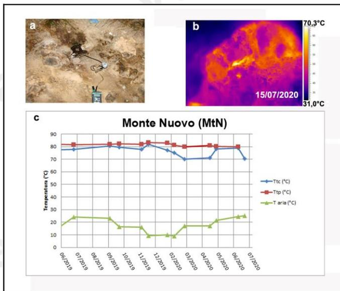
**Figura 3.2.3** – Fumarola lungo il versante meridionale di Monte Nuovo. Immagini nel visibile (a) e termica (b) riprese dal punto MtN di figura 3.2.1e. Valori massimi di temperatura con termocamera (Ttc) e valori di temperatura dalla termocoppia (Ttp), confrontati con la temperatura dell'aria misurata nel momento del rilievo termico, da giugno 2019 a luglio 2020 (c).
