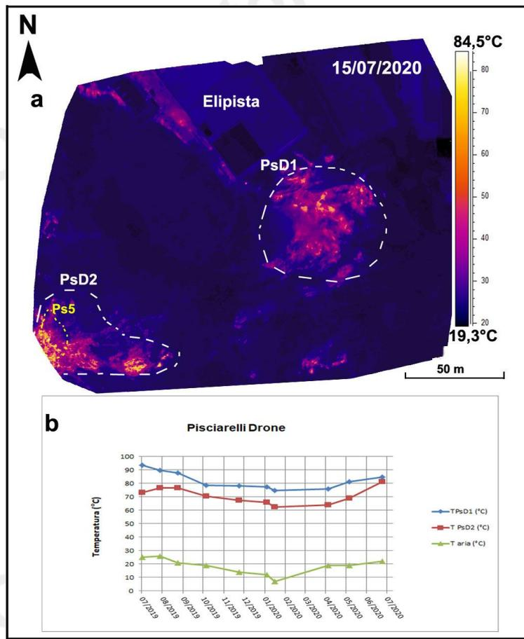
**Figura 3.2.2** – Fotocomposizione di immagini termiche rilevate da drone nel mese di luglio 2020 (a) e relativi valori massimi di temperatura (T) da luglio 2019 a luglio 2020 (b); fotocomposizione di immagini termiche riprese con termocamera mobile dal punto PS4 (Fig.3.2.1b) il 16 luglio 2020.
