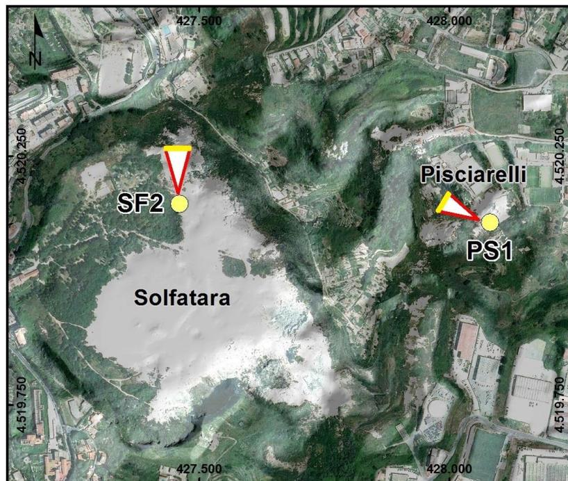
**Figura 3.1.1** - Mappa della Rete Permanente di Monitoraggio Termico ad immagine (TIRNet) con l'ubicazione delle stazioni SF2 e PS1. Punto giallo: posizione della stazione; base del triangolo: area campionata.
