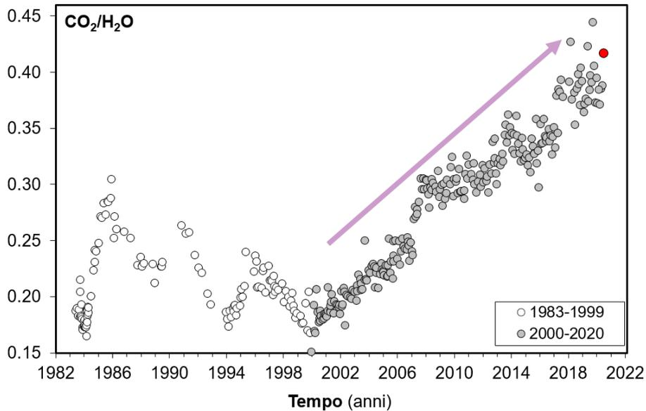
**Figura 4.2** - Cronogramma del rapporto  $\text{CO}_2/\text{H}_2\text{O}$  per la fumarola BG. In grigio sono riportati i dati a partire dal 2000, quando è iniziato un trend d'aumento del rapporto  $\text{CO}_2/\text{H}_2\text{O}$ , in generale, indicativo di una crescente frazione della componente magmatica nei fluidi fumarolici. Con il simbolo rosso è evidenziato il campione di luglio 2020.
