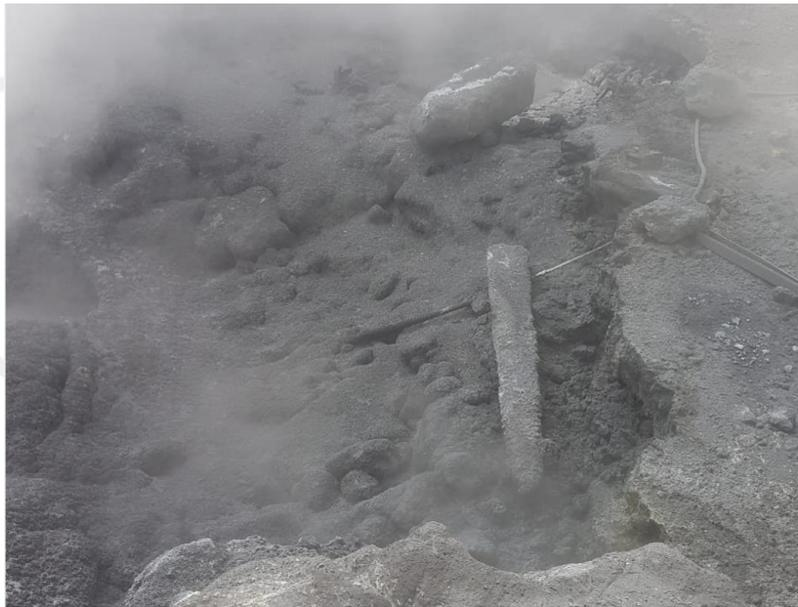
**Figura 4.16** – Situazione della polla principale di Pisciarelli in data 21 luglio. Si noti l’abbassamento del livello del liquido che ha esposto il sensore per la misura della temperatura.
