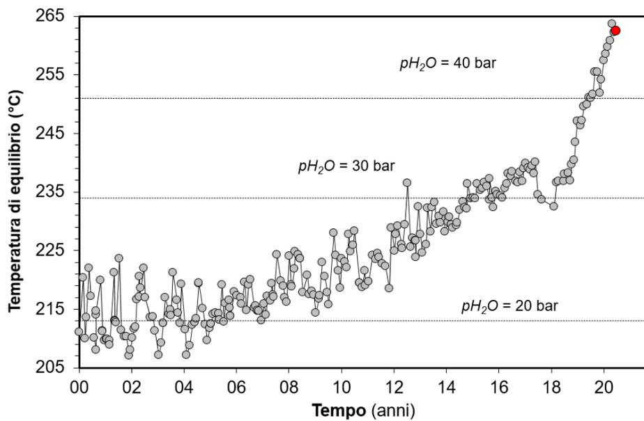
**Figura 4.4** – Cronogramma delle temperature di equilibrio per il sistema CO-CO<sub>2</sub>, stimate assumendo condizioni redox fissate dalla relazione di D'Amore and Panichi (1980). Tali temperature, rappresentative della parte più superficiale del sistema idrotermale (Caliro et al., 2007), mostrano un trend d'aumento a partire dai primi anni del 2000. Con il simbolo rosso è evidenziato il campione di luglio 2020 relativo alla fumarola BG.
