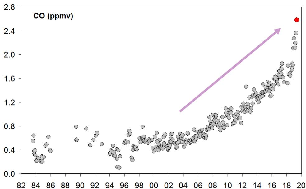
**Figura 4.3** – Variazioni della concentrazione di monossido di carbonio (CO) misurato alla fumarola BG a partire dal 1983. Con il simbolo rosso è evidenziato il campione di maggio 2019. In generale alti contenuti di CO caratterizzano sistemi vulcanici ad elevata temperatura mentre fumarole alimentate da sistemi idrotermali mostrano concentrazioni più basse, in tali sistemi un aumento delle concentrazioni di CO può riflettere un incremento delle condizioni di pressione e temperatura.
