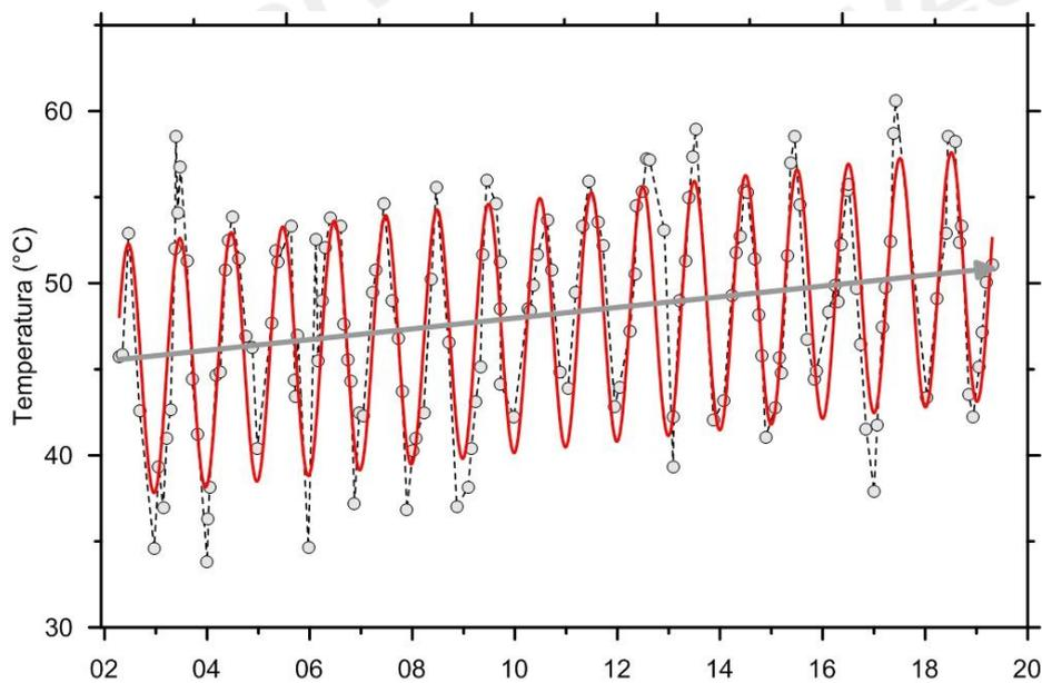
**Figura 4.7** - Cronogramma della media delle temperature del suolo (a 10 cm di profondità) misurate su 61 punti fissi nell'area craterica della Solfatara. Va evidenziato l'incremento del valore medio nel periodo 2002-2019 di oltre 6 °C.
