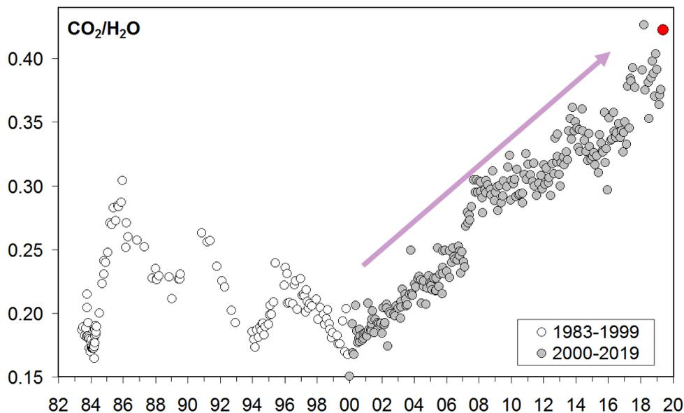
**Figura 4.2** - Cronogramma del rapporto  $\text{CO}_2/\text{H}_2\text{O}$  per la fumarola BG. In grigio sono riportati i dati a partire dal 2000, quando è iniziato un trend d'aumento del rapporto  $\text{CO}_2/\text{H}_2\text{O}$ , in generale, indicativo di una crescente frazione della componente magmatica nei fluidi fumarolici. Con il simbolo rosso è evidenziato il campione di maggio 2019.
