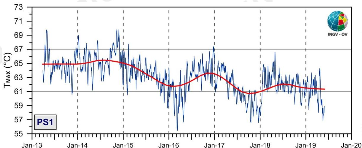
**Figura 3.1.3** - Stazione PS1. Serie temporali delle medie settimanali (blu) e del trend a lungo termine (rosso) dei valori di temperatura massima rilevati nell'immagine IR destagionalizzate mediante applicazione dell' algoritmo STL.
