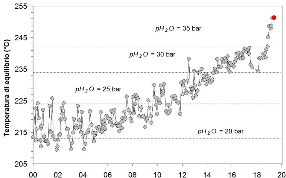
**Figura 4.4** – Cronogramma delle temperature di equilibrio per il sistema  $CO-CO_2$ , stimate assumendo condizioni redox fissate dalla relazione di D’Amore and Panichi (1980). Tali temperature, rappresentative della parte più superficiale del sistema idrotermale (Caliro et al., 2007), mostrano un trend d’aumento a partire dai primi anni del 2000. Con il simbolo rosso è evidenziato il campione di maggio 2019 relativo alla fumarola BG.
