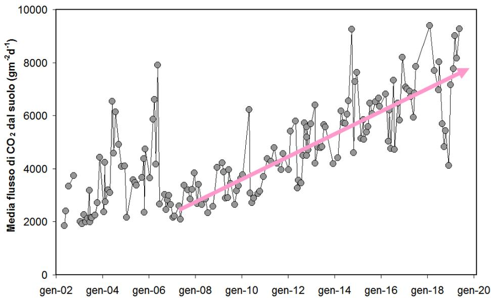
**Figura 4.6** – Cronogramma della media dei flussi di CO<sub>2</sub> dal suolo misurati mensilmente su 61 punti fissi nell'area craterica della Solfatara
