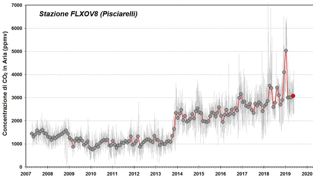
**Figura 4.15** - Cronogramma delle medie giornaliere (linea) e medie mensili (cerchi) della concentrazione di CO<sub>2</sub> registrata in aria con frequenza bioraria dalla stazione geochimica per la misura del flusso di CO<sub>2</sub> dal suolo di Pisciarelli, stazione recentemente sostituita con una nuova stazione multiparametrica del tipo GEMMA (FLXOV8). E' da evidenziare il continuo trend d'aumento nel tempo delle concentrazioni sin dal 2013.
