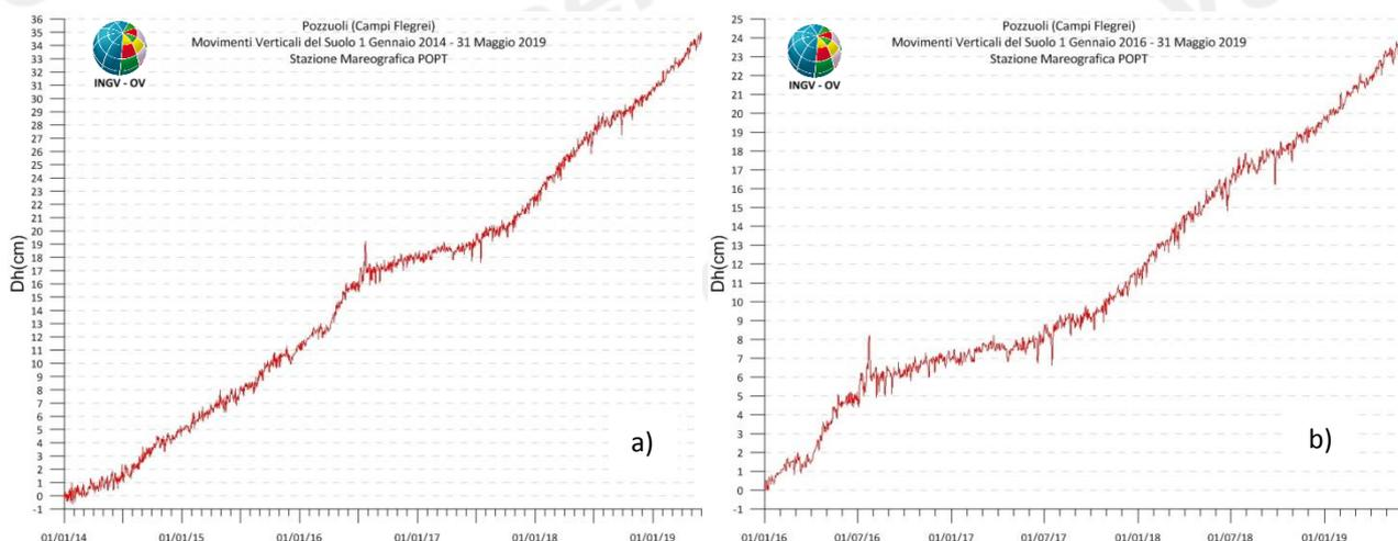
**Figura 2.3.2** - Movimenti verticali del suolo, nel periodo gennaio 2014 – maggio 2019 (a) e gennaio 2016 – maggio 2019 (b), ottenuti dall'analisi dei dati acquisiti dal sensore digitale alla stazione mareografica di Pozzuoli Porto (POPT) (area centrale della caldera flegrea). Le variazioni riportate rappresentano le medie giornaliere e sono riferite alla stazione di Napoli molo S.Vincenzo (NAMM).
