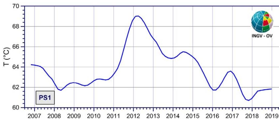
**Figura 3.4** - Stazione PS1: Stazione Pisciarelli. Trend a lungo termine dei valori di temperatura massima rilevati nell'immagine IR ottenuto mediante applicazione dell' algoritmo STL.
