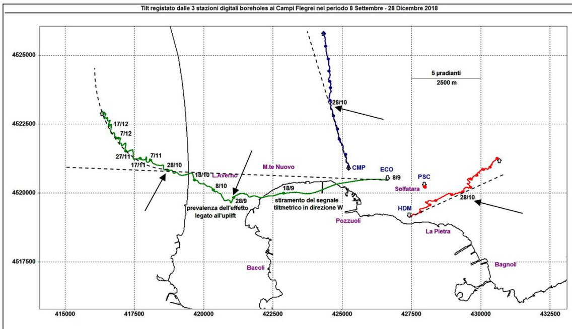
**Figura 2.11** - Pattern tiltmetrico ai Campi Flegrei dal 8 settembre. Il lato di ogni maglia del reticolo equivale a 5  $\mu$ radianti o 2.5Km. I pallini in colore sono sovrapposti sui vettori tilt ogni 10 giorni. Le 4 freccette nere sovrapposte indicano altrettante modifiche delle direzioni di tilting, ulteriormente evidenziate dalle linee tratteggiate.
