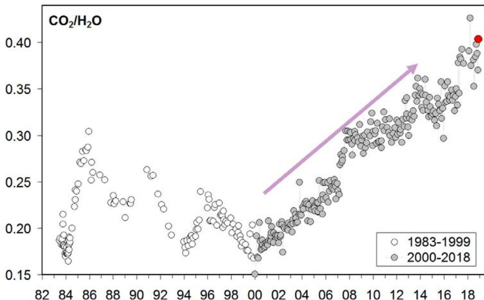
**Figura 4.1** - Cronogramma del rapporto  $CO_2/H_2O$  per la fumarola BG. In grigio sono riportati i dati a partire dal 2000, quando è iniziato un trend d'aumento del rapporto  $CO_2/H_2O$ , in generale, indicativo di una crescente frazione della componente magmatica nei fluidi fumarolici. Con il simbolo rosso è evidenziato il campione di dicembre 2018.
