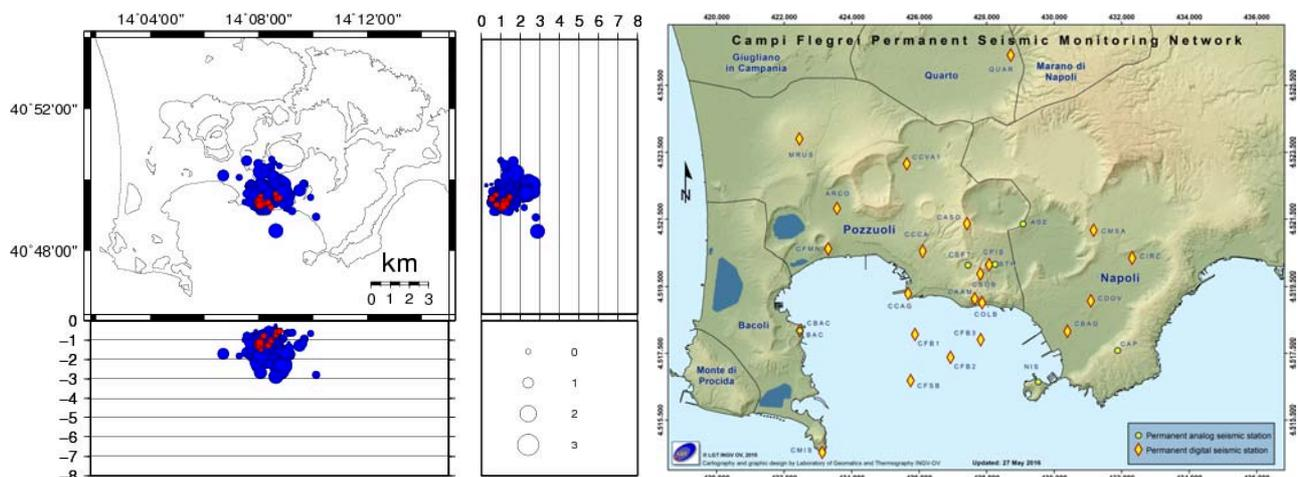
**Figura 1.2** - Localizzazioni ipocentrali ai Campi Flegrei nel corso degli ultimi 12 mesi (in blu) e dell'ultimo mese (in rosso). La dimensione dei simboli è proporzionale alla magnitudo, come indicato nel riquadro in basso. A destra è mostrata la mappa con la Rete Sismica Permanente dei Campi Flegrei.
