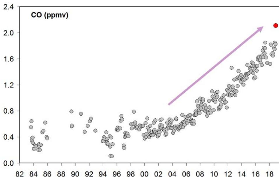
**Figura 4.2** – Variazioni della concentrazione di monossido di carbonio (CO) misurato alla fumarola BG a partire dal 1983. Con il simbolo rosso è evidenziato il campione di novembre 2018. In generale alti contenuti di CO caratterizzano sistemi vulcanici ad elevata temperatura mentre fumarole alimentate da sistemi idrotermali mostrano concentrazioni più basse, in tali sistemi un aumento delle concentrazioni di CO può riflettere un incremento delle condizioni di pressione e temperatura.
