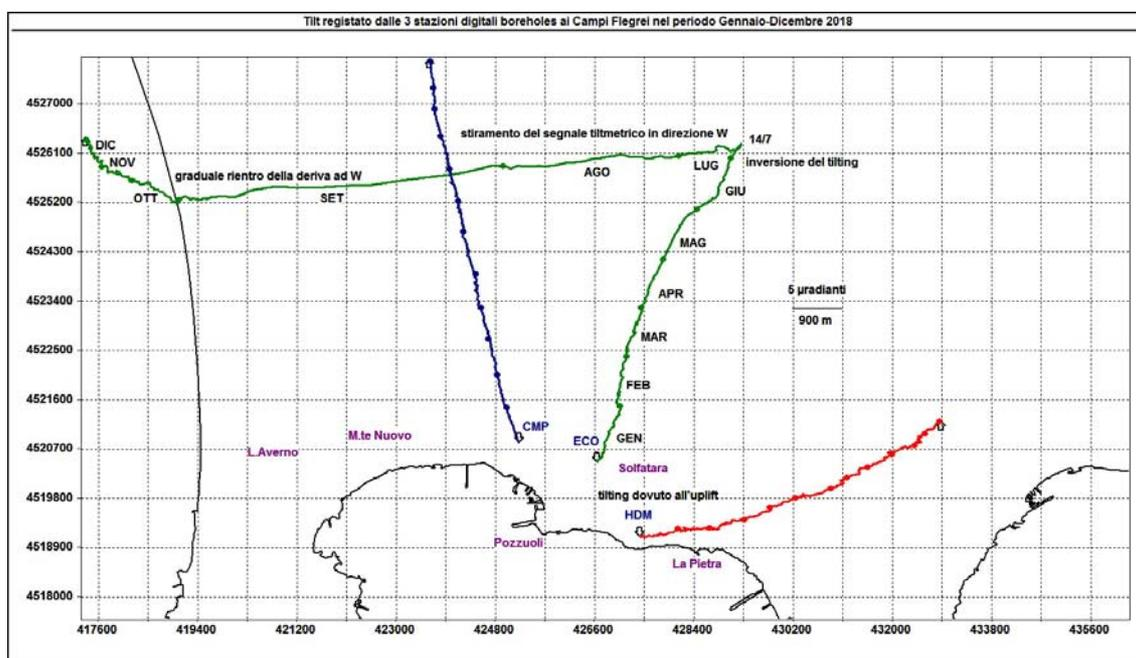
**Figura 2.9** - Pattern tiltmetrico osservato ai Campi Flegrei nel periodo gennaio-dicembre 2018. Per chiarezza di rappresentazione grafica sono state selezionate solo le stazioni borehole con sensori ubicati a 25 m di profondità. Il lato di ogni maglia del reticolo equivale a 5  $\mu$ radianti o 900 m. I pallini sovrapposti sui vettori tilt indicano l'inizio di ogni mese.
