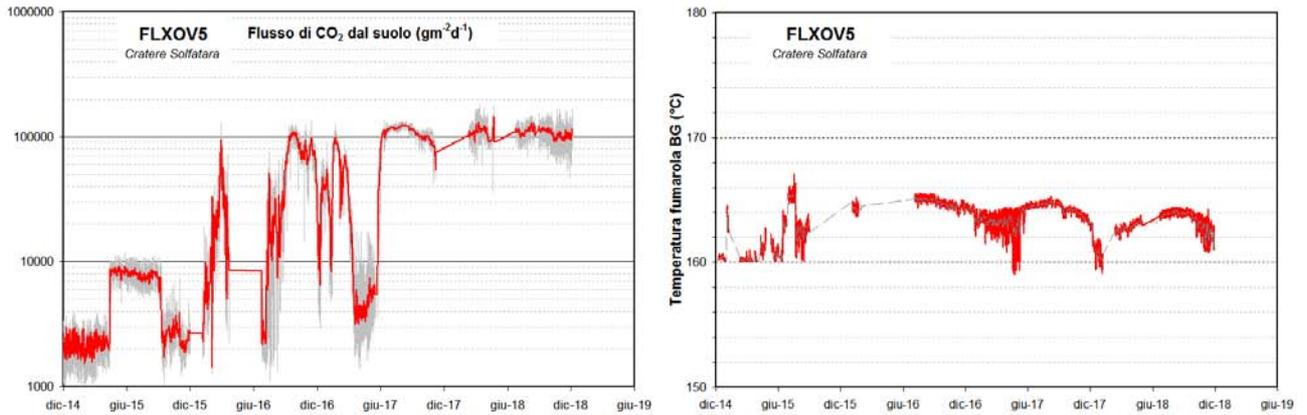
**Figura 4.9** - Valori del flusso di CO<sub>2</sub> dal suolo e della temperatura della fumarola BG misurati dalla stazione FLXOV5 installata nel cratere della Solfatara a pochi metri dalla fumarola principale BG. I valori di flusso di CO<sub>2</sub> dal suolo mostrano, in generale, un significativo incremento a partire dal 2015 (la linea rossa si riferisce alle medie giornaliere).
