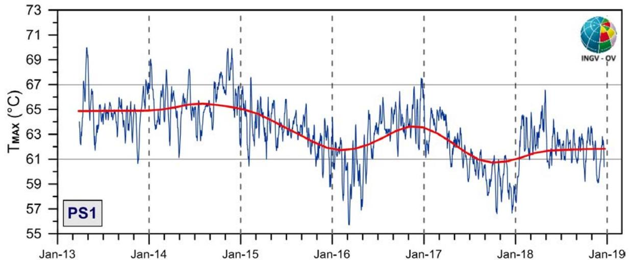
**Figura 3.3** - Stazione PS1. Serie temporali delle medie settimanali (blu) e del trend a lungo termine (rosso) dei valori di temperatura massima rilevati nell'immagine IR destagionalizzata mediante applicazione dell' algoritmo STL.
