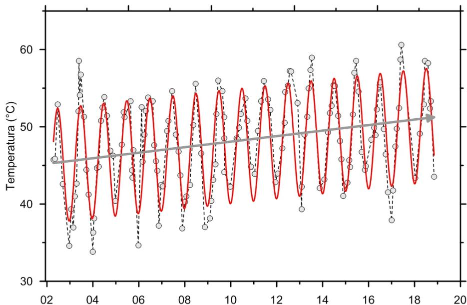
**Figura 4.7** - Cronogramma della media delle temperature del suolo (a 10 cm di profondità) misurate su 61 punti fissi nell'area craterica della Solfatara. Va evidenziato l'incremento del valore medio nel periodo 2002-2018 di oltre 5 °C.
