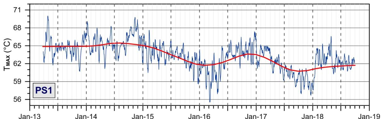
**Figura 3.3** - Stazione PS1. Serie temporali delle medie settimanali (blu) e del trend a lungo termine (rosso) dei valori di temperatura massima rilevati nell'immagine IR destagionalizzata mediante applicazione dell'algoritmo STL.
