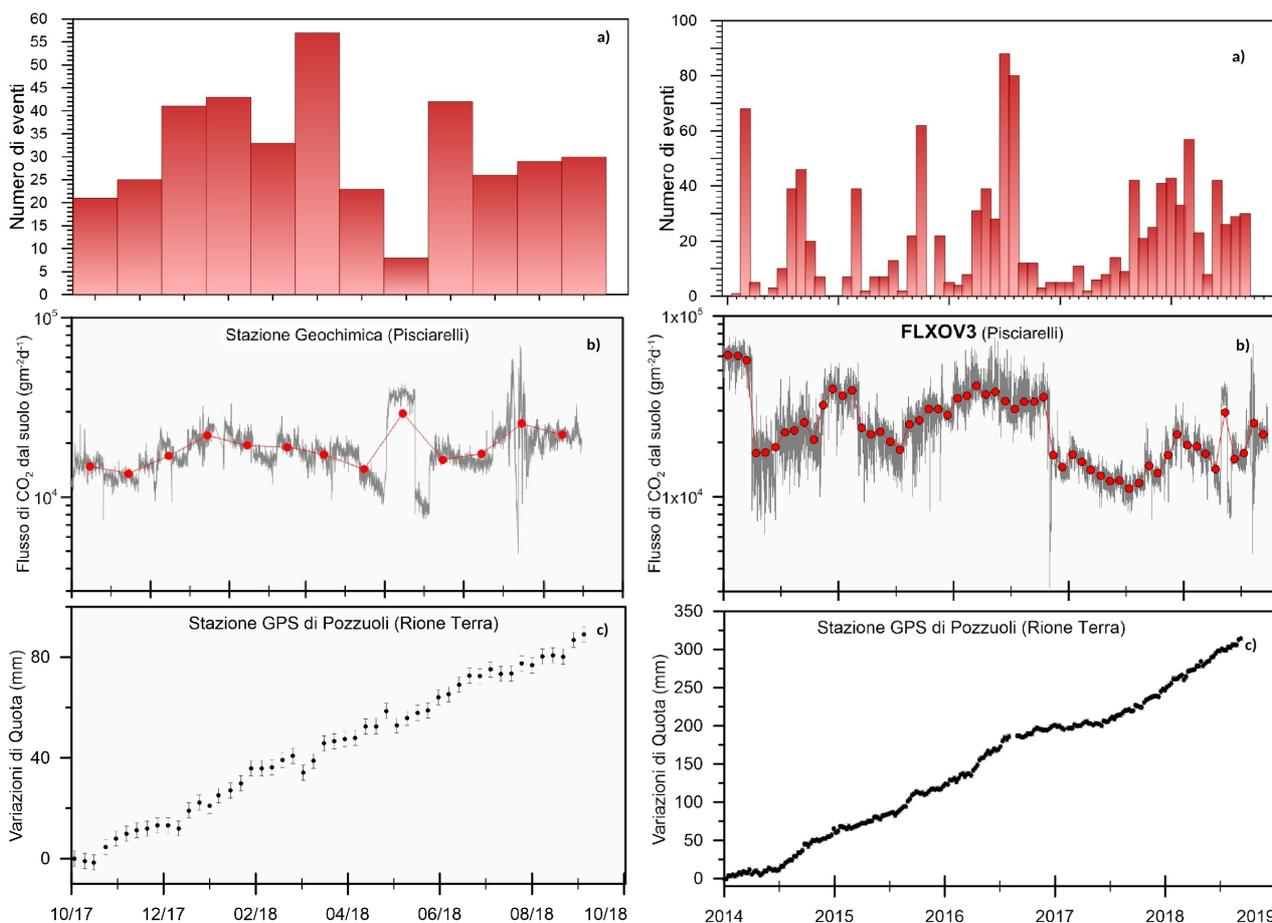
**Figura 5.1** – Frequenza di accadimento degli eventi sismici (a), variazioni del flusso di CO<sub>2</sub> alla stazione FLXOV3 di Pisciarelli (b) e andamento delle deformazioni del suolo alla stazione GPS di RITE negli ultimi dodici mesi (a sinistra) e dal 2014 (a destra).
