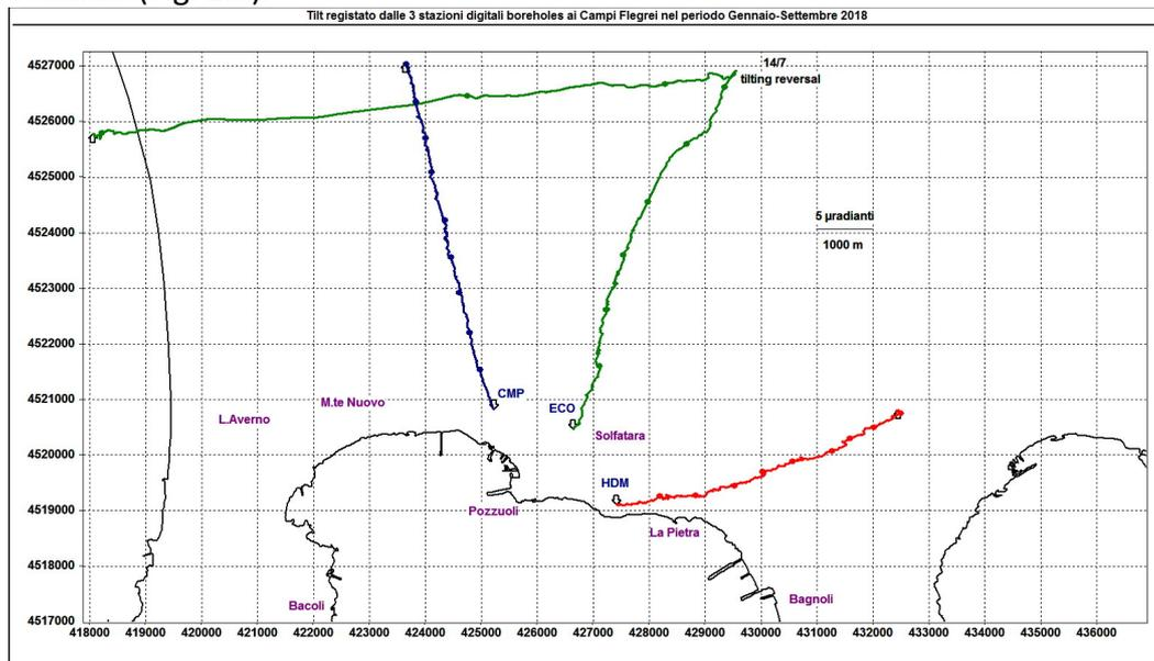
**Figura 2.9** - Pattern tiltmetrico osservato ai Campi Flegrei nel periodo gennaio-settembre 2018. Per chiarezza di rappresentazione grafica sono state selezionate solo le stazioni borehole con sensori ubicati a 25 m di profondità. Il lato di ogni maglia del reticolo equivale a 5  $\mu$ radianti o 1000 m. I pallini sovrapposti sui vettori tilt indicano l’inizio di ogni mese.
