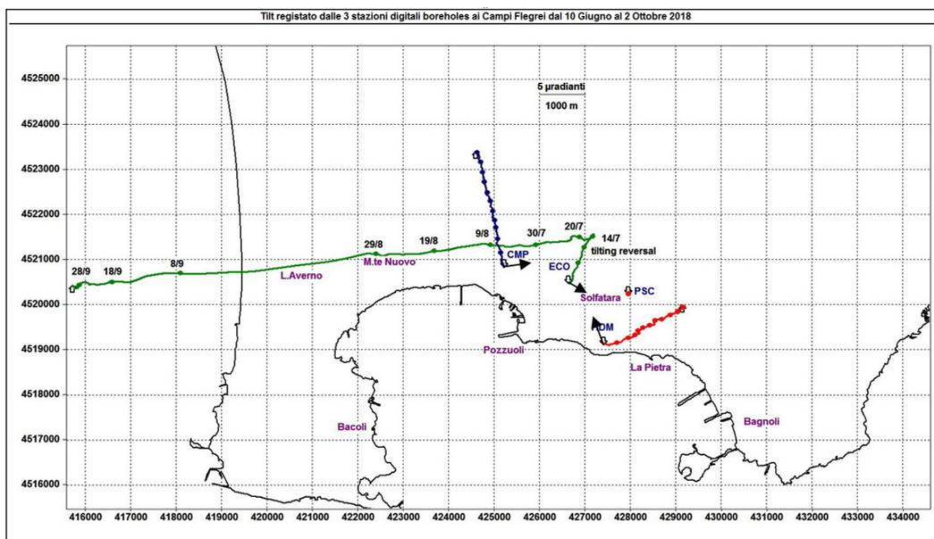
**Figura 2.11** - Pattern tiltmetrico ai Campi Flegrei dal 10 Giugno. Il lato di ogni maglia del reticolo equivale a 5  $\mu$ radianti o 1Km. I pallini in colore sono sovrapposti sui vettori tilt ogni 10 giorni. Le frecce in nero indicano la direzione in cui si è avuto un abbassamento del suolo contemporaneo all'evento sismico flegreo del 18 Settembre (la lunghezza delle frecce è uguale per tutte e non è indicativa dell'ampiezza del tilt che è dell'ordine del decimo di  $\mu$ radiante).
