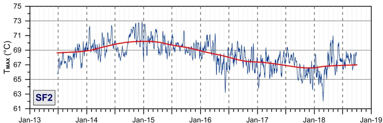
**Figura 3.2** - Stazione SF2. Serie temporali delle medie settimanali (blu) e del trend a lungo termine (rosso) dei valori di temperatura massima rilevati nell'immagine IR destagionalizzata mediante applicazione dell'algoritmo STL.
