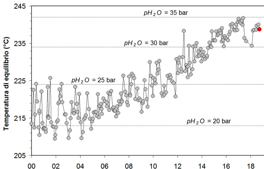
**Figura 4.3** – Cronogramma delle temperature di equilibrio per il sistema  $CO-CO_2$ , stimate assumendo condizioni redox fissate dalla relazione di D'Amore and Panichi (1980). Tali temperature, rappresentative della parte più superficiale del sistema idrotermale (Caliro et al., 2007), mostrano un trend d'aumento a partire dai primi anni del 2000. Con il simbolo rosso è evidenziato il campione di settembre 2018 relativo alla fumarola BG.
