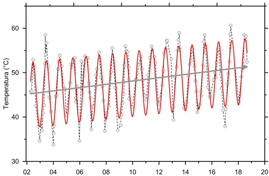
**Figura 4.7** – Cronogramma della media delle temperature del suolo (a 10 cm di profondità) misurate su 61 punti fissi nell'area craterica della Solfatara. Va evidenziato l'incremento del valore medio nel periodo 2002-2018 di oltre 5 °C.
