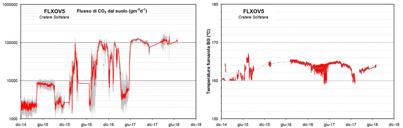
**Figura 4.11** - Valori del flusso di CO<sub>2</sub> dal suolo e della temperatura della fumarola BG misurati dalla stazione FLXOV5 installata nel cratere della Solfatara a pochi metri dalla fumarola principale BG. I valori di flusso di CO<sub>2</sub> dal suolo mostrano, in generale, un significativo incremento a partire dal 2015 (la linea rossa si riferisce alle medie giornaliere).
