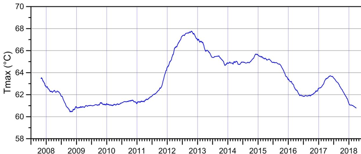
**Figura 3.4** - Stazione PS1: Stazione Pisciarelli. Cronogramma delle temperature massime (°C) destagionalizzate con filtro di media mobile di ampiezza 365 campioni.
