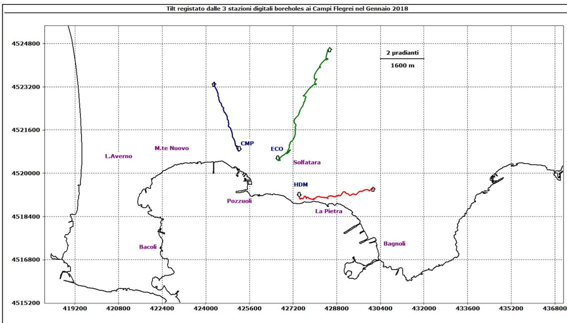
**Figura 2.8** - Pattern tiltmetrico osservato ai Campi Flegrei nel gennaio 2018. Per chiarezza di rappresentazione grafica sono state selezionate solo le stazioni borehole con sensori ubicati a 25 m di profondità. Il lato di ogni maglia del reticolo equivale a 2  $\mu$ radianti o 1600 m.
