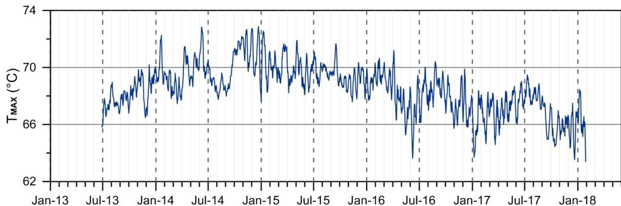
**Figura 3.3** - Stazione SF2. Serie temporale delle medie settimanali dei valori di temperatura massima rilevati nell'immagine IR destagionalizzata mediante applicazione dell'algoritmo di filtraggio analitico STL (Seasonal-Trend Decomposition).
