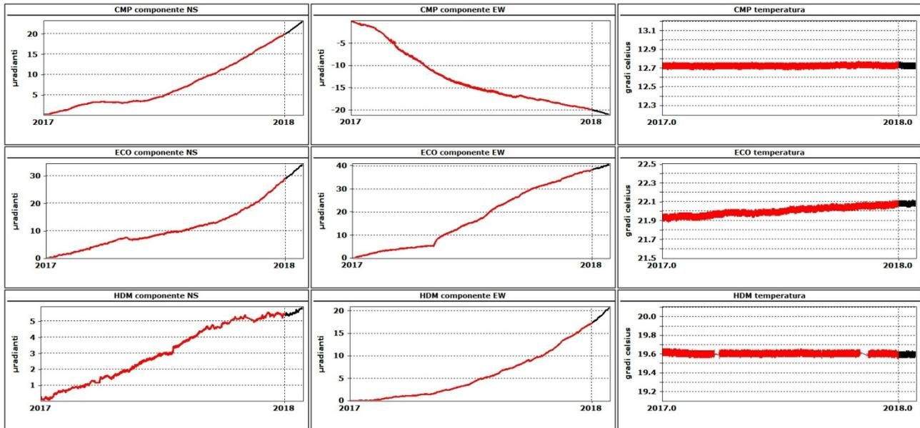
**Figura 2.9** – Serie temporali dei segnali registrati a partire dal 2017 dalle 3 stazioni “borehole” della rete flegrea, con sensori ubicati a 25 m di profondità, ordinate dal basso verso l’alto secondo la latitudine. Le prime 2 colonne riportano le componenti NS ed EW in  $\mu$ radianti i cui valori di tilt crescenti nel tempo indicano rispettivamente la variazione di inclinazione del suolo a N e ad E, mentre la terza colonna riporta la temperatura in  $^{\circ}$ C registrata da ogni sensore.
