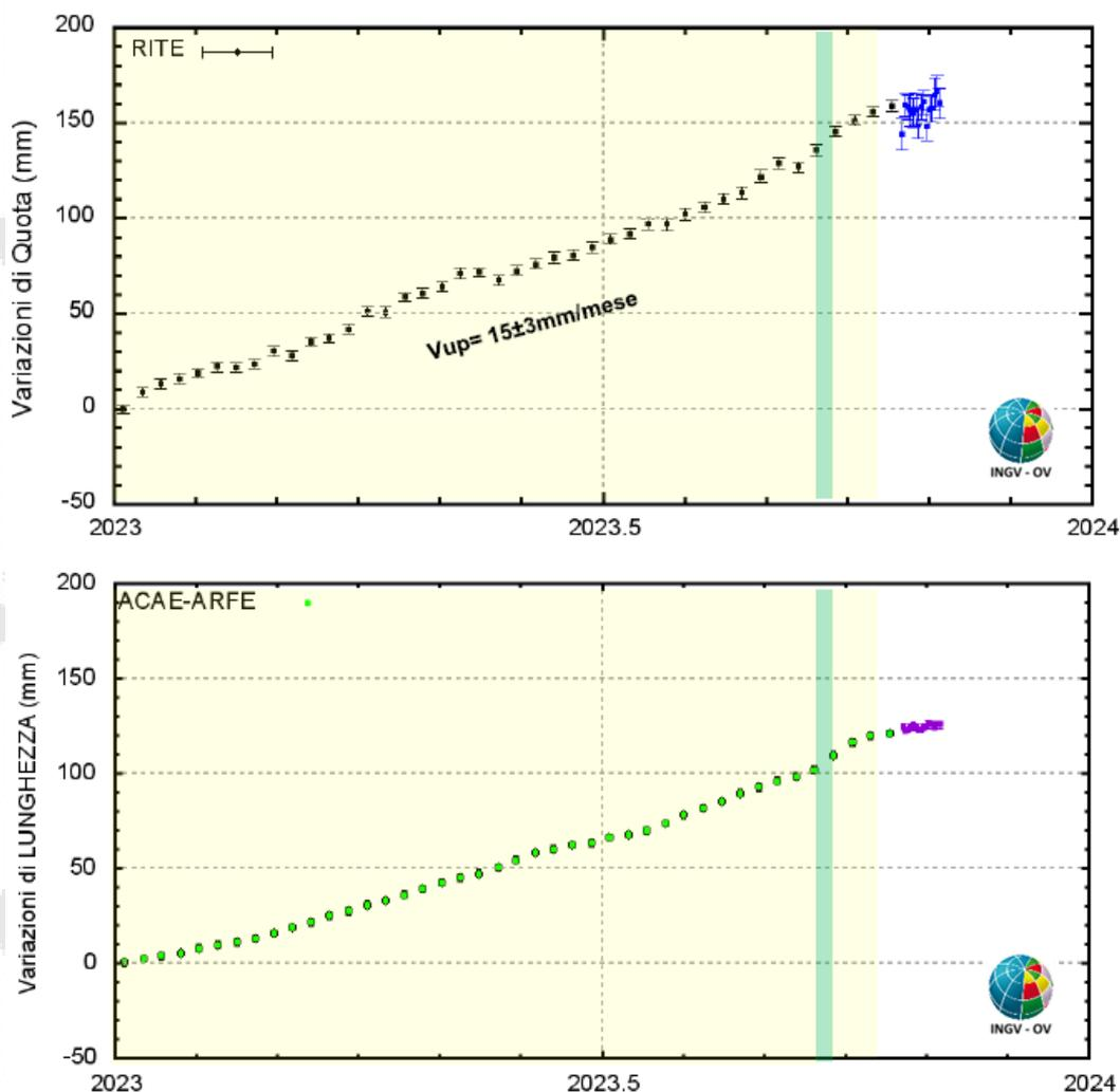
**Figura 4.2** - Serie temporale delle variazioni in quota della stazione GNSS di RITE (in alto) e delle variazioni in lunghezza della baseline ACAE-ARFE (in basso) dal 01/01/2023 al 05/11/2023
