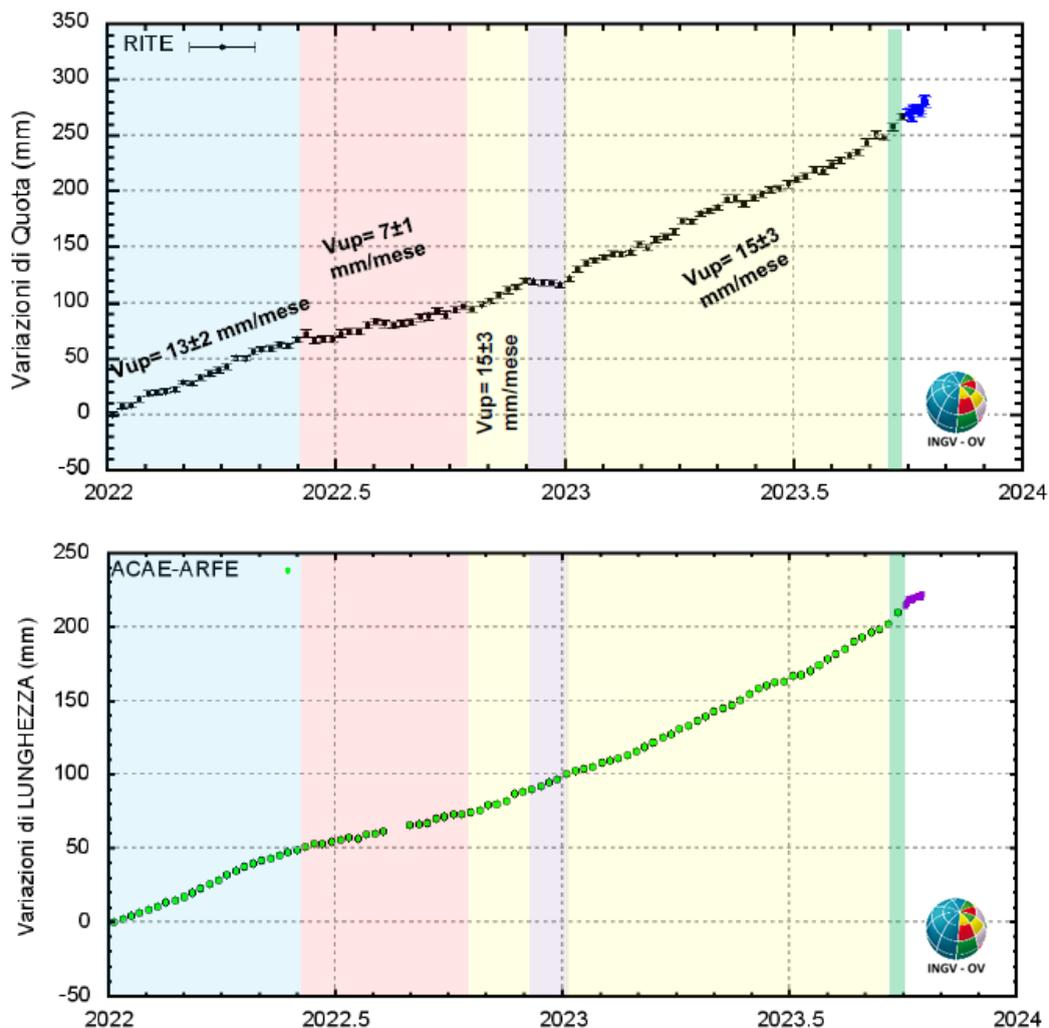
**Figura 4.2** - Serie temporale delle variazioni in quota della stazione GNSS di RITE (in alto) e delle variazioni in lunghezza della baseline ACAE-ARFE (in basso) dal 01/01/2022 al 16/10/2023
