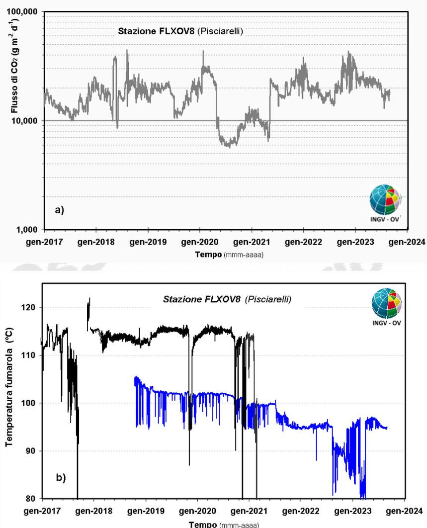
**Figura 5.1** - (a) Valori del flusso di CO<sub>2</sub> dal suolo (medie giornaliere); (b) dettaglio della temperatura dell'emissione fumarolica misurata in area Pisciarelli in due siti adiacenti (in blu è riportata la temperatura misurata dal 2018, a 5 m dall'emissione principale, non più accessibile in quanto inglobata nell'area della polla).
