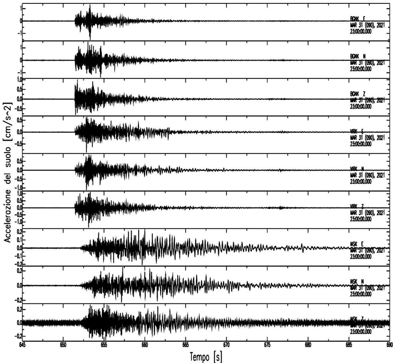
**Figura 1.2.3** - Accelerogrammi delle stazioni BGNK, VIRK e IASK per il terremoto di  $M_d = 2.2$  del 31/03/2021 alle ore 23:10 UTC avvenuto nell'area dei Campi Flegrei.
