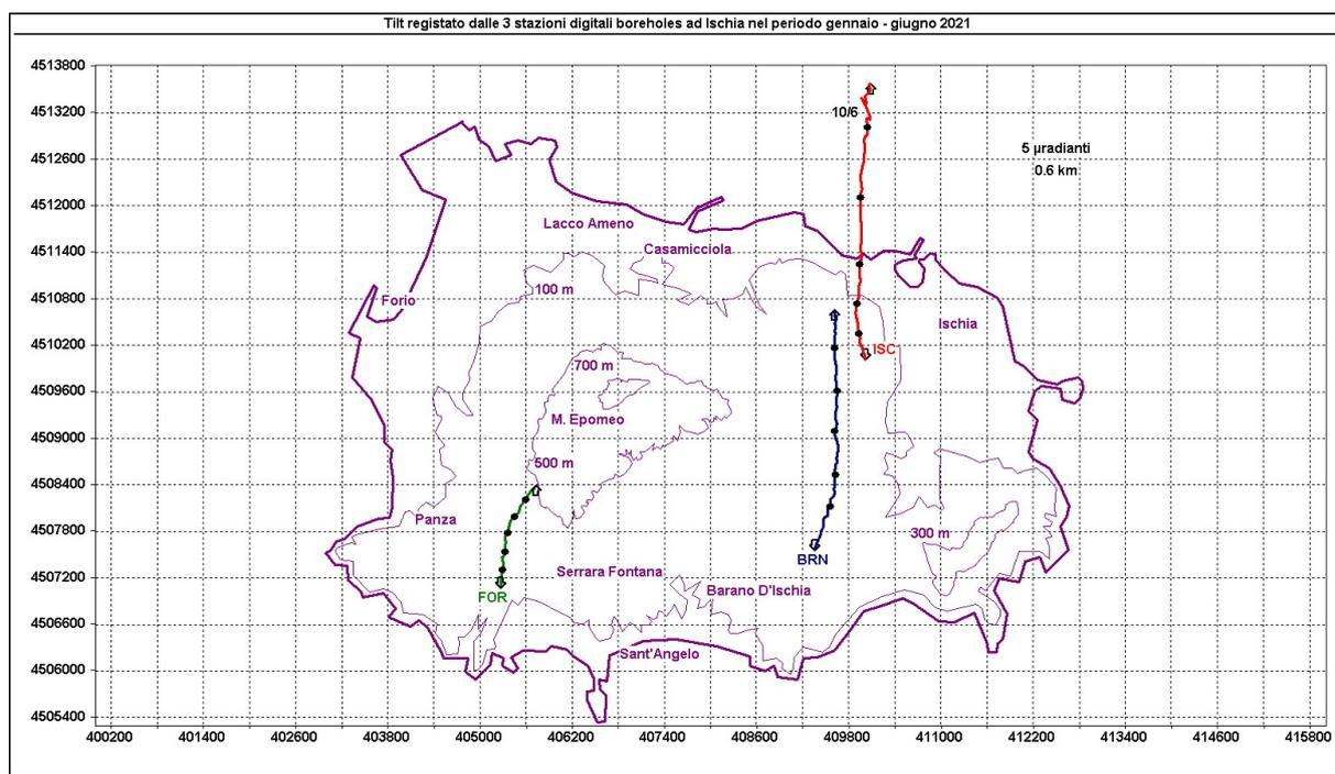
**Figura 2.2.2** – Pattern tiltmetrico osservato ad Ischia. Il lato di ogni maglia del reticolo equivale a 5  $\mu$ radianti o 0.6 km ed i pallini in colore sovrapposti sui vettori tilt indicano intervalli di un mese.
