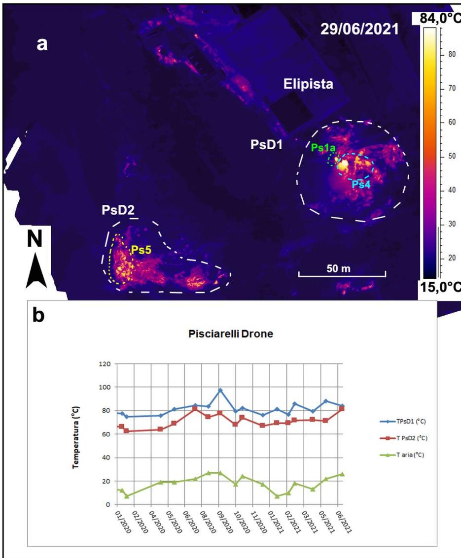
**Figura 3.2.3** - Fotocomposizione di immagini termiche rilevate da drone nel mese di giugno 2021 (a) e valori massimi di temperatura (T) delle aree a maggiore anomalia termica (PsD1 e PsD2), confrontati con la temperatura dell'aria misurata nel momento del rilievo termico, da gennaio 2020 a giugno 2021 (b).
