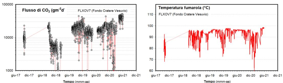
**Figura 4.1.6** - Parametri misurati dalla stazione geochimica (FLXOV7) installata in area di fondo cratere del Vesuvio. I valori, eccetto il flusso di CO<sub>2</sub> dal suolo, sono riportati come medie giornaliere.
