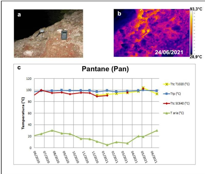
**Figura 3.5** – Fumarola in località Pantane a Ischia. Immagini nel visibile (a) e termica (b) riprese dal punto di misura Pan di Fig. 3.1a. Valori massimi di temperatura con termocamera FLIR SC640 (TtcSC640), valori massimi di temperatura con termocamera FLIR T1020 (TtcT1020) e valori di temperatura dalla termocoppia (Ttp), confrontati con la temperatura dell’aria (Taria) misurata nel momento del rilievo termico, da giugno 2020 a giugno 2021 (c).
