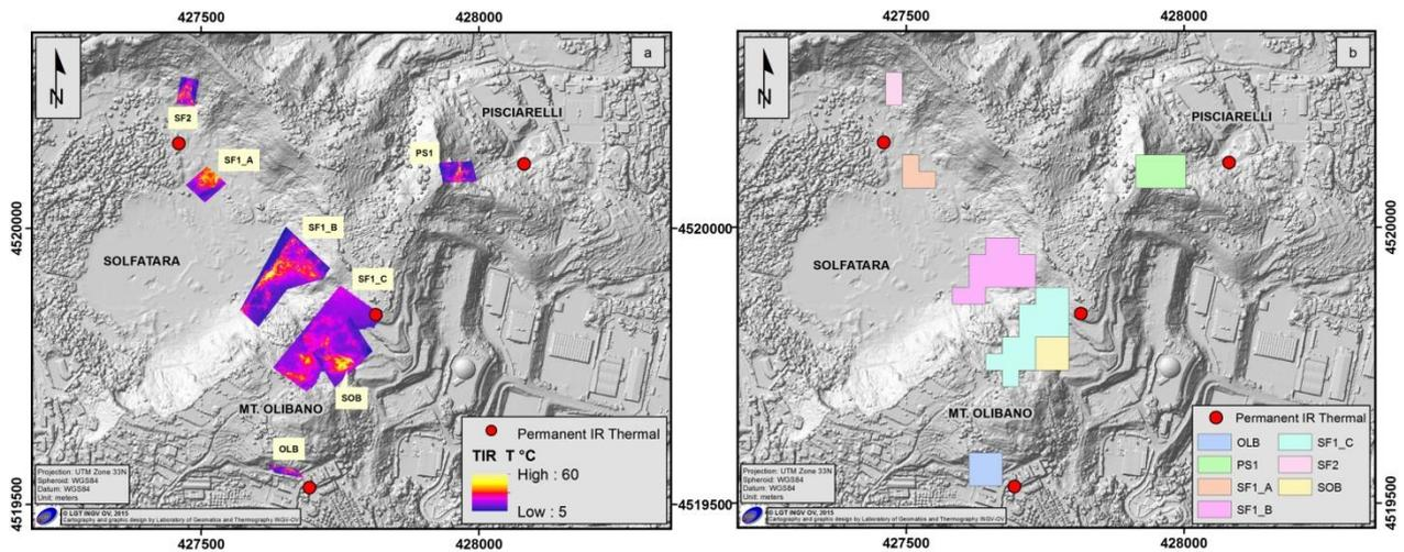
Figura 3.3.2 - Immagini termiche georiferite del 29/03/2021 (a) e aree di analisi (b).
