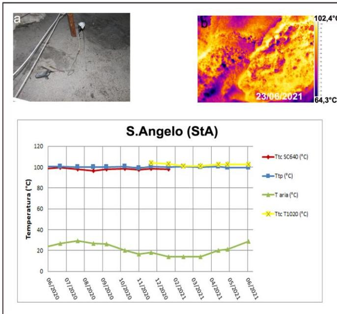
**Figura 3.3** – Fumarola in località S. Angelo a Ischia. Immagini nel visibile (a) e termica (b) riprese dal punto stazione StA di Figura 3.1e. Valori massimi di temperatura con termocamera FLIR SC640 (TtcSC640), valori massimi di temperatura con termocamera FLIR T1020 (TtcT1020) e valori di temperatura dalla termocoppia (Ttp), confrontati con la temperatura dell’aria (Taria) misurata nel momento del rilievo termico, da giugno 2020 a giugno 2021 (c).
