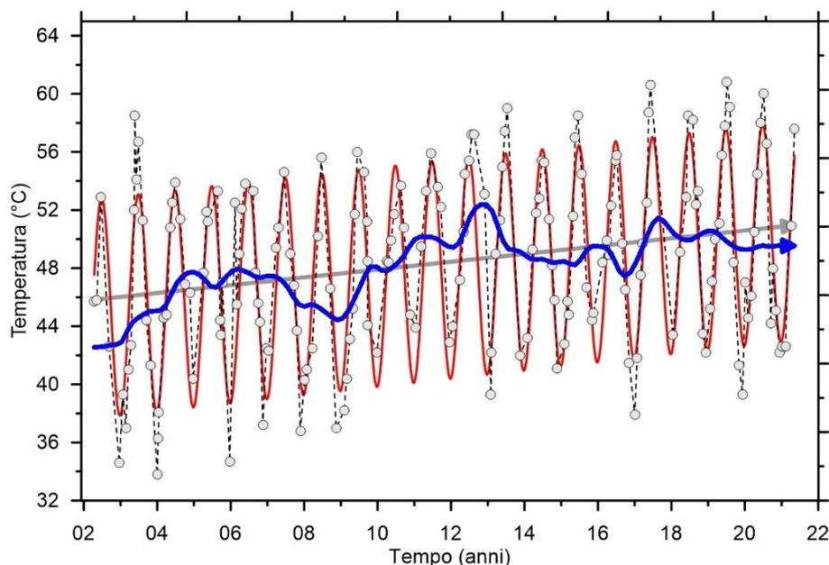
**Figura 4.3** - Cronogramma della media delle temperature del suolo (a 10 cm di profondità) misurate su circa 60 punti fissi nell'area craterica della Solfatara. Va evidenziato l'incremento del valore medio nel periodo 2002-2021 di oltre 6 °C. Il trend depurato dalla componente stagionale, mediante l'utilizzo dell'algoritmo di destagionalizzazione STL (Seasonal-Trend decomposition based on Loess, Cleveland et al., 1990), è riportato con la linea blu.
