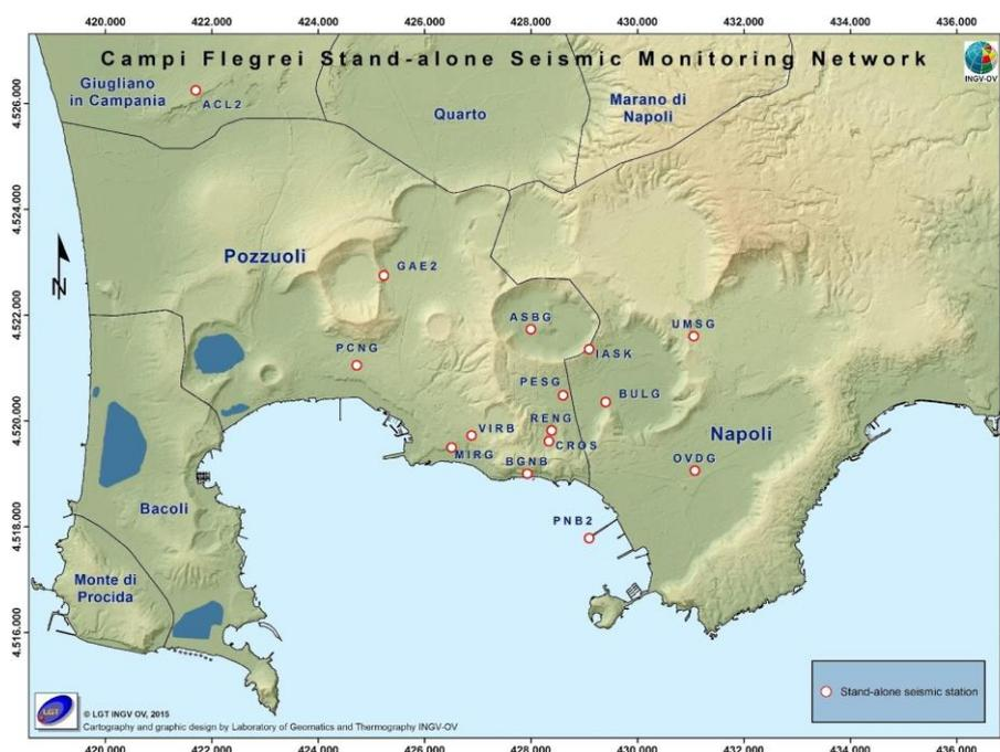
**Figura 1.2.1** – Rete Sismica Mobile operativa ai Campi Flegrei. Mappa aggiornata a giugno 2021. La stazione CROS acquisisce i segnali localmente oltre a trasmettere i segnali in tempo reale verso la sala di monitoraggio.
