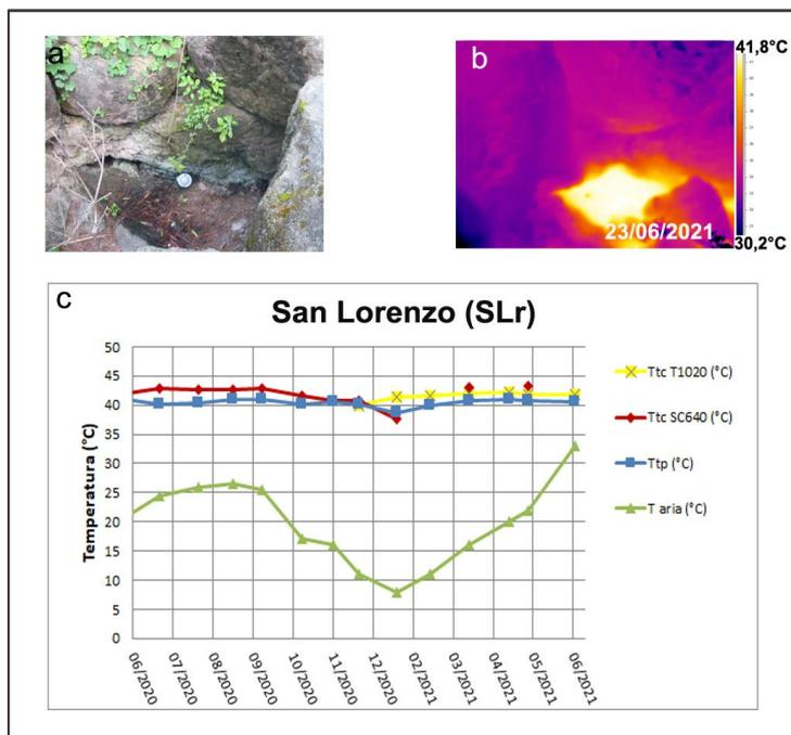
**Figura 3.7** – Fumarola in località S. Lorenzo a Ischia. Immagini nel visibile (a) e termica (b) riprese dal punto di stazione SLr di Fig. 3.1b. Valori massimi di temperatura con termocamera FLIR SC640 (TtcSC640), valori massimi di temperatura con termocamera FLIR T1020 (TtcT1020) e valori di temperatura dalla termocoppia (Ttp), confrontati con la temperatura dell'aria (Taria) misurata nel momento del rilievo termico, da giugno 2020 a giugno 2021 (c).
