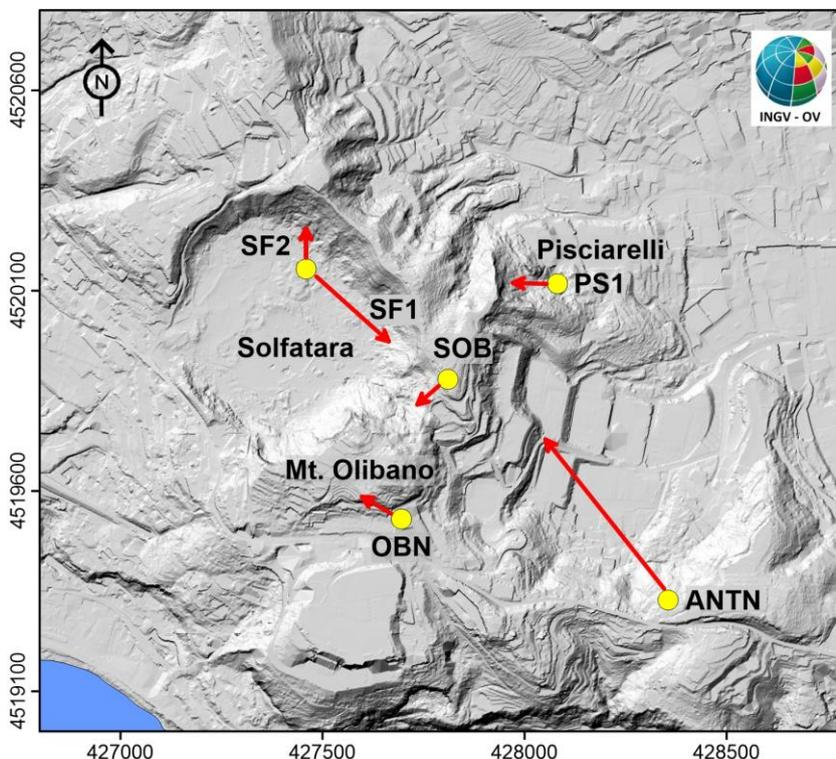
**Figura 3.1.1** – Mappa della Rete Permanente di Monitoraggio Termico ad Immagine operante ai Campi Flegrei. Ubicazione stazioni remote (punti gialli), le frecce indicano schematicamente le aree target.
