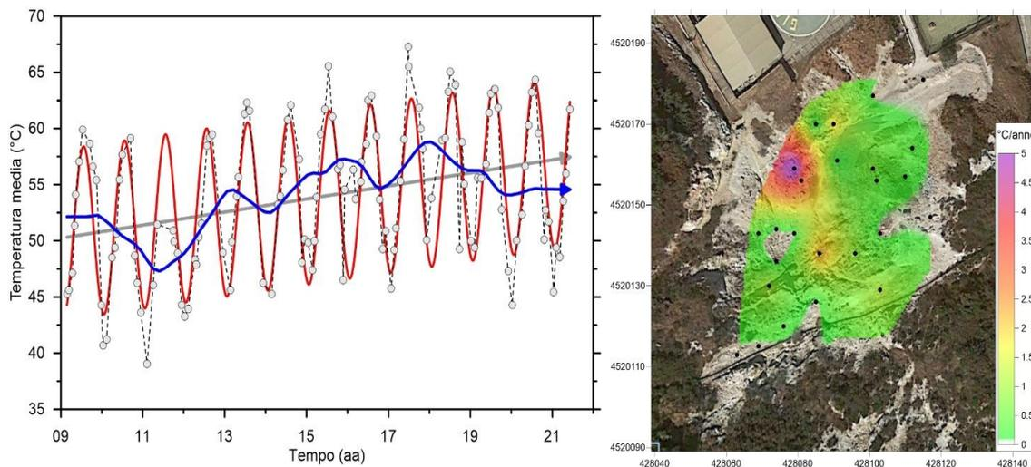
**Figura 4.5** - Cronogramma della media delle temperature del suolo (a 10 cm di profondità) misurate su 25 punti fissi nell'area di Pisciarelli dal 2009. Il trend destagionalizzato, mediante l'utilizzo dell'algorithm di destagionalizzazione STL (Seasonal-Trend decomposition based on Loess, Cleveland et al., 1990), è riportato con la linea blu.
