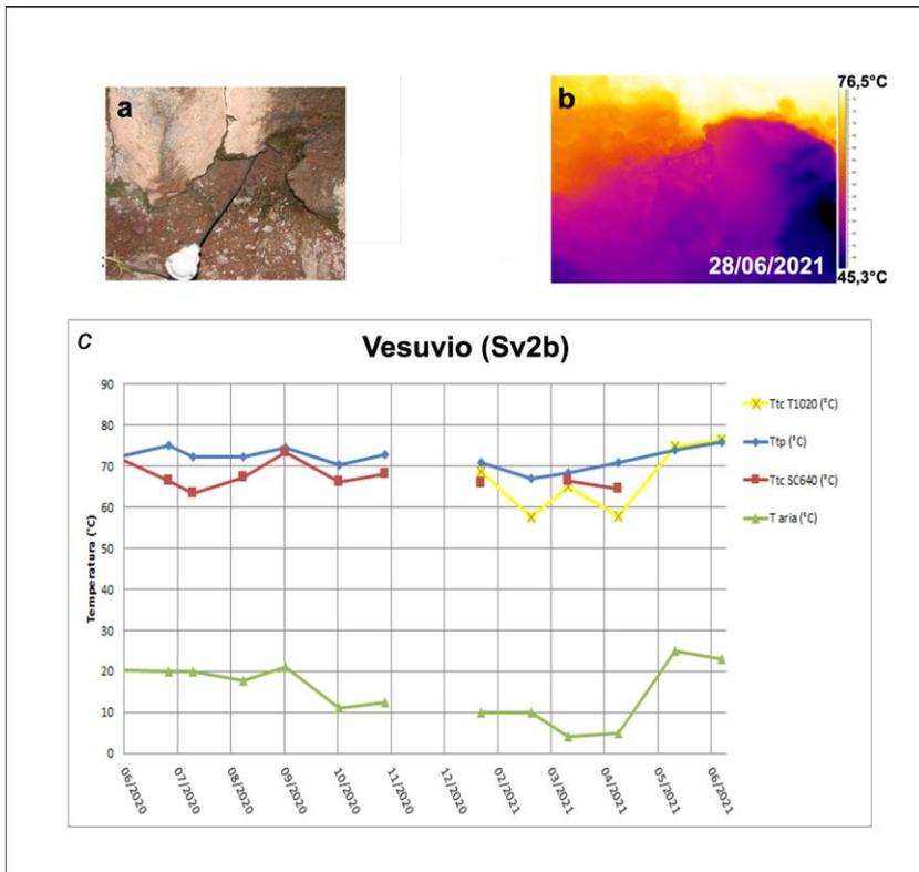
**Figura 3.2.4** – Immagini nel visibile (a) e termica (b) riprese al punto SV2b di Figura 3.2.1, di una fumarola ubicata sul settore occidentale del cratere del Vesuvio. Valori massimi di temperatura con termocamera FLIR SC640 (TtcSC640), valori massimi di temperatura con termocamera FLIR T1020 (TtcT1020) e valori di temperatura dalla termocoppia (Ttp), confrontati con la temperatura dell'aria (Taria) misurata nel momento del rilievo termico, da giugno 2020 a giugno 2021 (c).
