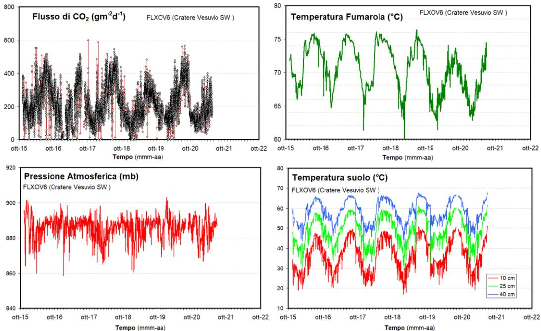
**Figura 4.1.5** - Serie temporali di alcuni parametri misurati dalla stazione geochimica FLXOV6 installata in area bordo cratere del Vesuvio (settore SW). I valori, eccetto il flusso di CO<sub>2</sub> dal suolo, sono riportati come medie giornaliere.
