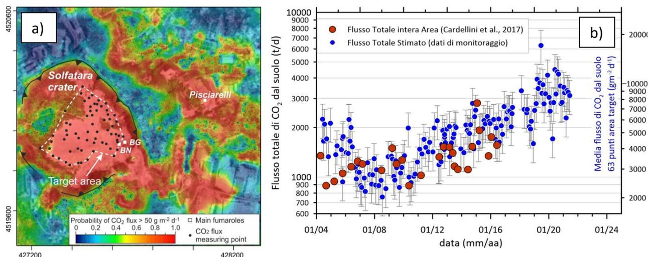
**Figura 4.2** - a) Mappa dell'area di degassamento diffuso della Solfatara-Pisciarelli (Cardellini et al., 2017), con l'ubicazione dell'area target; b) Cronogramma dei flussi di CO<sub>2</sub>, i punti blu si riferiscono all'emissione dall'area target scalati sull'intera DDS, ottenuta dal confronto con i dati delle 30 campagne estese (simboli rossi) in Cardellini et al. (2017).
