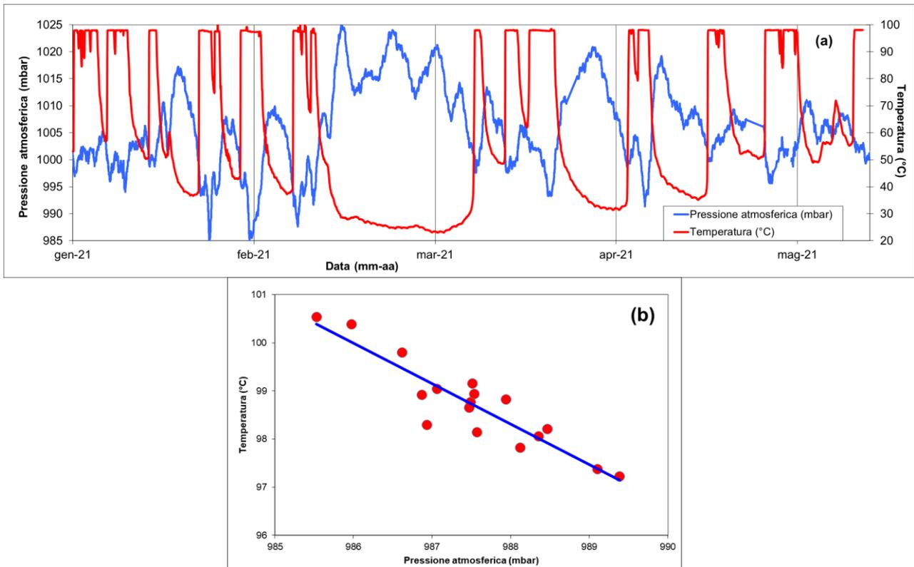
**Figura 4.2.3** - a) Valori di temperatura dell'emissione fumarolica di Mt.Cito (Pizzone) e della pressione atmosferica misurati in continuo. La buona correlazione inversa dei due parametri è osservabile nel diagramma (b).
