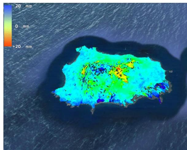
**Figura 2.3.1b** - Mappa di deformazione in LOS, coppia 03.01.2021-20.06.2021 orbita discendente, track 22, B.L -49,3m. L’esportazione dell’immagine in formato .kml su piattaforma Google Earth è stata effettuata per mezzo di un tool di ENVI®.
