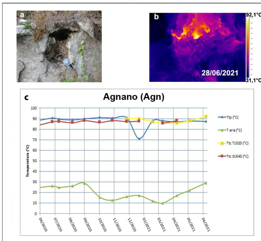
**Figura 3.2.5** - Fumarola all'interno dello stabilimento termale delle “Terme di Agnano”. Immagini nel visibile (a) e termica (b) riprese dal punto stazione Agn di figura 1.1c. Valori massimi di temperatura con termocamera FLIR SC640 (TtcSC640), valori massimi di temperatura con termocamera FLIR T1020 (TtcT1020) e valori di temperatura dalla termocoppia (Ttp), confrontati con la temperatura dell'aria (Taria) misurata nel momento del rilievo termico, da giugno 2020 a giugno 2021 (c).
