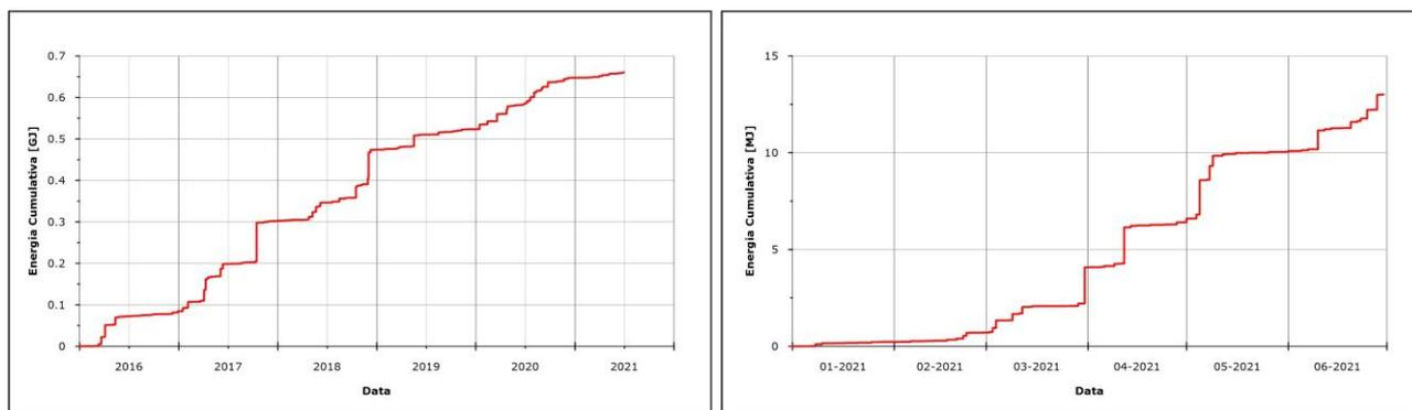
**Figura 1.1.8** – Andamento cumulativo dell'energia rilasciata dai terremoti vesuviani nel corso degli ultimi 5 anni (a sinistra) e del primo semestre 2021 (a destra) calcolato attraverso la relazione di Gutenberg-Richter  $\log E = 2.4 + 2.14 M - 0.054 M^2$ .
