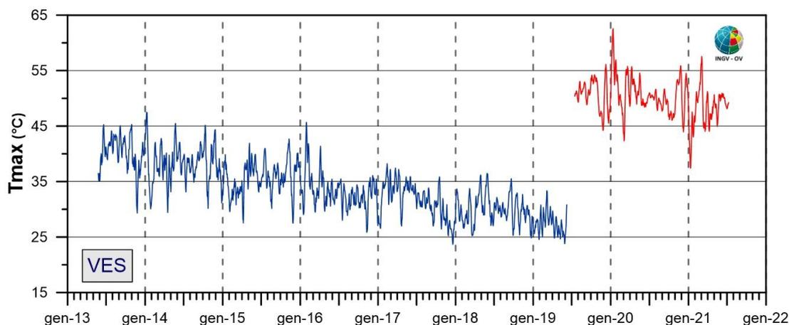
**Figura 3.1.2** - Stazione Vesuvio (VES). Serie temporali dei valori di temperatura massima giornaliera rilevata nelle immagini IR destagionalizzate mediante applicazione dell'algoritmo STL [medie settimanali termocamera 320x240 (blu); medie settimanali termocamera 640x480 (rosso)].
