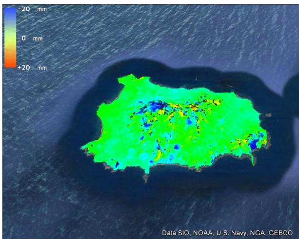
**Figura 2.3.1a** - Mappa di deformazione in LOS, coppia 03.01.2021-20.06.2021, orbita ascendente, track 177, B.L -45,4m. L’esportazione dell’immagine in formato .kml su piattaforma Google Earth è stata effettuata per mezzo di un tool di ENVI®.
