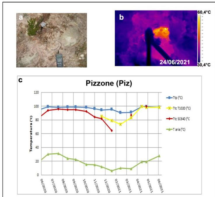
**Figura 3.6** – Fumarola in località Pizzone a Ischia. Immagini nel visibile (a) e termica (b) riprese dal punto stazione Piz di Fig. 3.1h. Valori massimi di temperatura con termocamera FLIR SC640 (TtcSC640), valori massimi di temperatura con termocamera FLIR T1020 (TtcT1020) e valori di temperatura dalla termocoppia (Ttp), confrontati con la temperatura dell’aria (Taria) misurata nel momento del rilievo termico, da giugno 2020 a giugno 2021 (c).
