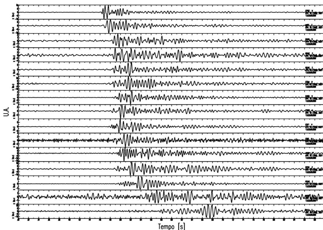
**Figura 1.3.2** - Evento LP registrato dall'intera Rete di Monitoraggio il giorno 18 aprile 2021 (ore 03:32 UTC). Le forme d'onda mostrate nel grafico (durata del segnale di 60 s, comp. Z) sono filtrate nella banda 1-4 Hz.
