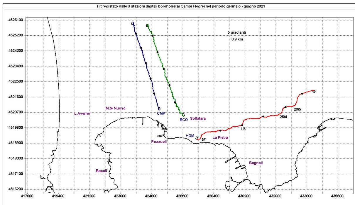
**Figura 2.2.2** – Pattern tiltmetrico osservato ai Campi Flegrei nel 2021. Per comodità di rappresentazione grafica e per una interpretazione più agevole, sono riportate solo le 3 stazioni “borehole” con sensori ubicati a 25 m di profondità. Il lato di ogni maglia del reticolo equivale a 5  $\mu$ radianti o 0.9 km ed i pallini in nero sovrapposti sui vettori tilt indicano intervalli di un mese.
