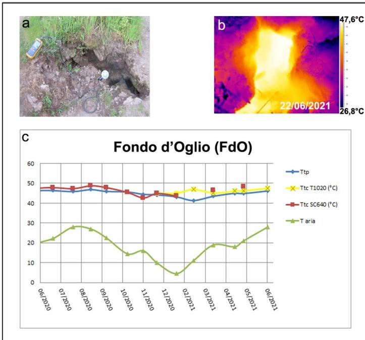
**Figura 3.9** – Fumarola in località Fondo d'Oglio a Ischia. Immagini nel visibile (a) e termica (b) riprese dal punto stazione FdO di Fig. 3.1i. Valori massimi di temperatura con termocamera FLIR SC640 (TtcSC640), valori massimi di temperatura con termocamera FLIR T1020 (TtcT1020) e valori di temperatura dalla termocoppia (Ttp), confrontati con la temperatura dell'aria (Taria) misurata nel momento del rilievo termico, da giugno 2020 a giugno 2021 (c).
