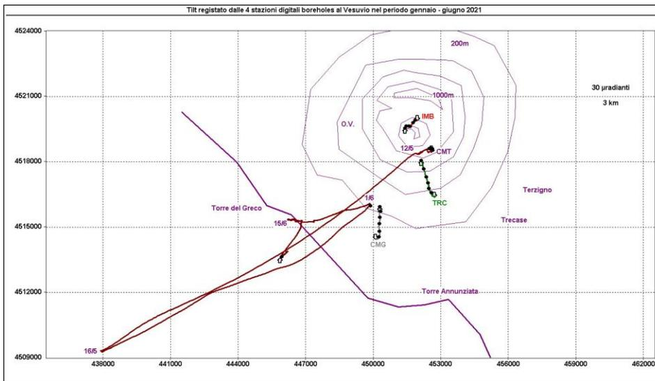
**Figura 2.2.2** - Pattern tiltmetrico osservato al Vesuvio. Per comodità di rappresentazione grafica e per una interpretazione più agevole, sono state selezionate in tale figura solo le 4 stazioni "borehole" con sensori ubicati a 25 m di profondità. Il lato di ogni maglia del reticolo equivale a 30  $\mu$ radianti o 3 km. I pallini in colore sovrapposti sui vettori tilt indicano intervalli di un mese.
