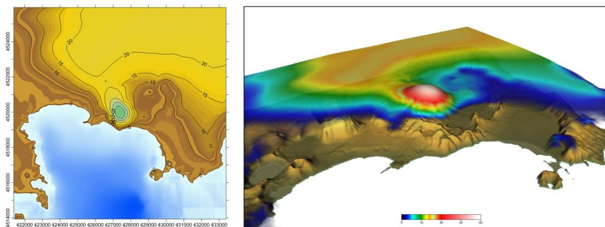
**Figura 4.17** - Ricostruzione della superficie di falda nell'area flegrea. Si noti l'alto morfologico della superficie piezometrica nell'area Solfatara-Pisciarelli.
