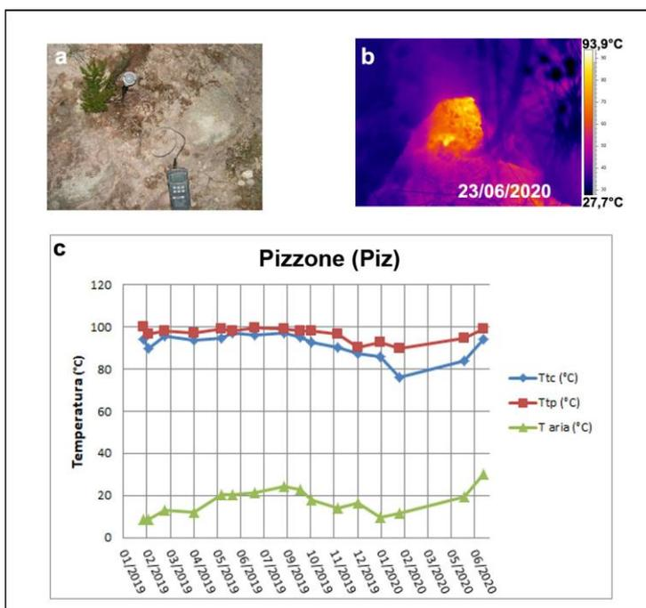
**Figura 3.6** – Fumarola in località Pizzone a Ischia. Immagini nel visibile (a) e termica (b) riprese dal punto stazione Piz di Figura 3.1h. Valori massimi di temperatura con termocamera (Ttc) e valori di temperatura dalla termocoppia (Ttp), confrontati con la temperatura dell'aria misurata nel momento del rilievo termico da gennaio 2019 a giugno 2020 (c).
