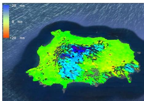
**Figura 2.3.1 - a)** mappa di deformazione, coppia 03.01.2020-25.06.2020, orbita ascendente, track 177,  $B.L=17.9m$ .
