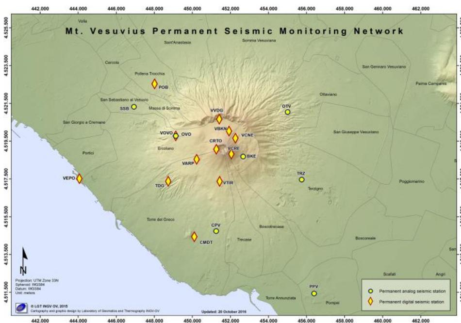
Figura 1.1.1 – Rete Sismica Permanente del Vesuvio.
