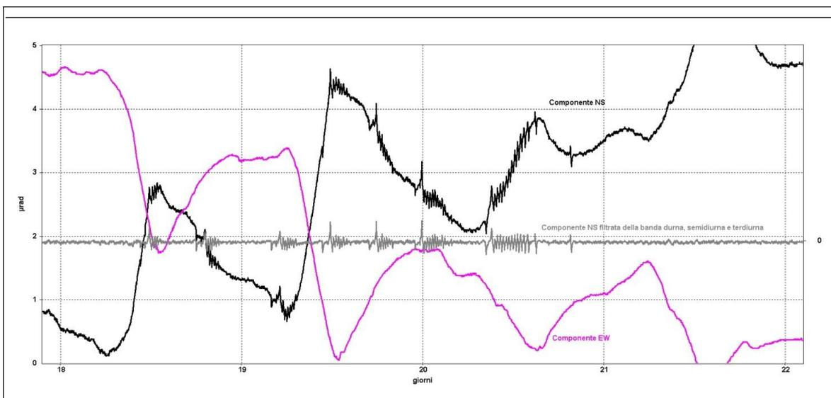
**Figura 2.2.6** - Ultimi 4 giorni del periodo (13÷20 aprile) in cui è comparsa una modulazione (in banda 20-100 minuti ma con una prevalenza a 20 minuti) sulla componente NS del tiltmetro installato in località Pisciarelli. In grigio è sovrapposto il segnale ottenuto dopo il filtraggio della banda diurna, semidiurna e terdiurna.
