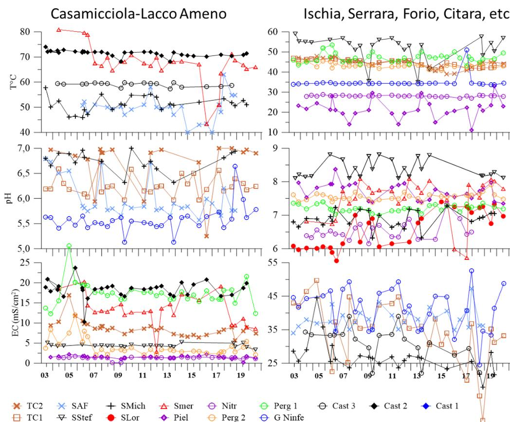
**Figura 4.1.2** – Variazioni temporali di temperatura (°C), conducibilità (mS/cm<sup>2</sup>) e pH delle acque campionate.
