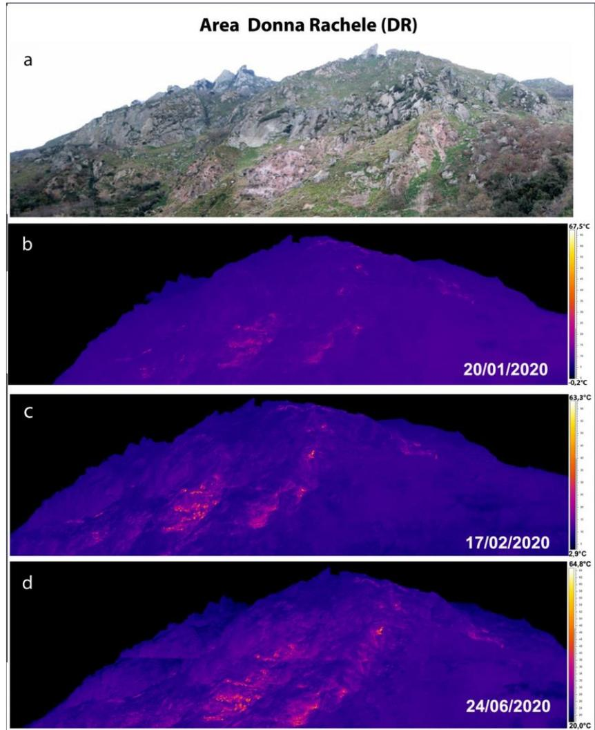
**Figura 3.2** - Versante in località Donna Rachele a Ischia. Fotocomposizioni di immagini nel visibile (a) e delle corrispondenti immagini termiche relative al 20/01/2020 (b), 17/02/2020 (c) e 24/06/2020 (d) dal punto stazione DRp di figura 3.1.
