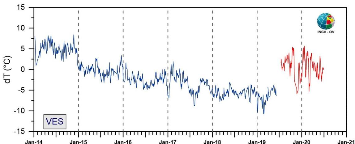
**Figura 3.1.3** - Stazione Vesuvio: Serie temporali dei valori di temperatura massima giornaliera rilevata nelle immagini IR destagionalizzate mediante applicazione dell' algoritmo BR [medie settimanali termocamera 320x240 (blu); medie settimanali termocamera 640x480 (rosso)].
