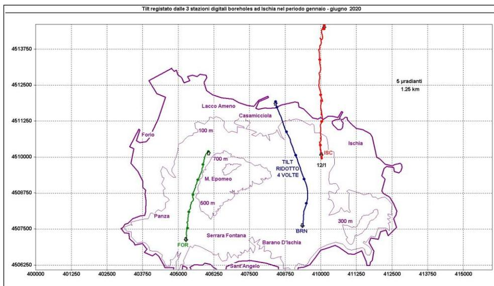
**Figura 2.2.2** – Pattern tiltmetrico osservato ad Ischia. Il lato di ogni maglia del reticolo equivale a 5  $\mu$ radianti o 1.25 km ed i pallini in colore sovrapposti sui vettori tilt indicano l’inizio di 30 giorni. Allo scopo di facilitare il confronto tra le varie stazioni, all’odografo relativo alla stazione BRN è stata applicata una scala di riduzione di 1:4.
