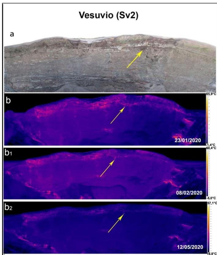
**Figura 3.2.2** – Settore orientale del cratere del Vesuvio. Fotocomposizioni di immagini nel visibile (a) e delle corrispondenti immagini termiche relative al 23/01/2020 (b), 08/02/2020 (b1) e 12/05/2020 (b2) dal punto stazione SV2a di Fig. 3.2.1.
