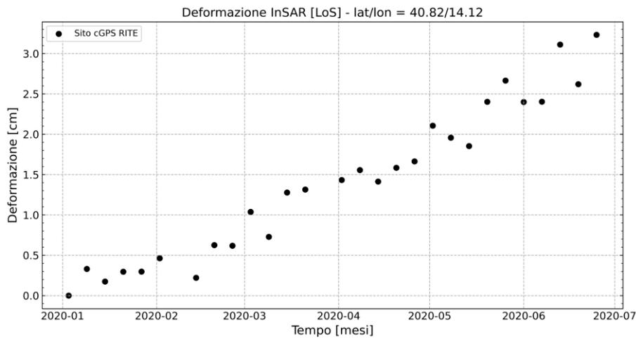
**Figura 2.4.2** - Serie temporale (03.01.2020-25.06.2020) estratta in corrispondenza della stazione GPS in continuo RITE nell'area di massima deformazione.
