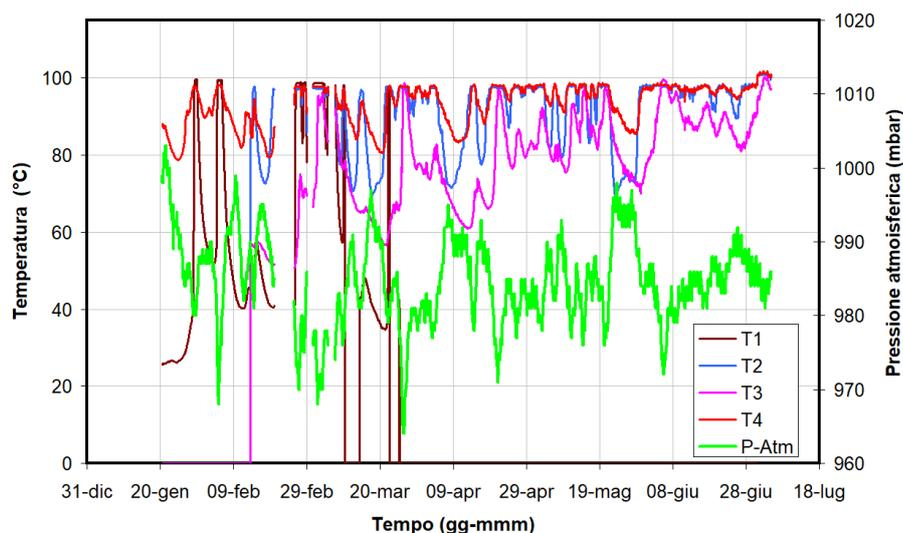
**Figura 4.2.3** - Temperature misurate in continuo dell'emissione fumarolica di Mt.Cito (Pizzone), e di altri punti limitrofi, la pressione atmosferica è stata inclusa tra i parametri monitorati.
