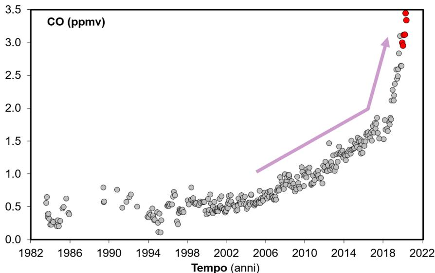
**Figura 4.9** - Variazioni della concentrazione di monossido di carbonio (CO) misurato alla fumarola BG a partire dal 1983. In rosso sono evidenziati i campioni relativi al primo semestre 2020. In generale alti contenuti di CO caratterizzano sistemi vulcanici ad elevata temperatura mentre fumarole alimentate da sistemi idrotermali mostrano concentrazioni più basse, in tali sistemi un aumento delle concentrazioni di CO può riflettere un incremento delle condizioni di temperatura e pressione.
