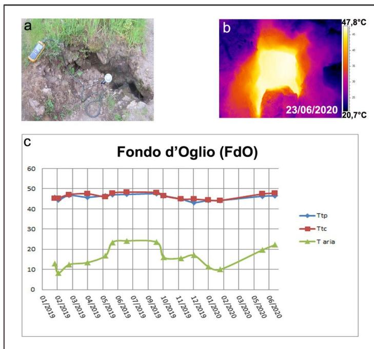
**Figura 3.9** – Fumarola in località Fondo d'Oglio a Ischia. Immagini nel visibile (a) e termica (b) riprese dal punto stazione FdO di Figura 3.1i. Valori massimi di temperatura con termocamera (Ttc) e valori di temperatura dalla termocoppia (Ttp), confrontati con la temperatura dell'aria misurata nel momento del rilievo termico da gennaio 2019 a giugno 2020 (c).
