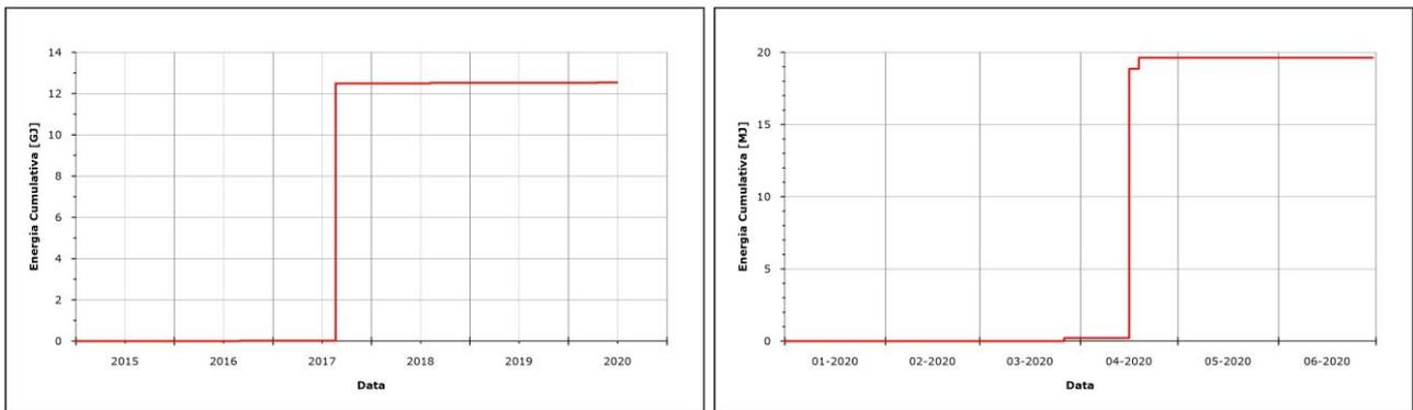
**Figura 1.1.7** – Andamento cumulativo dell’energia rilasciata dai terremoti registrati ad Ischia nel corso degli ultimi 5 anni (a sinistra) e del primo semestre 2020 (a destra) calcolato attraverso la relazione di Gutenberg-Richter  $\log E = 2.4 + 2.14M - 0.054M^2$ .
