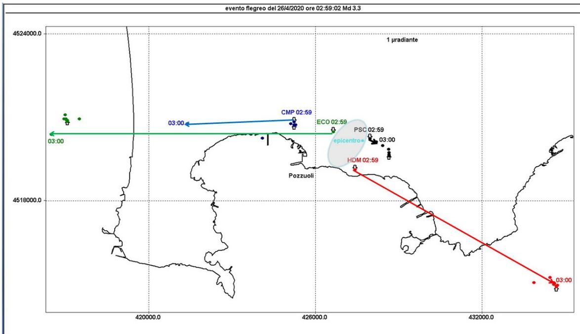
**Figura 2.2.5** - Pattern tiltmetrico osservato ai Campi Flegrei nei primi 9 minuti, compreso quello dell'evento. È riportato con un pallino colorato sia l'epicentro che la proiezione in superficie del centroide di deformazione ipotizzato.
