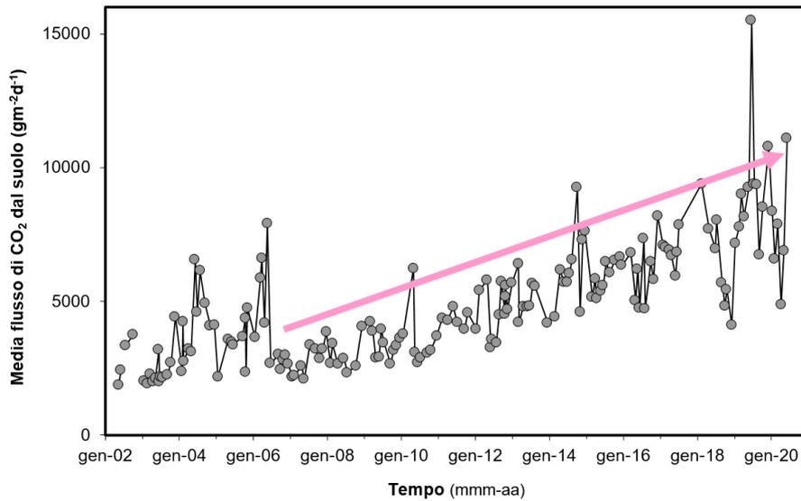
**Figura 4.2** - Cronogramma della media dei flussi di CO<sub>2</sub> dal suolo misurati su ~60 punti fissi nell'area craterica della Solfatara.
