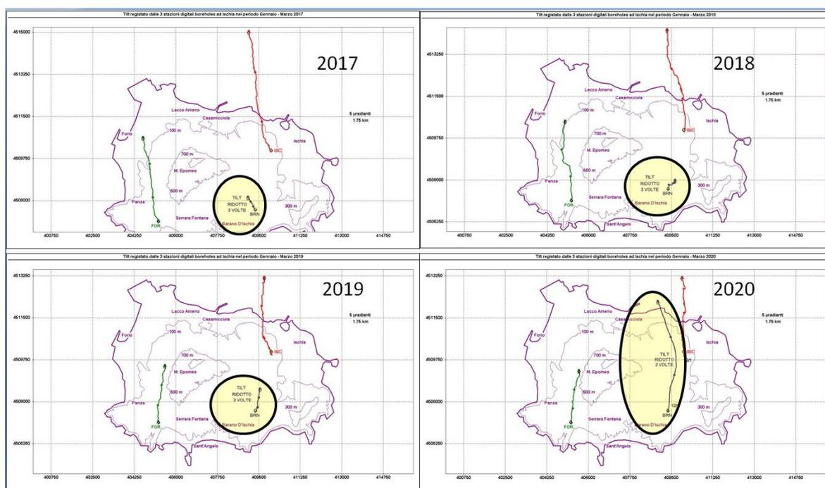
**Figura 2.2.4** - Pattern tiltmetrico osservato ad Ischia nei primi 3 mesi del 2017, 2018, 2019 e 2020. Per agevolare il confronto è stata applicata una scala di riduzione di 1:3 all’odografo relativo alla stazione BRN. È evidente come nel corso di quest’anno l’ampiezza dell’inclinazione del suolo sia triplicata in corrispondenza del sito-stazione.
