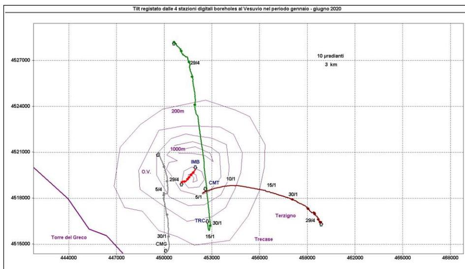
**Figura 2.2.2** - Pattern tiltmetrico osservato al Vesuvio. Per comodità di rappresentazione grafica e per una interpretazione più agevole, sono state selezionate in tale figura solo le 4 stazioni "borehole" con sensori ubicati a 25 m di profondità. Il lato di ogni maglia del reticolo equivale a 10  $\mu$ radianti o 3 km. I pallini in colore sovrapposti sui vettori tilt indicano l'inizio di ogni mese.
