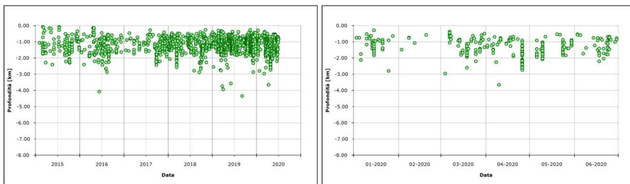
**Figura 1.1.5** – Variazione temporale della profondità ipocentrale dei terremoti nell’area flegrea localizzati nel corso degli ultimi 5 anni (a sinistra) e del primo semestre 2020 (a destra).
