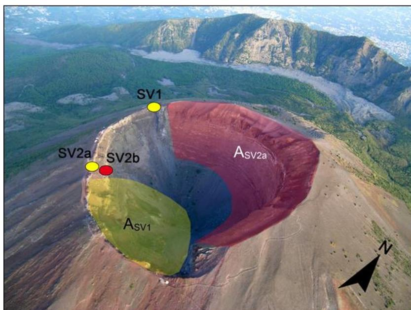
**Figura 3.2.1** – Cratere del Vesuvio. In giallo sono riportati i punti stazione dai quali vengono effettuati i rilievi con telecamera termica, in rosso quello nel quale vengono effettuati anche rilievi con termocoppia rigida. L'area in rosso (ASV2a) è quella ripresa dal punto stazione SV2a, mentre l'area in giallo (ASV1) è ripresa dal punto stazione SV1.
