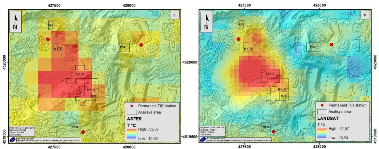
Figura 3.3.3 - Immagini termiche satellitari ASTER (a) e Landsat8 (b) rispettivamente del 22 e del 30 giugno 2020. I poligoni racchiudono le aree inquadrare dalla TIRNet.
