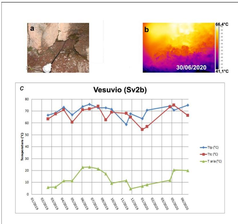
**Figura 3.2.4** – Immagini nel visibile (a) e termica (b) riprese al punto SV2b di Figura 3.2.1, di una fumarola ubicata sul settore occidentale del cratere del Vesuvio. Valori massimi di temperatura con termocamera (Ttc) e valori di temperatura dalla termocoppia (Ttp), confrontati con la temperatura dell’aria (c) misurata nel momento del rilievo termico da febbraio 2019 a giugno 2020 (c).
