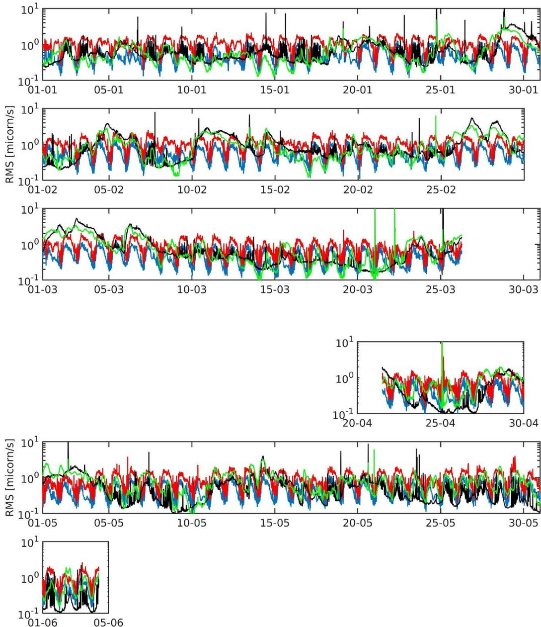
**Figura 1.2.2** - RMS calcolato per i segnali della stazione sismica PESH nei primi sei mesi del 2020 in quattro bande di frequenza: 0.05-0.5 Hz (nero), 0.5-2 Hz (verde), 2-4 Hz (rosso), 4-8 Hz (blu). La mancanza presente tra il giorno 01 aprile e 22 aprile è stata causata da un problema al sistema di alimentazione.
