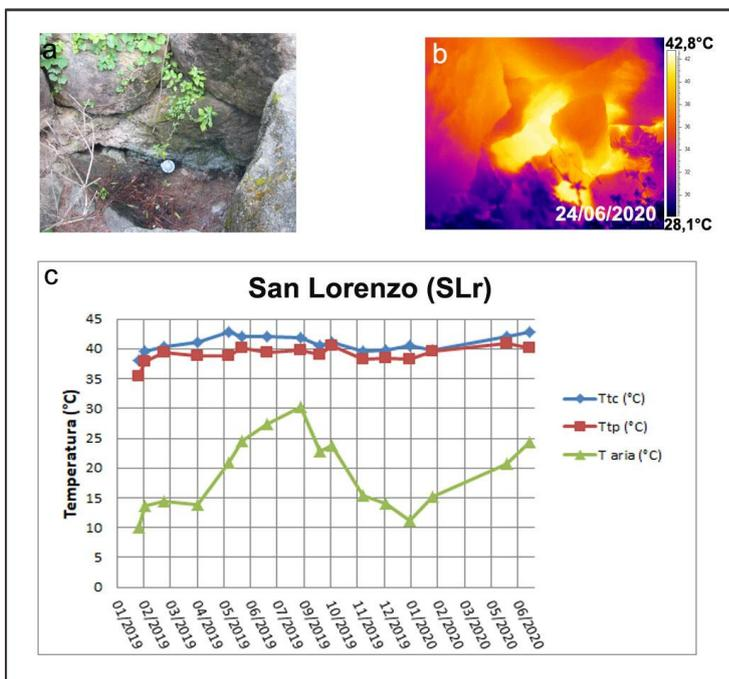
**Figura 3.7** – Fumarola in località S. Lorenzo a Ischia. Immagini nel visibile (a) e termica (b) riprese dal punto di stazione SLr di Figura 3.1b. Valori massimi di temperatura con termocamera (Ttc) e valori di temperatura dalla termocoppia (Ttp), confrontati con la temperatura dell’aria misurata nel momento del rilievo termico da gennaio 2019 a giugno 2020 (c).
