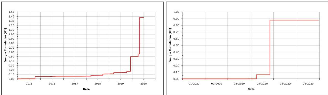
**Figura 1.1.7** – Andamento cumulativo dell’energia rilasciata dai terremoti nell’area flegrea nel corso degli ultimi 5 anni (a sinistra) e del primo semestre 2020 (a destra) calcolato attraverso la relazione di Gutenberg-Richter  $\log E = 2.4 + 2.14 M - 0.054 M^2$ .
