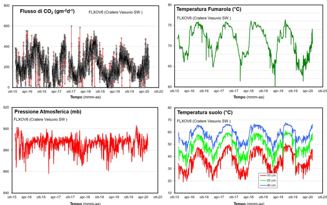
**Figura 4.1.5** - Serie temporali di alcuni parametri misurati dalla stazione geochimica FLXOV6 installata in area bordo cratere del Vesuvio (settore SW). I valori, eccetto il flusso di CO<sub>2</sub> dal suolo, sono riportati come medie giornaliere.
