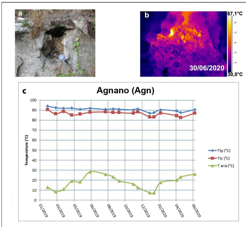
**Figura 3.2.5** - Fumarola all’interno dello stabilimento termale delle “Terme di Agnano”. Immagini nel visibile (a) e termica (b) riprese dal punto stazione Agn di figura 1.1c. Valori massimi di temperatura con termocamera (Ttc) e valori di temperatura dalla termocoppia (Ttp), confrontati con la temperatura dell’aria misurata nel momento del rilievo termico, da gennaio 2019 a giugno 2020 (c).
