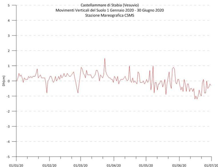
**Figura 2.3.3** - Movimenti verticali del suolo, nel periodo gennaio 2020 – giugno 2020, ottenuti dall'analisi dei dati acquisiti dal sensore digitale alla stazione mareografica di Castellammare di Stabia (CSMS). Le variazioni riportate rappresentano le medie giornaliere e sono riferite alla stazione Napoli Molo S.Vincenzo (NAMM).
