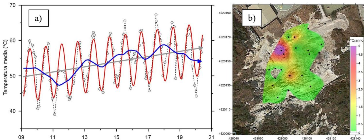
**Figura 4.5** - Cronogramma della media delle temperature del suolo (a 10 cm di profondità) misurate su 25 punti fissi nell'area di Pisciarelli dal 2009. Il trend destagionalizzato, mediante l'utilizzo dell'algoritmo di destagionalizzazione STL (Seasonal-Trend decomposition based on Loess, Cleveland et al., 1990), è riportato con la linea blu.
