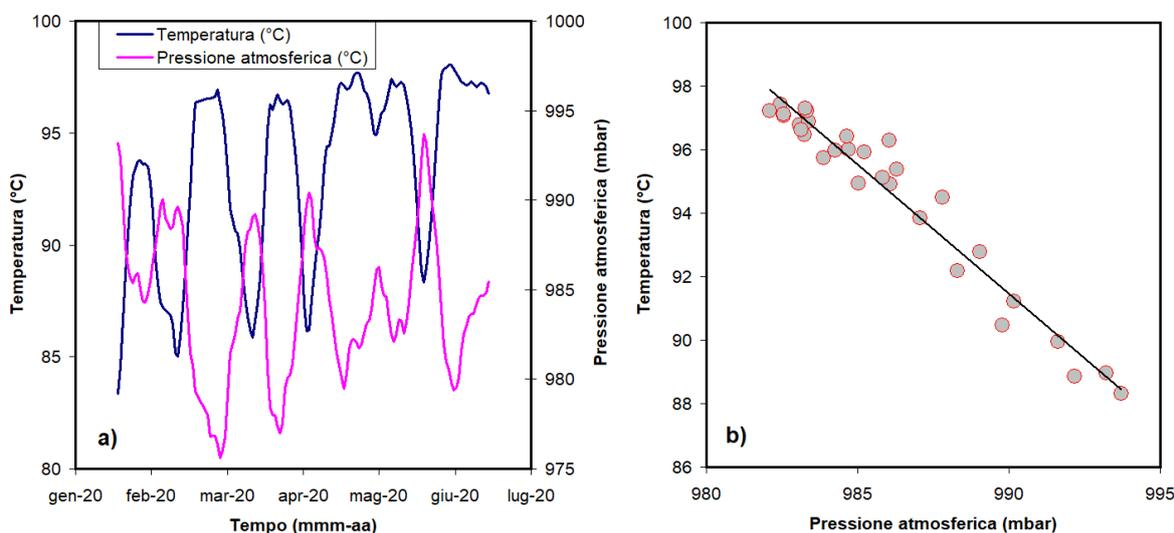
**Figura 4.2.4** - a) Media mobile dei valori di temperatura dell'emissione fumarolica di Mt.Cito (Pizzone) e della pressione atmosferica misurati in continuo. La buona correlazione inversa dei due parametri è osservabile nel diagramma di destra (b).
