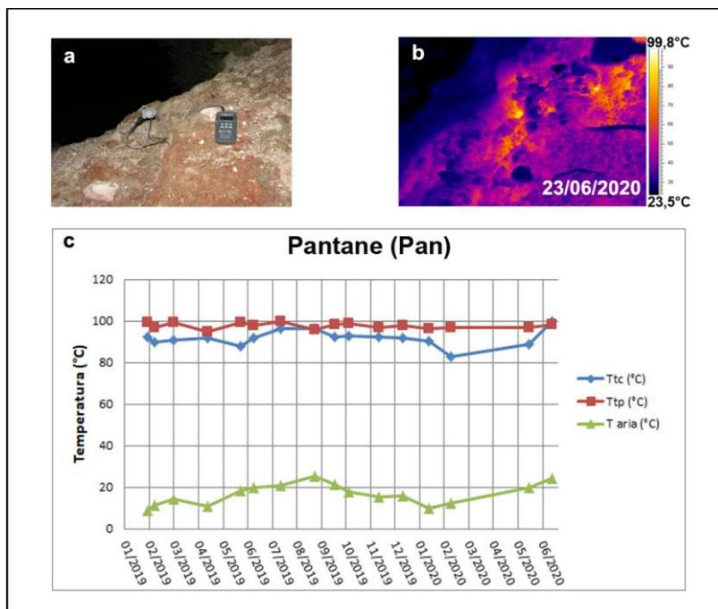
**Figura 3.5** – Fumarola in località Pantane a Ischia. Immagini nel visibile (a) e termica (b) riprese dal punto di misura Pan di Figura 3.1a. Valori massimi di temperatura con termocamera (Ttc) e valori di temperatura alla termocoppia (Ttp), confrontati con la temperatura dell'aria misurata nel momento del rilievo termico da gennaio 2019 a giugno 2020 (c).
