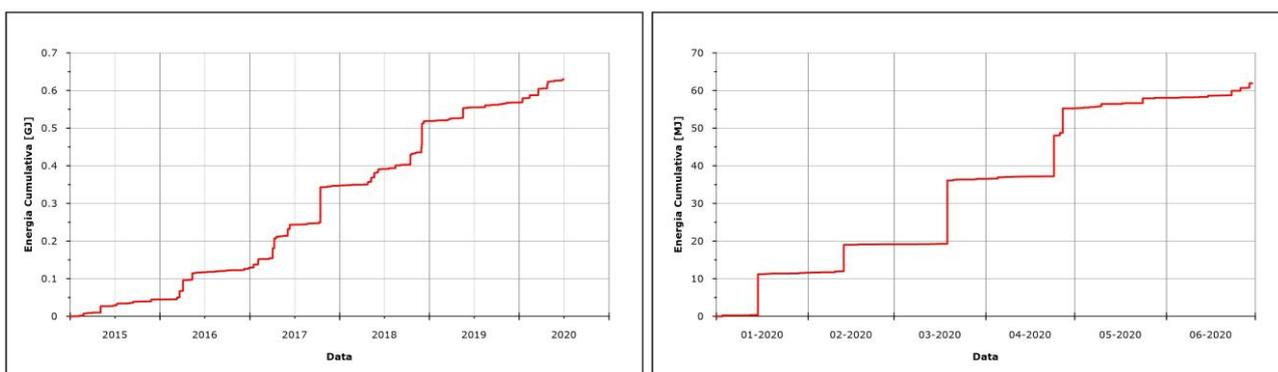
**Figura 1.1.8** – Andamento cumulativo dell'energia rilasciata dai terremoti vesuviani nel corso degli ultimi 5 anni (a sinistra) e del secondo semestre 2019 (a destra) calcolato attraverso la relazione di Gutenberg-Richter  $\log E = 2.4 + 2.14 M - 0.054 M^2$ .
