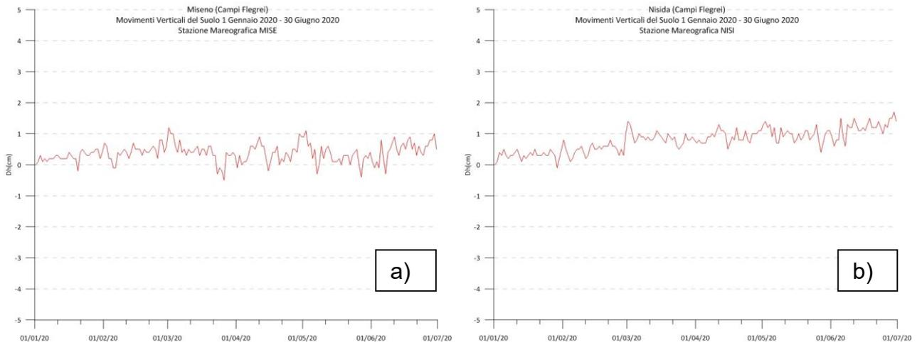
**Figura 2.3.4** - Movimenti verticali del suolo, nel periodo gennaio 2020 – giugno 2020, ottenuti dall’analisi dei dati acquisiti da (a) sensore digitale alla stazione mareografica di Miseno (MISE) (bordo occidentale della caldera flegrea) e (b) alla stazione mareografica di Nisida (NISI) (bordo orientale della caldera flegrea). Le variazioni riportate rappresentano le medie giornaliere e sono riferite alla stazione di Napoli molo S.Vincenzo (NAMM).
