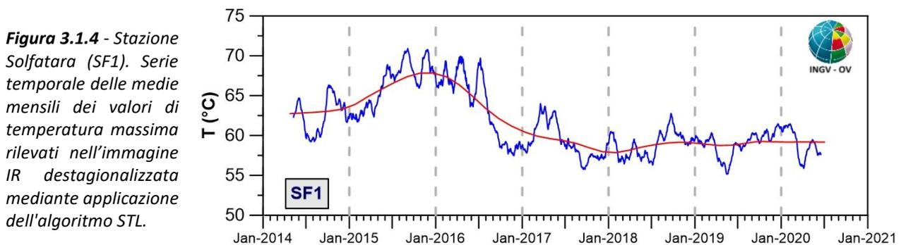
**Figura 3.1.4** - Stazione Solfatara (SF1). Serie temporale delle medie mensili dei valori di temperatura massima rilevati nell'immagine IR destagionalizzata mediante applicazione dell'algoritmo STL.
