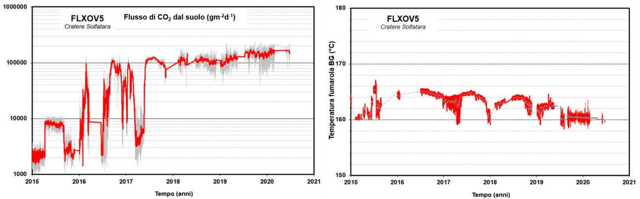
**Figura 4.6** - Valori del flusso di CO<sub>2</sub> dal suolo misurati dalla stazione FLXOV5 installata nel cratere della Solfatara (area fumarole) (la linea rossa si riferisce alle medie giornaliere). I flussi di CO<sub>2</sub> dal suolo mostrano, in generale, un significativo incremento a partire da febbraio 2016.
