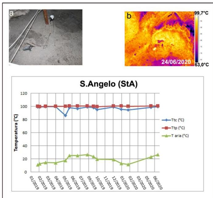
**Figura 3.3** – Fumarola in località S. Angelo a Ischia. Immagini nel visibile (a) e termica (b) riprese dal punto stazione StA di Figura 4.1e. Valori massimi di temperatura con termocamera (Ttc) e valori di temperatura dalla termocoppia (Ttp), confrontati con la temperatura dell’aria misurata nel momento del rilievo termico da gennaio 2019 a giugno 2020 (c).
